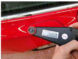
Lackstärke Seitenwand hinten rechts
