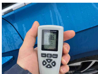
Lackstärke Seitenwand hinten links
