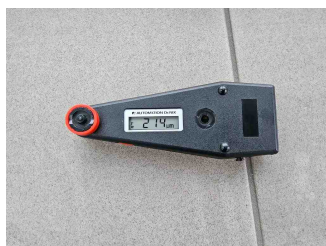
Lackstärke Seitenwand hinten rechts
