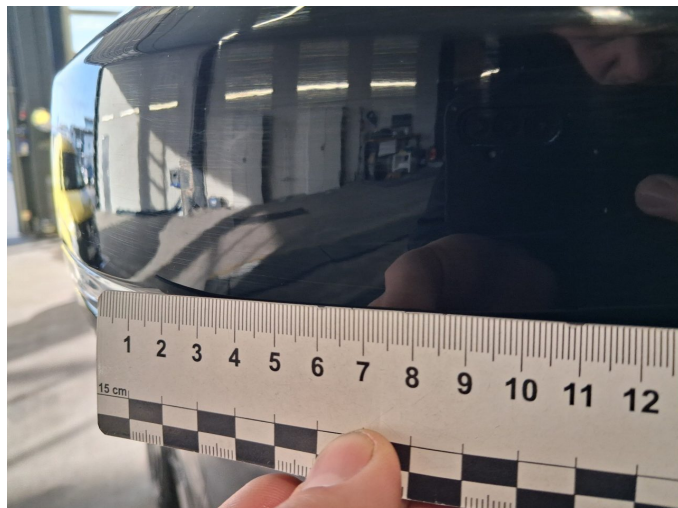
Beschädigung 7: Außenspiegel rechts: Abdeckkappe - verkratzt / verschürft - lackieren
