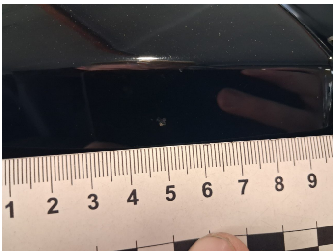
Beschädigung 7: Außenspiegel rechts: Abdeckkappe - verkratzt / verschürft - lackieren
