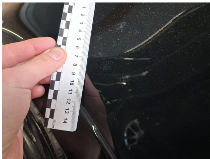
Beschädigung 3: Kotflügel links: Kotflügel links - Kratzer - auslegen / polieren
