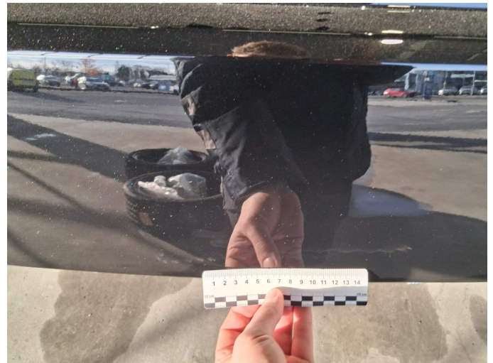
Beschädigung 12: Heckklappe/-tür: Heckklappe - Lackmangel - lackieren
