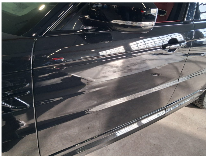
Beschädigung 10: Tür vorn links: Tür - Delle / Lackschaden - instandsetzen und lackieren
