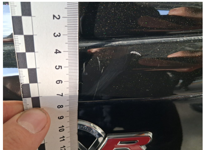
Beschädigung 12: Heckklappe/-tür: Heckklappe - Lackmangel - lackieren
