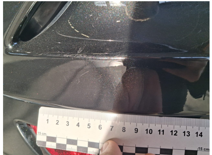
Beschädigung 11: Stossfänger hinten: Stossfänger hinten - verkratzt / verschürft - lackieren
