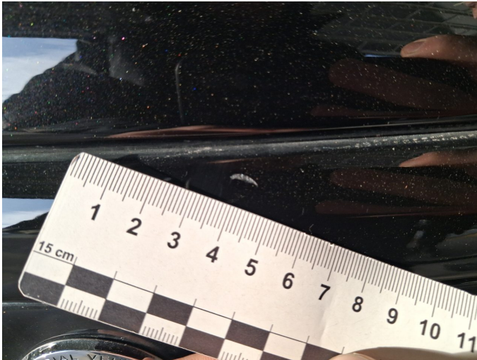
Beschädigung 12: Heckklappe/-tür: Heckklappe - Lackmangel - lackieren
