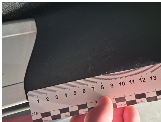
Beschädigung 8: Verkleidungen/Abdeckungen: Einstieg vorn links - verkratzt / verschürft - erneuern
