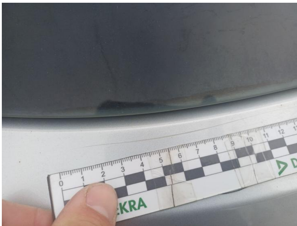
Fot. 85. Pokrywa - zarysowanie 1
