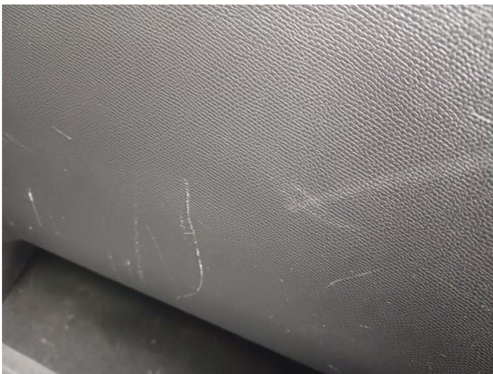
Fot. 92. Pokrywa schowka deski rozdź - zarysowanie 1
