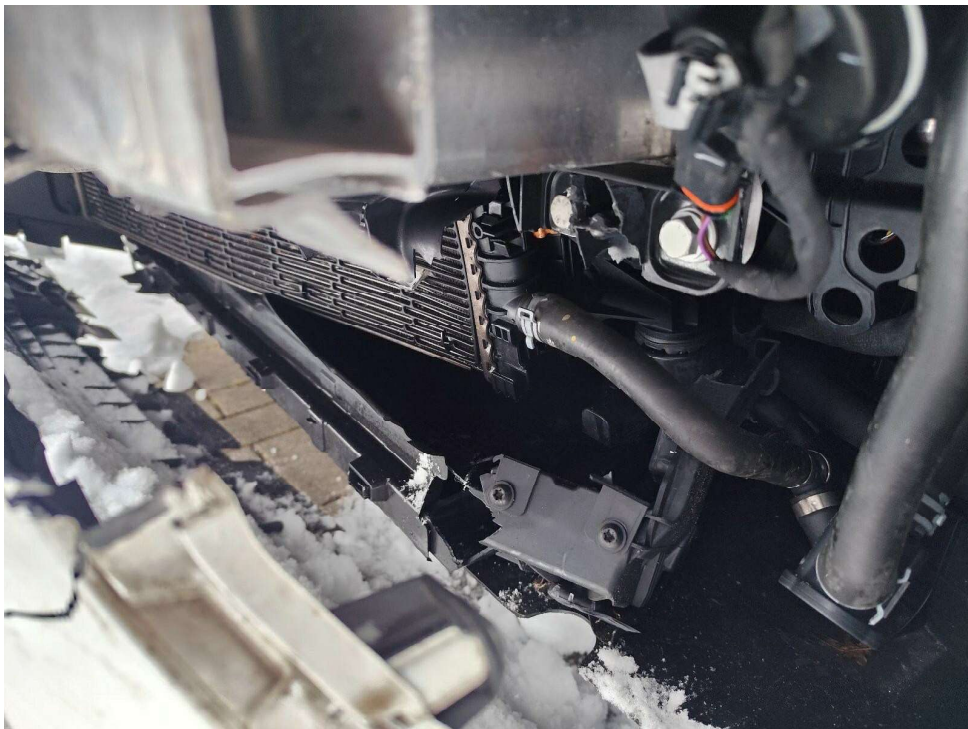
Bild 10 : Kühlerpaket und Halterungen zerbrochen
