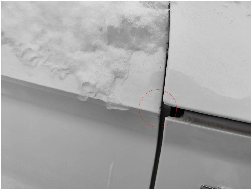
Bild 13 : Türlackierung rechts duch Motorhaube beschädigt
