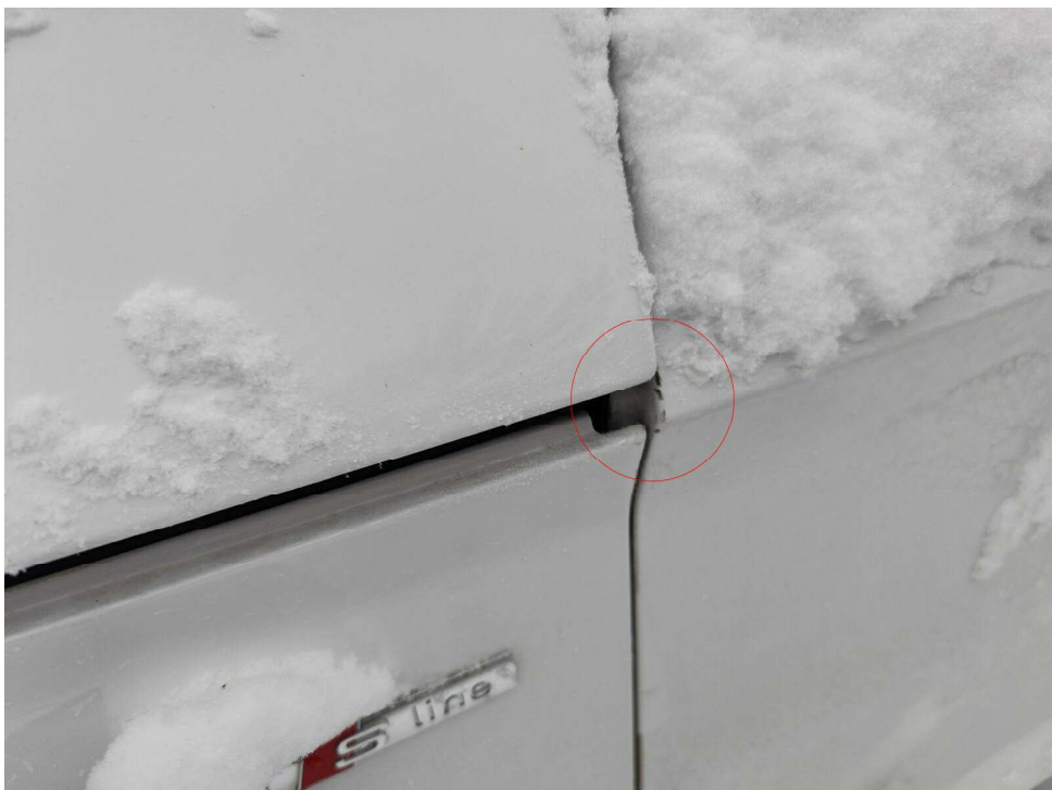
Bild 12 : Türlackierung links durch Motorhaube beschädigt
