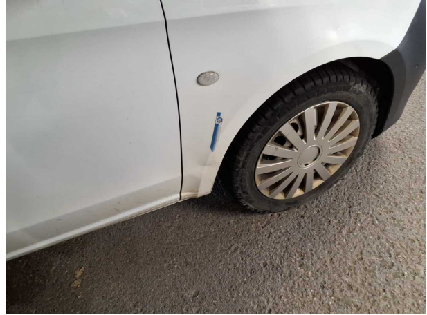
Beschädigung #9: Kotflügel rechts: Kotflügel rechts - Delle(n) - Instandsetzen
