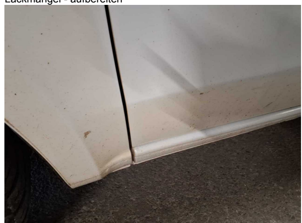
Beschädigung #19: Karosserie: Karosserie (Flugrost) - Lackmangel - aufbereiten
