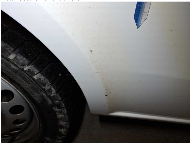
Beschädigung #13: Seitenwand rechts: Seitenwand - Steinschla... instandsetzen und lackieren
