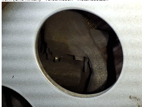
Beschädigung #2: Bremsanlage: Bremsscheiben und Beläge vorn (Und hinten) - verschlissen - instandsetzen
