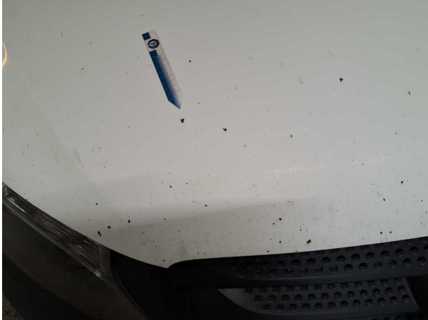
Beschädigung #6: Motorhaube: Motorhaube - Steinschlag - instandsetzen und lackieren
