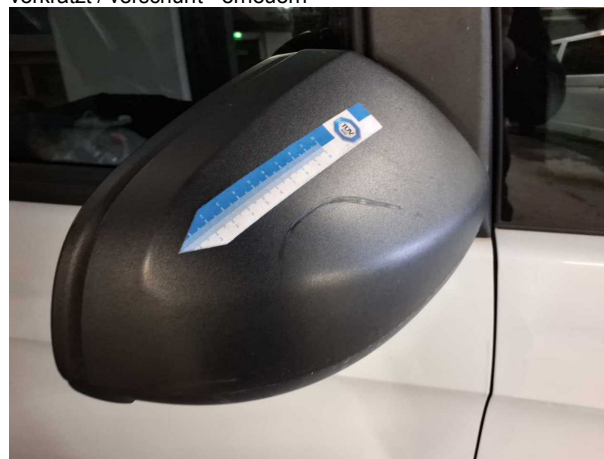
Beschädigung #11: Außenspiegel rechts: Abdeckkappe - verkratzt / verschürft - erneuern
