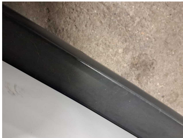
Beschädigung #16: Stossfänger hinten: Stossfänger hinten - Kratzer
