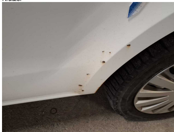
Beschädigung #17: Seitenwand links: Seitenwand - Korrosion - instandsetzen und lackieren
