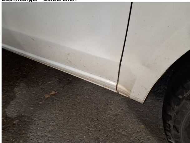
Beschädigung #19: Karosserie: Karosserie (Flugrost) - Lackmangel - aufbereiten
