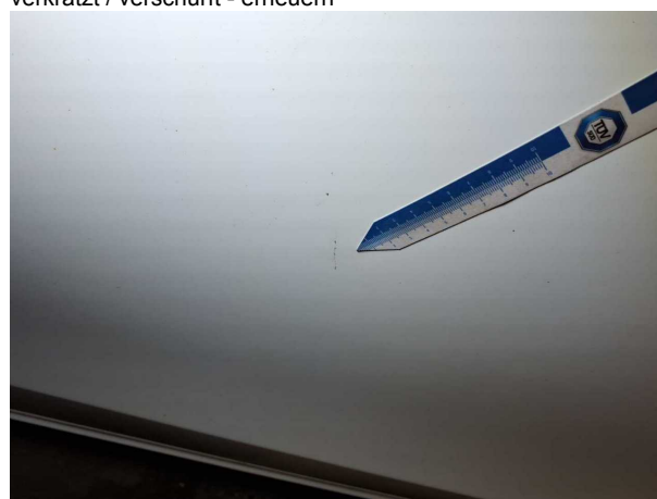
Beschädigung #12: Schiebetür rechts: Schiebetür - Kratzer - instandsetzen und lackieren
