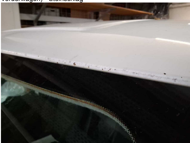
Beschädigung #8: Fahrzeugdach: Dach (Dachkante vorne) - Steinschlag - Smart Repair
