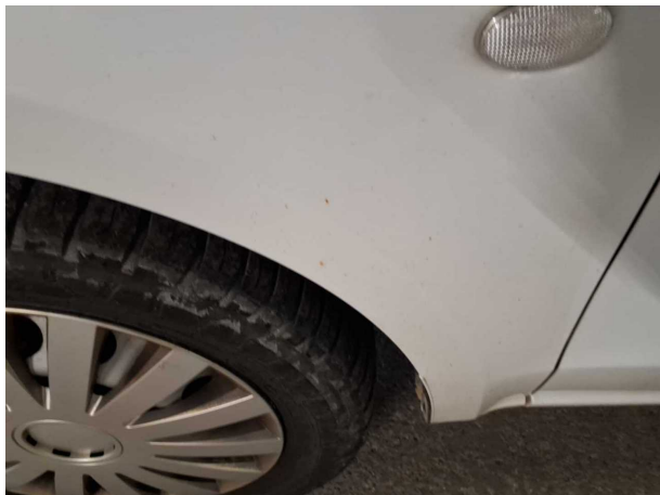
Beschädigung #19: Karosserie: Karosserie (Flugrost) - Lackmangel - aufbereiten
