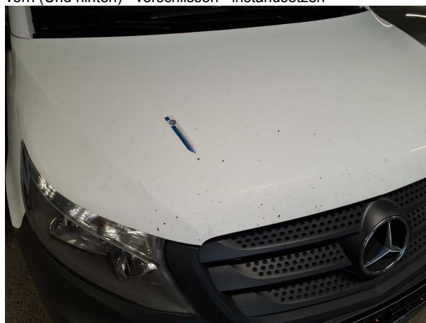
Beschädigung #6: Motorhaube: Motorhaube - Steinschlag - instandsetzen und lackieren
