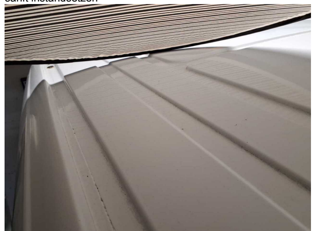
Beschädigung #22: Karosserie: Karosserie - Hagelschaden - sanft instandsetzen
