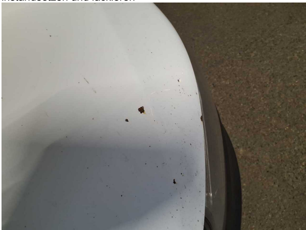
Beschädigung #6: Motorhaube: Motorhaube - Steinschlag - instandsetzen und lackieren
