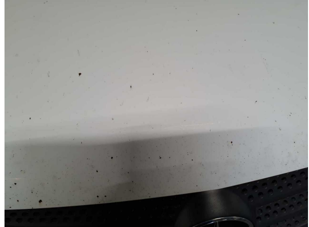
Beschädigung #6: Motorhaube: Motorhaube - Steinschlag - instandsetzen und lackieren
