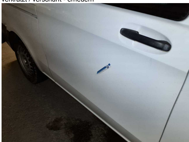
Beschädigung #12: Schiebetür rechts: Schiebetür - Kratzer - instandsetzen und lackieren
