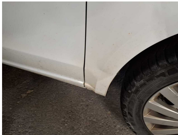
Beschädigung #19: Karosserie: Karosserie (Flugrost) - Lackmangel - aufbereiten
