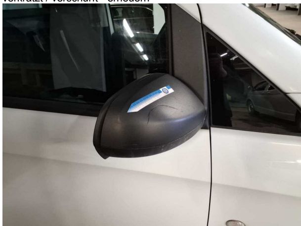
Beschädigung #11: Außenspiegel rechts: Abdeckkappe - verkratzt / verschürft - erneuern
