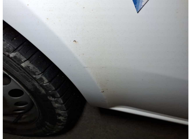
Beschädigung #13: Seitenwand rechts: Seitenwand - Steinschlag - instandsetzen und lackieren
