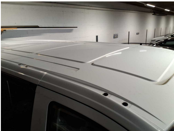
Beschädigung #22: Karosserie: Karosserie - Hagelschaden - sa... instandsetzen
