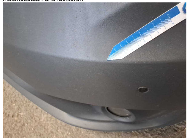
Beschädigung #7: Stossfänger vorn: Stossfänger vorn (Kompletter Vorderwagen) - Steinschlag
