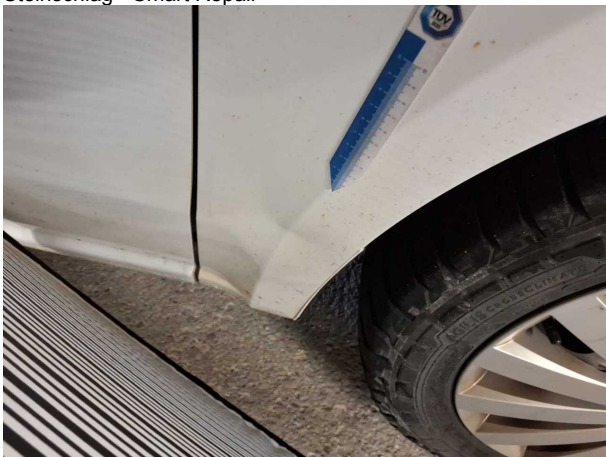
Beschädigung #9: Kotflügel rechts: Kotflügel rechts - Delle(n) - Instandsetzen
