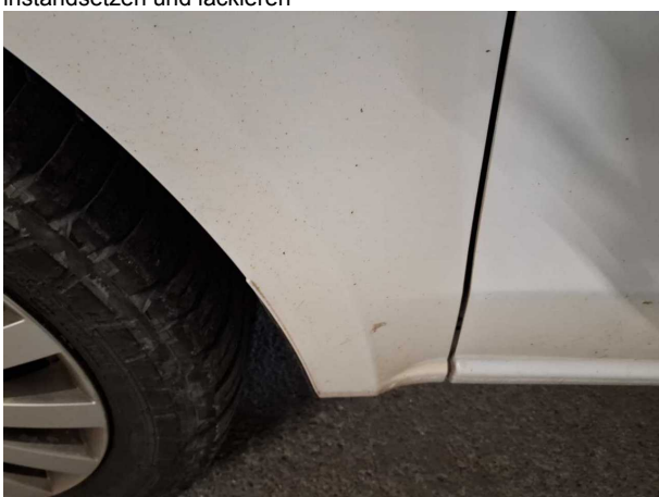
Beschädigung #19: Karosserie: Karosserie (Flugrost) - Lackmangel - aufbereiten
