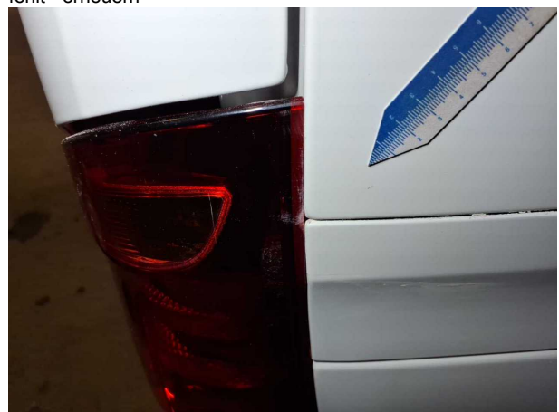
Beschädigung #15: Heckleuchte: Heckleuchte rechts - verkratzt / verschürft - erneuern
