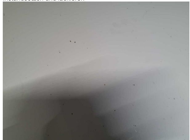
Beschädigung #6: Motorhaube: Motorhaube - Steinschlag - instandsetzen und lackieren
