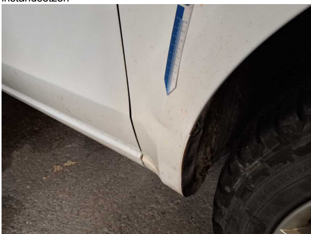
Beschädigung #9: Kotflügel rechts: Kotflügel rechts - Delle(n) - Instandsetzen
