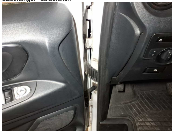
Beschädigung #20: Tür vorn links: Fangband / Feststeller - Geräusch - instandsetzen
