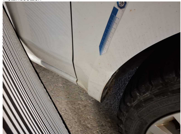
Beschädigung #9: Kotflügel rechts: Kotflügel rechts - Delle(n) - Instandsetzen
