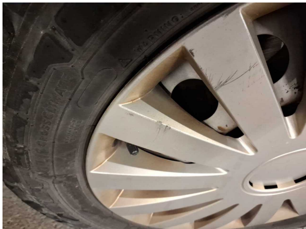
Beschädigung #10: Rad/Reifen: Radblende vorn rechts - verkratzt / verschürft - erneuern
