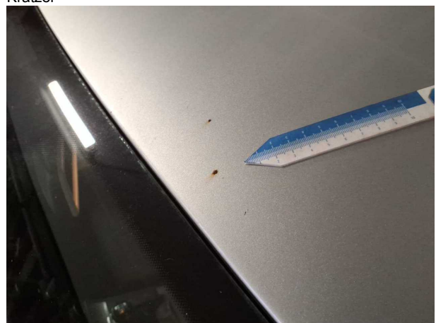
Beschädigung #28: Fahrzeugdach: Dach (Dachkante vorne) - Steinschlag - Smart Repair
