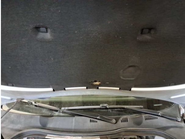
Beschädigung #1: Motorhaube: Dämmmatte - Marderschaden - erneuern
