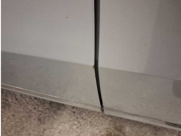
Beschädigung #26: Tür vorn links: Türkante - Kratzer
