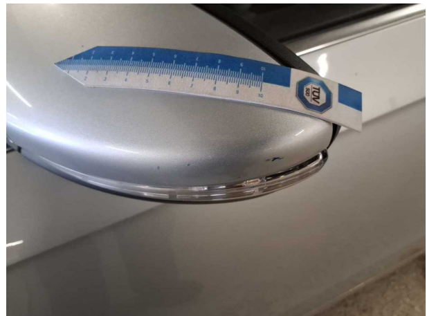
Beschädigung #27: Außenspiegel links: Abdeckkappe - Kratzer
