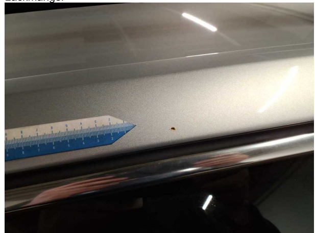
Beschädigung #30: Fahrzeugdach: Dachholm links - Korrosi... - Smart Repair
