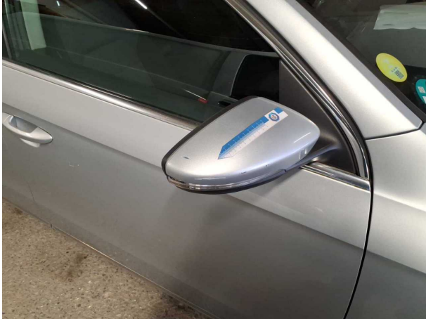
Beschädigung #11: Außenspiegel rechts: Abdeckkappe - verkratzt / verschürft - instandsetzen und lackieren
