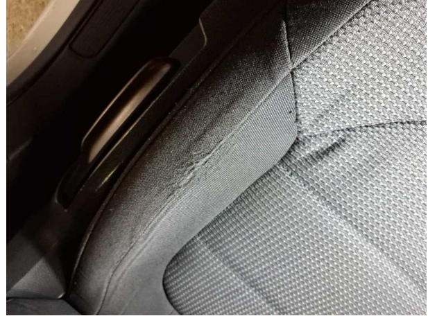
Beschädigung #22: Sitz vorn: Sitzbezug links (und Polster) - verschlissen - instandsetzen
