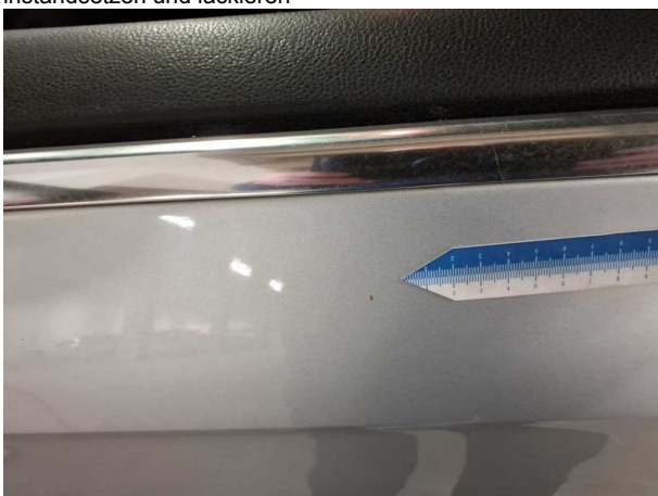
Beschädigung #25: Tür vorn links: Tür - Steinschlag
