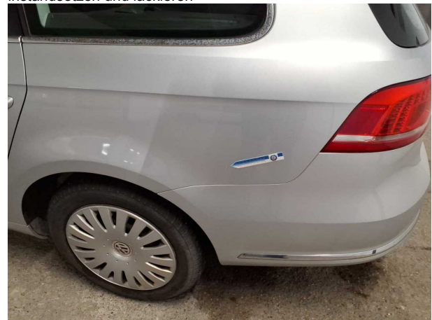
Beschädigung #20: Seitenwand links: Seitenwand - Kratzer - instandsetzen und lackieren
