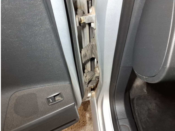
Beschädigung #16: Tür vorn links: Scharnier Satz (Schwergängig, alle 4x Türen) - Funktion / Zulässigkeit - instandsetzen
