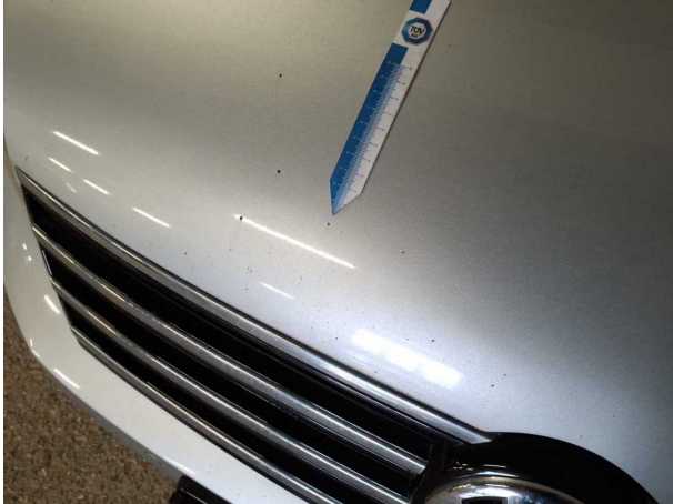
Beschädigung #7: Motorhaube: Motorhaube - Korrosion - instandsetzen und lackieren
