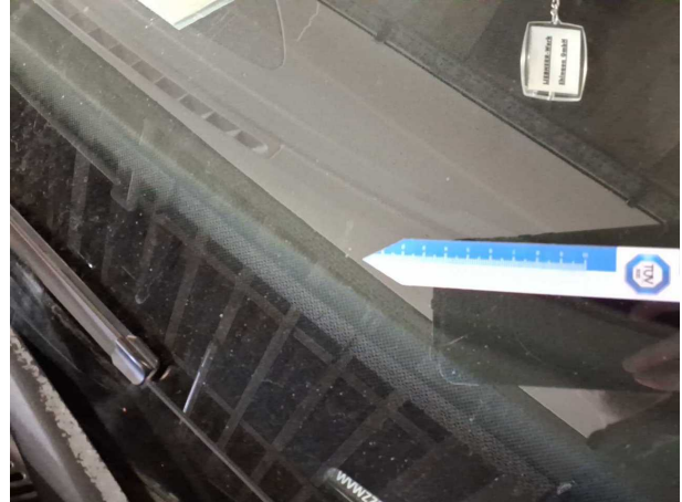
Beschädigung #10: Verglasung: Frontscheibe (Kompletter Vorderwagen) - Steinschlag
