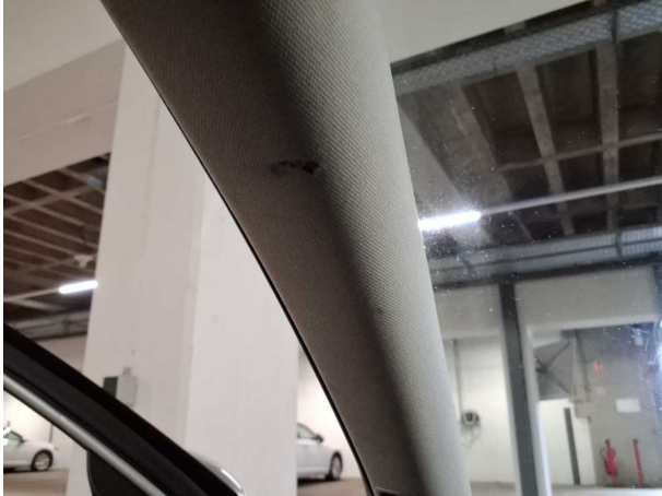
Beschädigung #4: Karosserie: A-Säule links - Brandloch - Smart Repair
