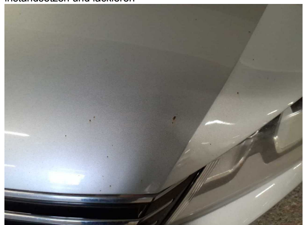
Beschädigung #7: Motorhaube: Motorhaube - Korrosion - instandsetzen und lackieren
