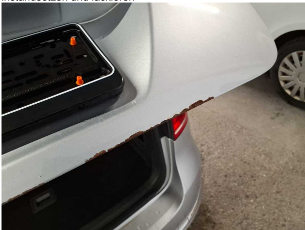
Beschädigung #19: Heckklappe/-tür: Heckklappe - Korrosion - instandsetzen und lackieren
