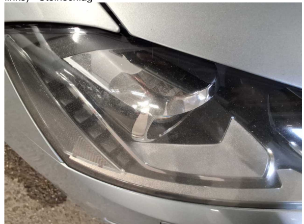
Beschädigung #9: Scheinwerfer: Scheinwerfer rechts (und links) - Steinschlag
