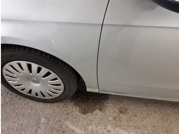
Beschädigung #29: Karosserie: Karosserie (Flugrost) - Lackmangel
