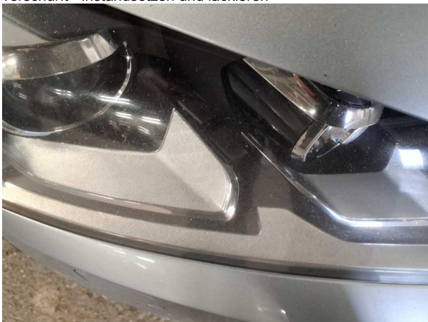
Beschädigung #9: Scheinwerfer: Scheinwerfer rechts (und links) - Steinschlag
