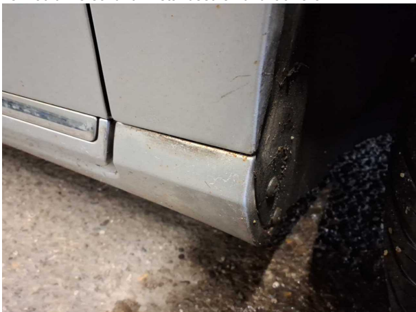
Beschädigung #12: Schweller rechts: Schweller (Und evtl Kotflügel) - Korrosion - instandsetzen und lackieren
