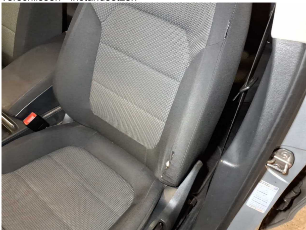
Beschädigung #23: Sitz vorn: Lehnenbezug links - gebrochen / gerissen - erneuern
