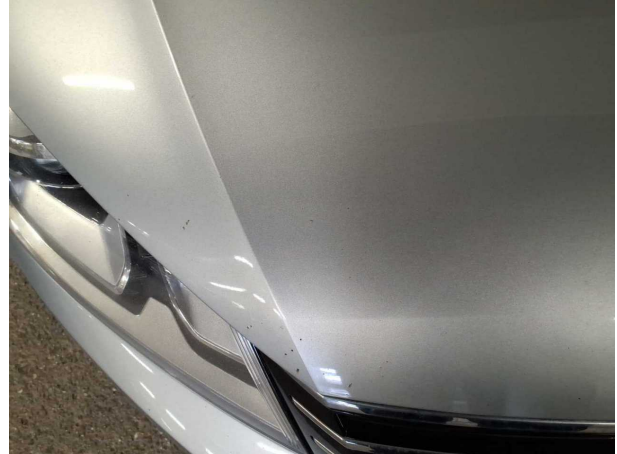
Beschädigung #7: Motorhaube: Motorhaube - Korrosion - instandsetzen und lackieren
