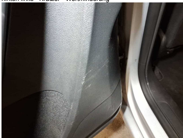
Beschädigung #21: Verkleidungen/Abdeckungen: Türverkleidung hinten links - Kratzer - Wertminderung
