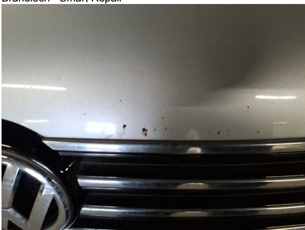
Beschädigung #7: Motorhaube: Motorhaube - Korrosion - instandsetzen und lackieren
