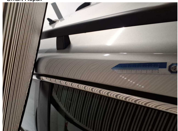
Beschädigung #31: Fahrzeugdach: Dachholm rechts - Delle... - sanft instandsetzen
