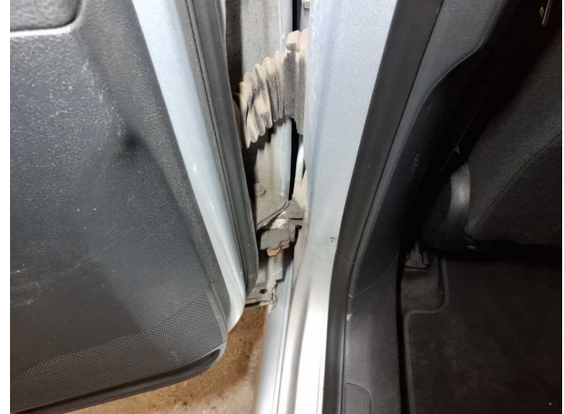
Beschädigung #16: Tür vorn links: Scharnier Satz (Schwergängig, alle 4x Türen) - Funktion / Zulässigkeit -
