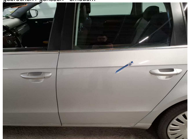
Beschädigung #24: Tür hinten links: Tür - Delle / Lackschad... - instandsetzen und lackieren
