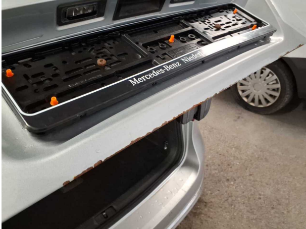
Beschädigung #19: Heckklappe/-tür: Heckklappe - Korrosion - instandsetzen und lackieren
