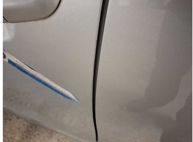
Beschädigung #26: Tür vorn links: Türkante - Kratzer
