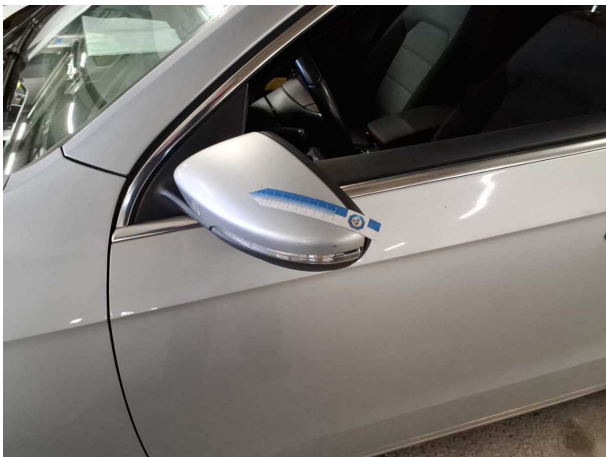
Beschädigung #27: Außenspiegel links: Abdeckkappe - Kratzer
