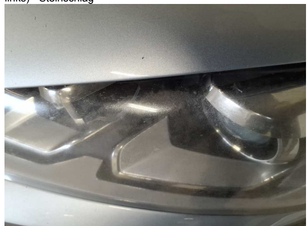
Beschädigung #9: Scheinwerfer: Scheinwerfer rechts (und links) - Steinschlag
