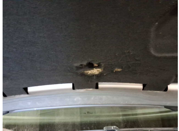
Beschädigung #1: Motorhaube: Dämmmatte - Marderschaden - erneuern
