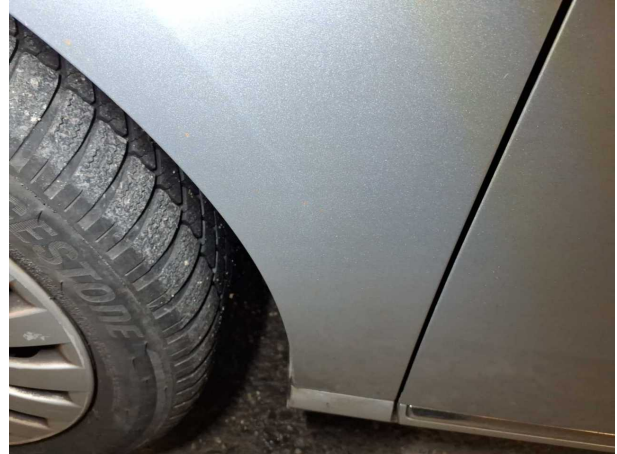
Beschädigung #29: Karosserie: Karosserie (Flugrost) - Lackmangel
