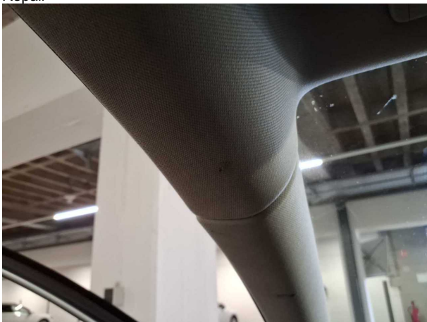
Beschädigung #5: Verkleidungen/Abdeckungen: Dachhimmel - Brandloch - Smart Repair
