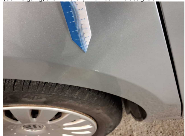
Beschädigung #17: Seitenwand rechts: Seitenwand - Kratzer
