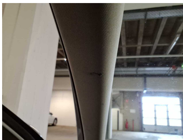
Beschädigung #4: Karosserie: A-Säule links - Brandloch - Smart Repair
