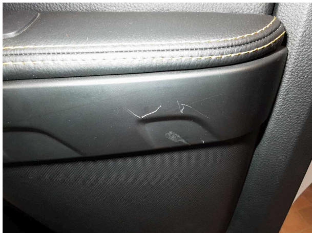
Beschädigung #3: Verkleidungen/Abdeckungen: Türverkleidung hinten rechts - Kratzer - Wertminderung
