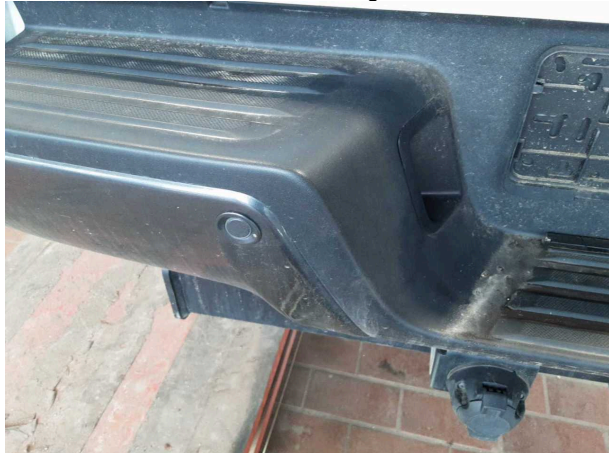
Beschädigung #4: Stossfänger hinten: Stossfänger hinten (unlackiert) - Kratzer - Wertminderung
