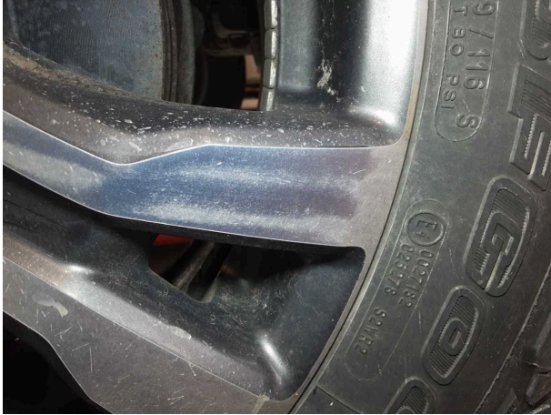
Beschädigung #5: Rad/Reifen: Leichtmetallfelge hinten links - Kratzer - Wertminderung
