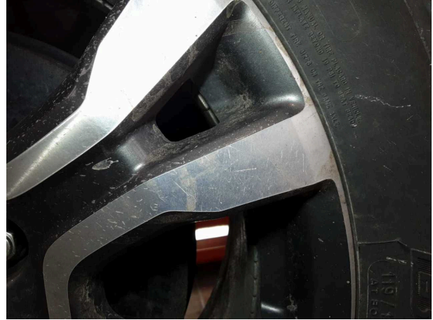
Beschädigung #5: Rad/Reifen: Leichtmetallfelge hinten links - Kratzer - Wertminderung
