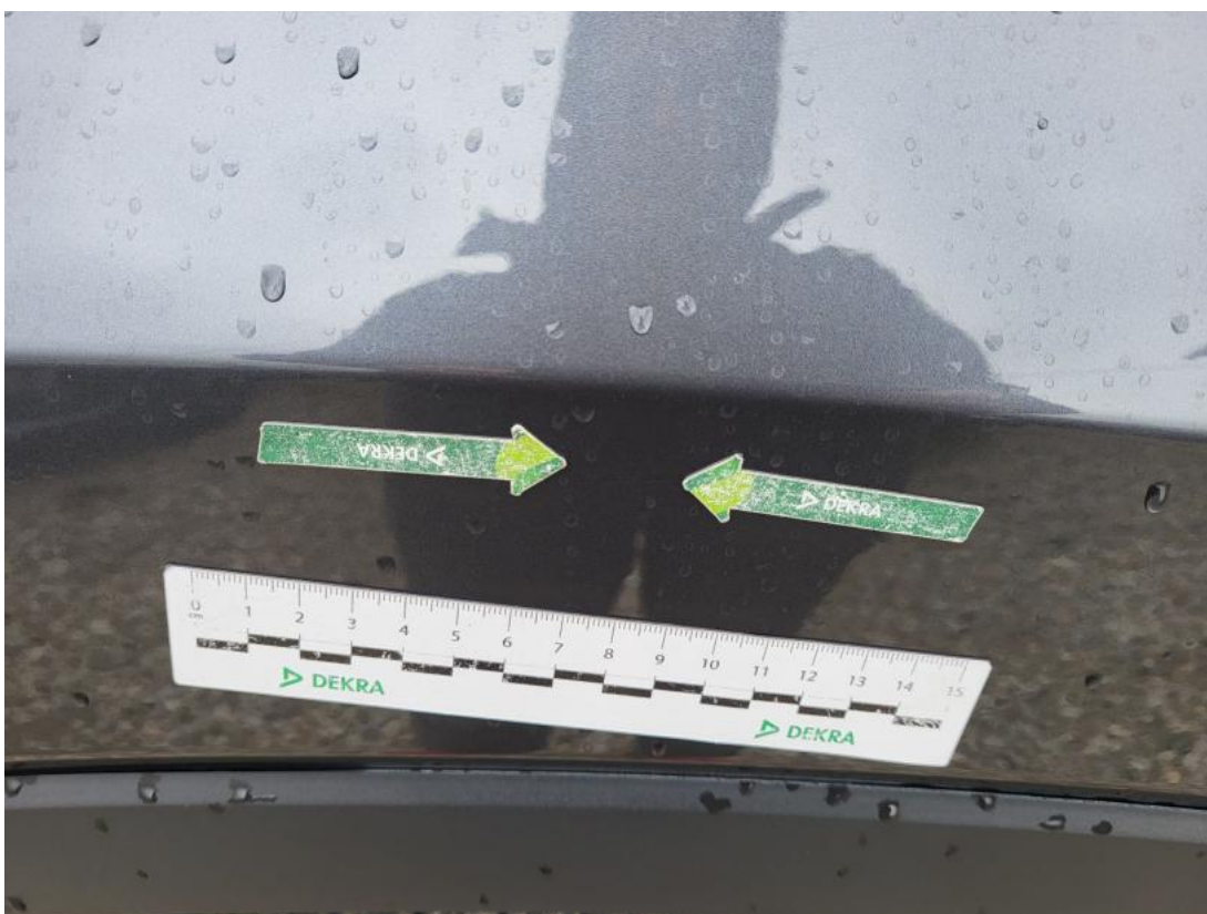
Fot. 36 Błotnik tylny P / Ściana boczna P - Wgniecenie/odkształcenie 1
