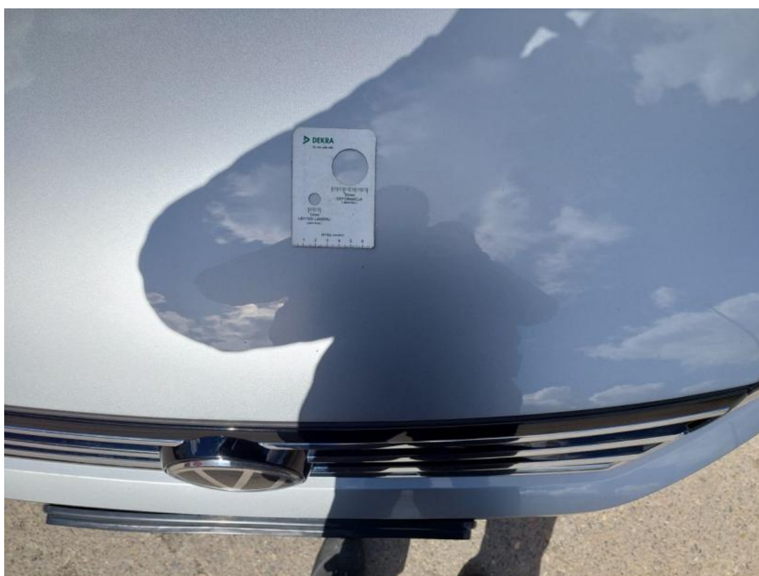
Fot. 36 Pokrywa komory silnika - Rysa/odprysk 1
