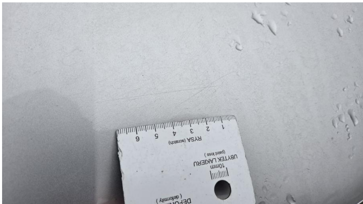
Fot. 32 Pokrywa komory silnika - Rysa/odprysk 1
