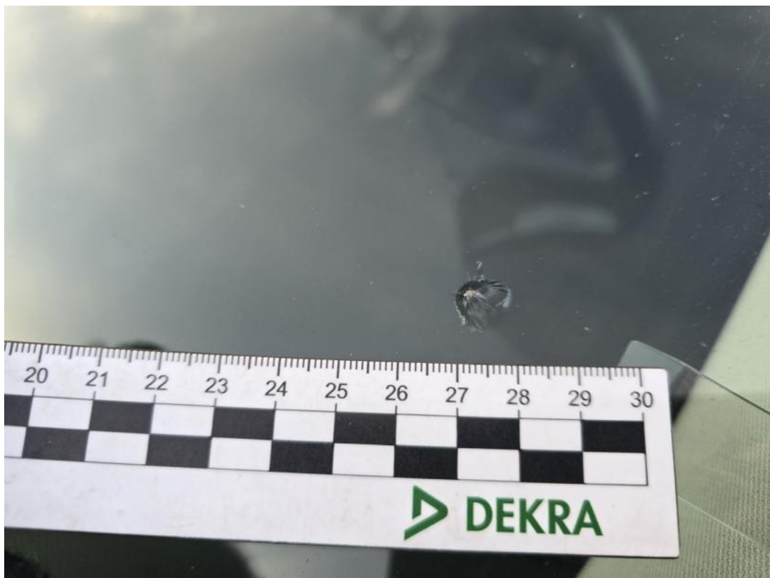
Fot. 36 Szyba czołowa - Pęknięcie/rozerwanie 1
