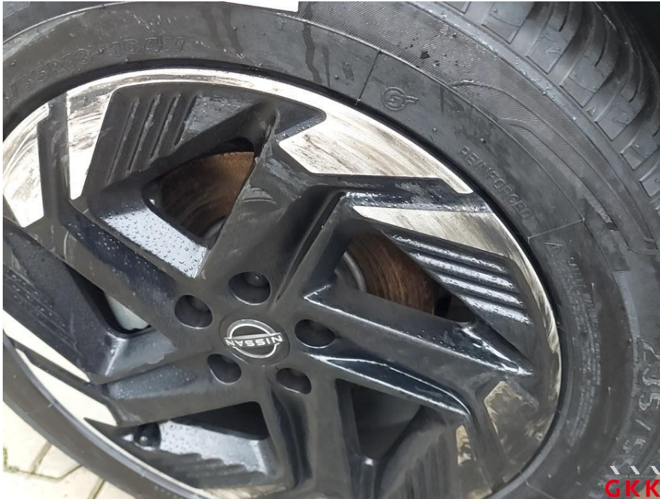
Bild 51 Rad/Reifen vorn links verkratzt/angestoßen
