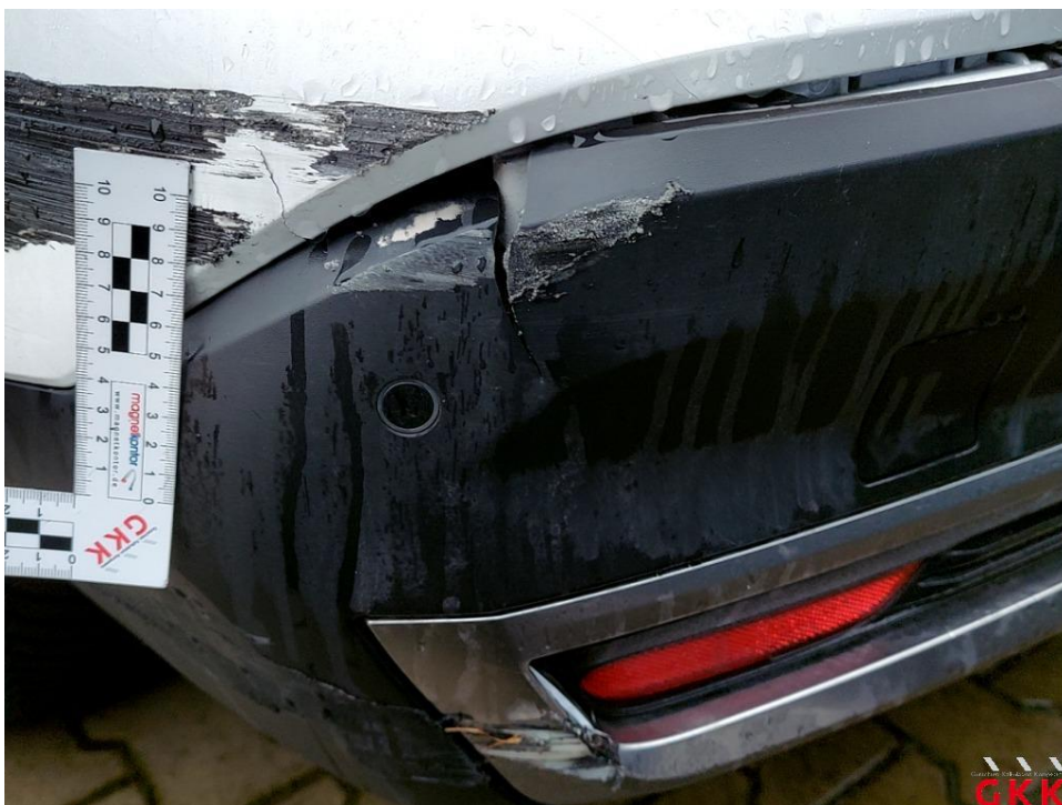
Bild 40 Stoßfänger hinten unterhalb gebrochen
