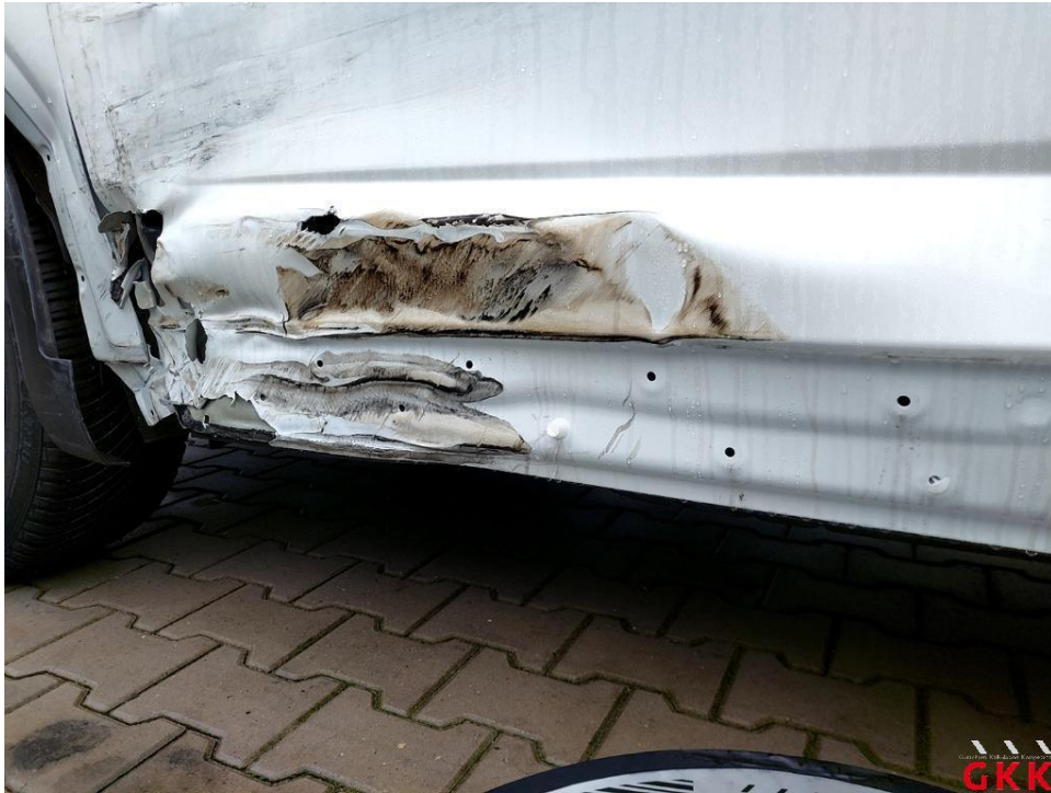
Bild 53 Schweller/Unterholm links eingedellt und verkratzt
