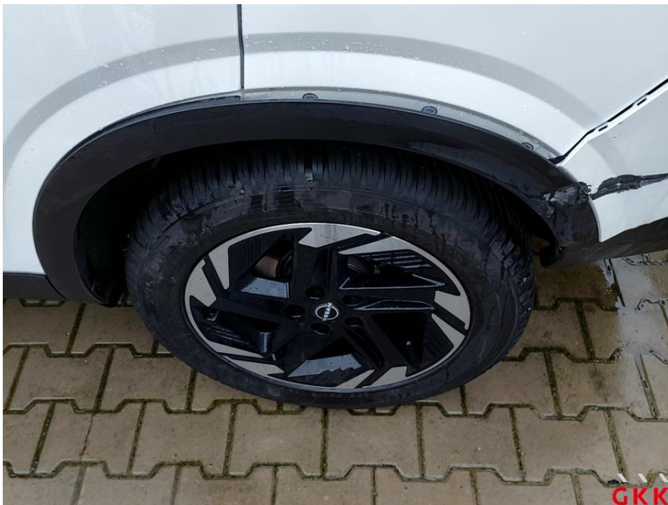
Bild 42 Radlaufverkleidung hinten links verformt und verkratzt
