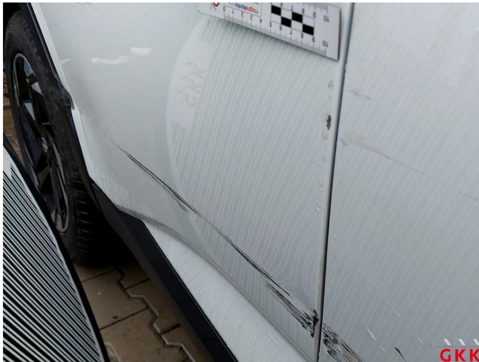
Bild 25 Tür hinten rechts verformt und verkratzt
