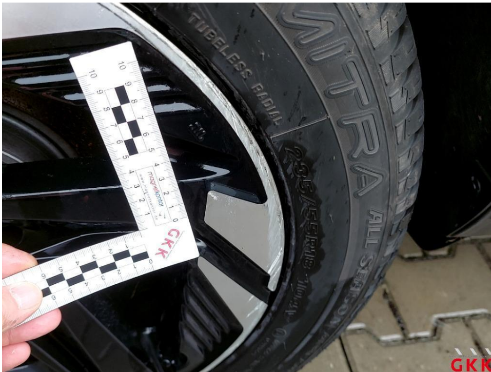
Bild 33 Rad/Reifen hinten rechts verkratzt/angestoßen
