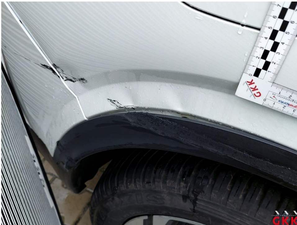
Bild 27 Seitenwand hinten rechts verformt und verkratzt
