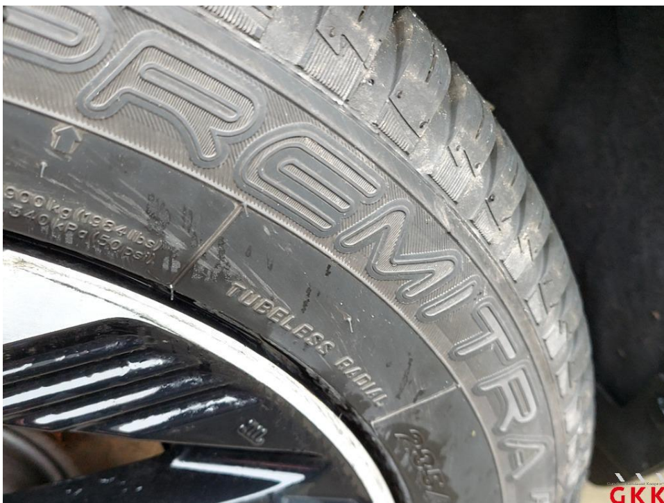
Bild 34 Rad/Reifen hinten rechts verkratzt/angestoßen
