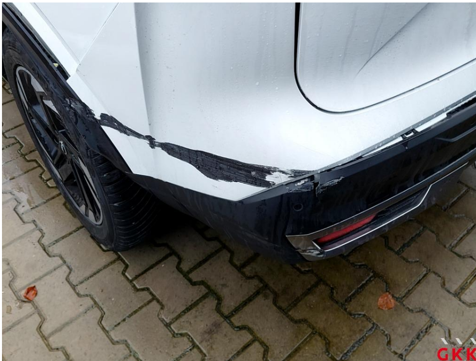
Bild 39 Stoßfänger hinten gestaucht und verkratzt
