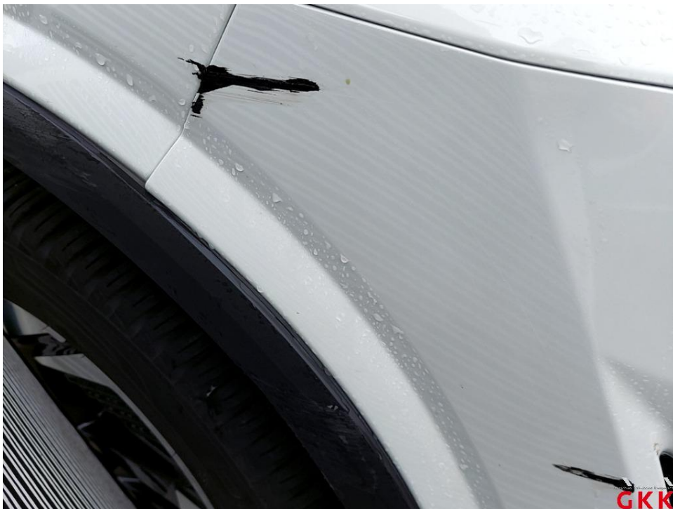
Bild 14 Stoßfänger vorn gestaucht und verkratzt
