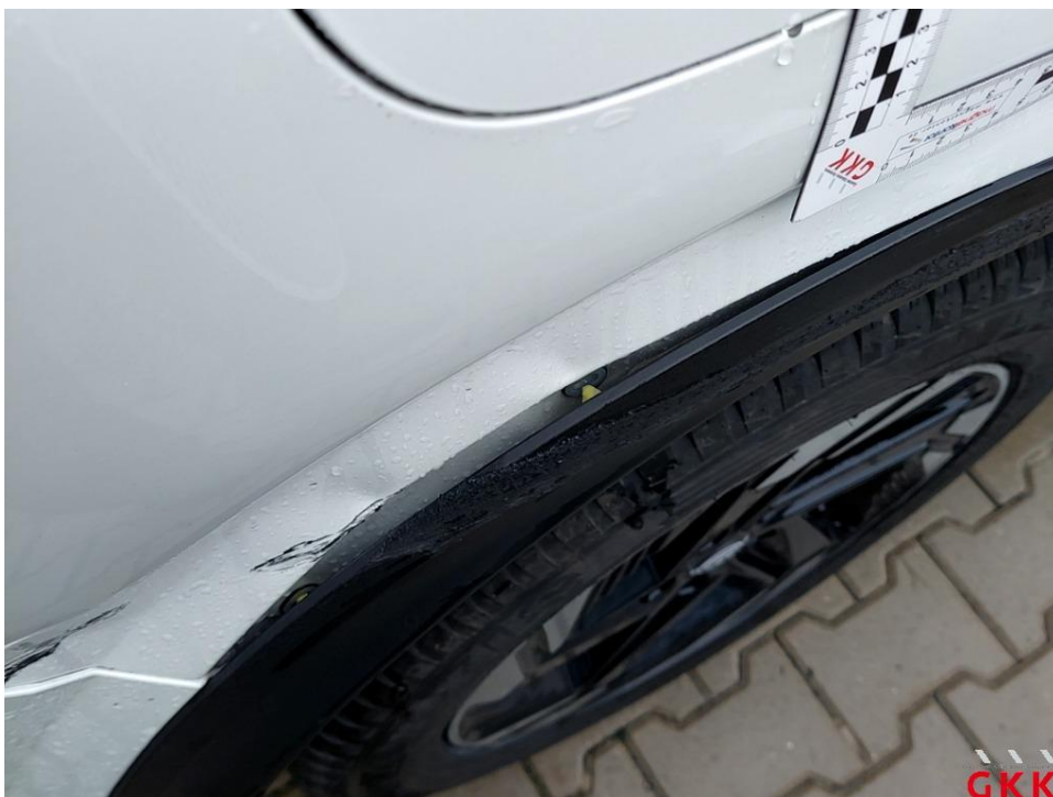
Bild 28 Seitenwand hinten rechts verformt und verkratzt
