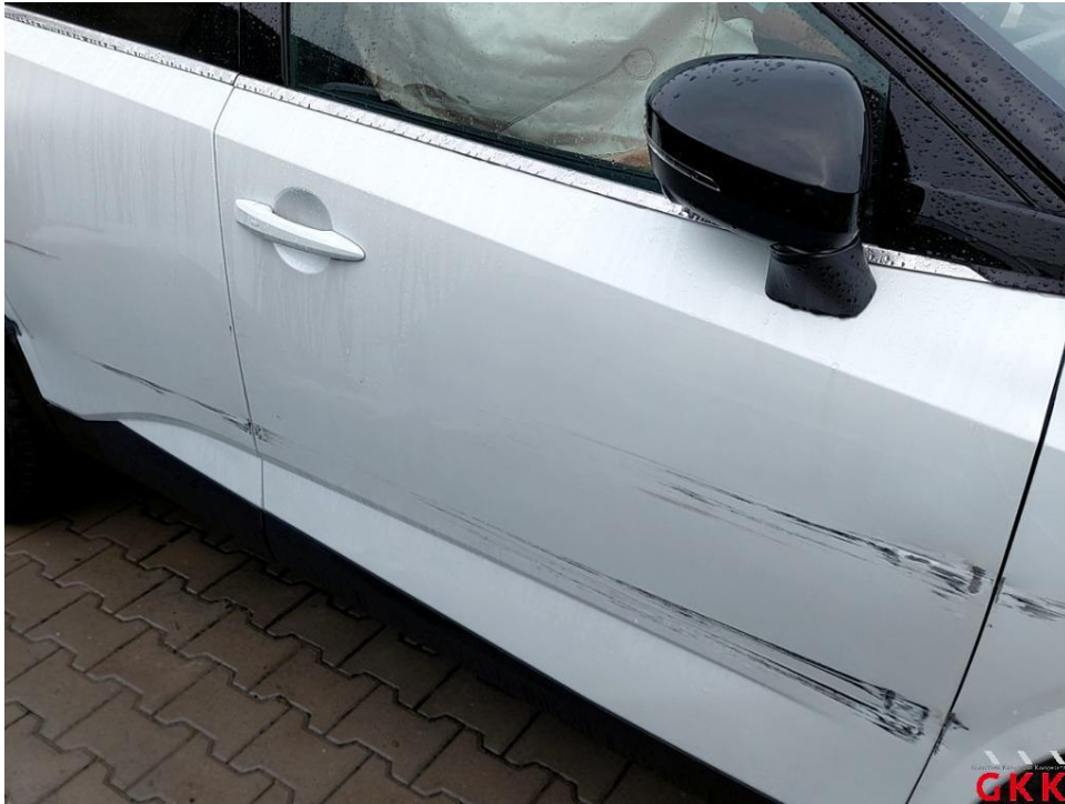
Bild 21 Tür vorn rechts verformt und verkratzt
