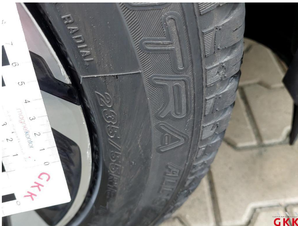
Bild 20 Rad/Reifen vorn rechts verkratzt/angestoßen
