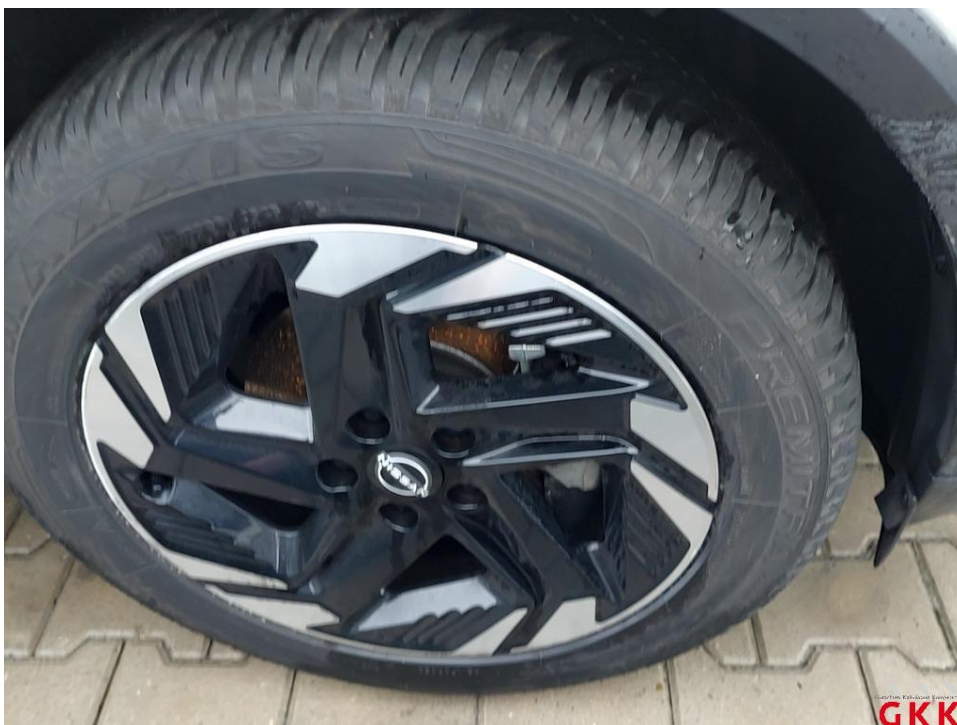
Bild 18 Rad/Reifen vorn rechts verkratzt/angestoßen
