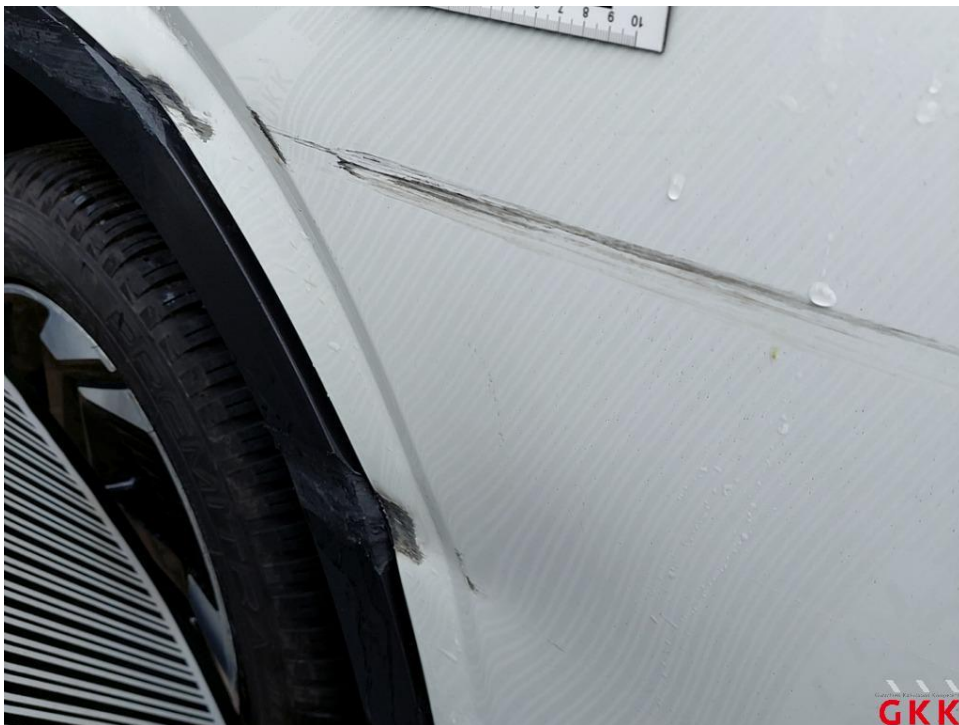
Bild 24 Tür hinten rechts verformt und verkratzt
