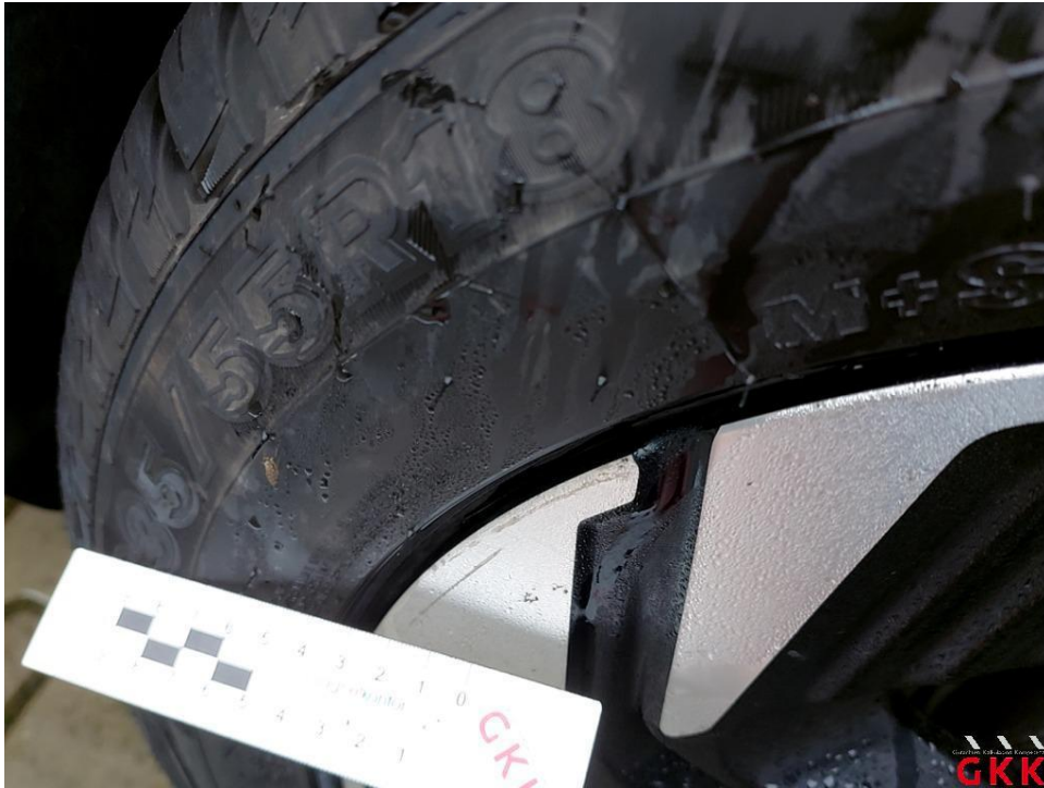
Bild 45 Rad/Reifen hinten links verkratzt/angestoßen
