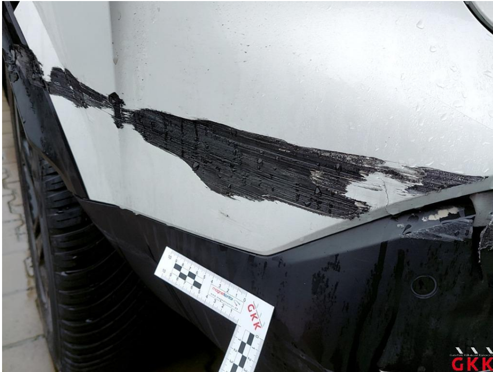
Bild 41 Stoßfänger hinten gestaucht und verkratzt
