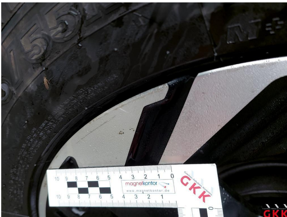
Bild 44 Rad/Reifen hinten links verkratzt/angestoßen
