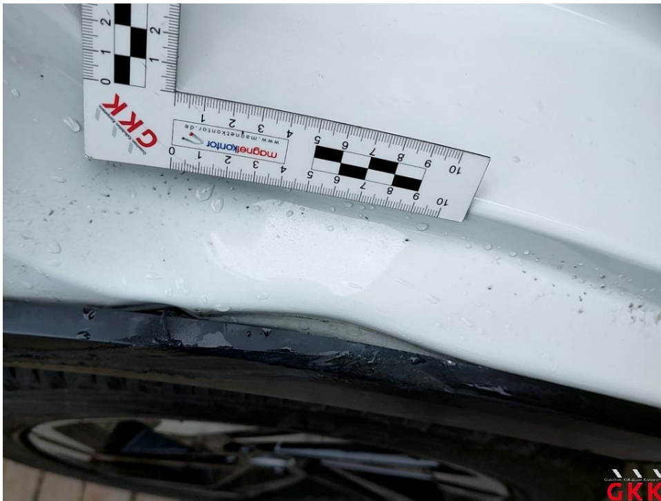
Bild 31 Seitenwand hinten rechts verformt und verkratzt
