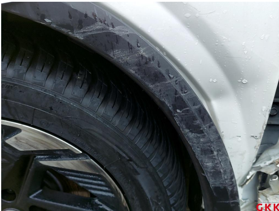
Bild 50 Kotflügel vorn links Radlaufblende verformt
