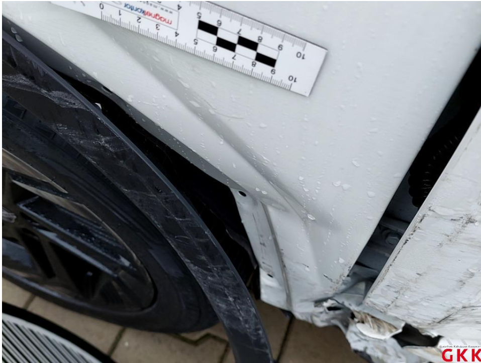
Bild 49 Kotflügel vorn links verformt und verkratzt
