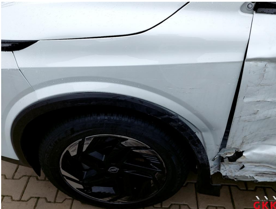
Bild 48 Kotflügel vorn links verformt und verkratzt
