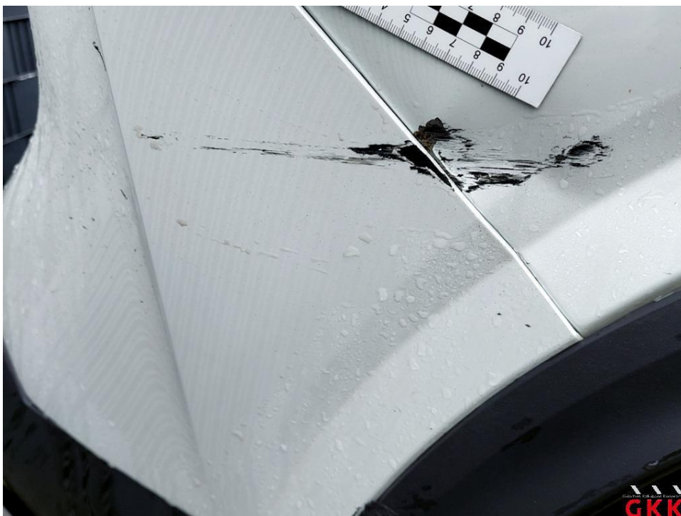
Bild 36 Stoßfänger hinten gestaucht und verkratzt
