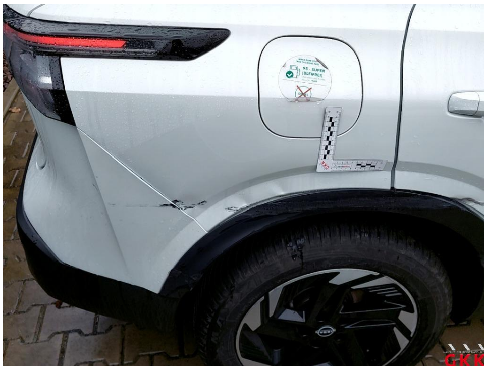
Bild 26 Seitenwand hinten rechts verformt und verkratzt
