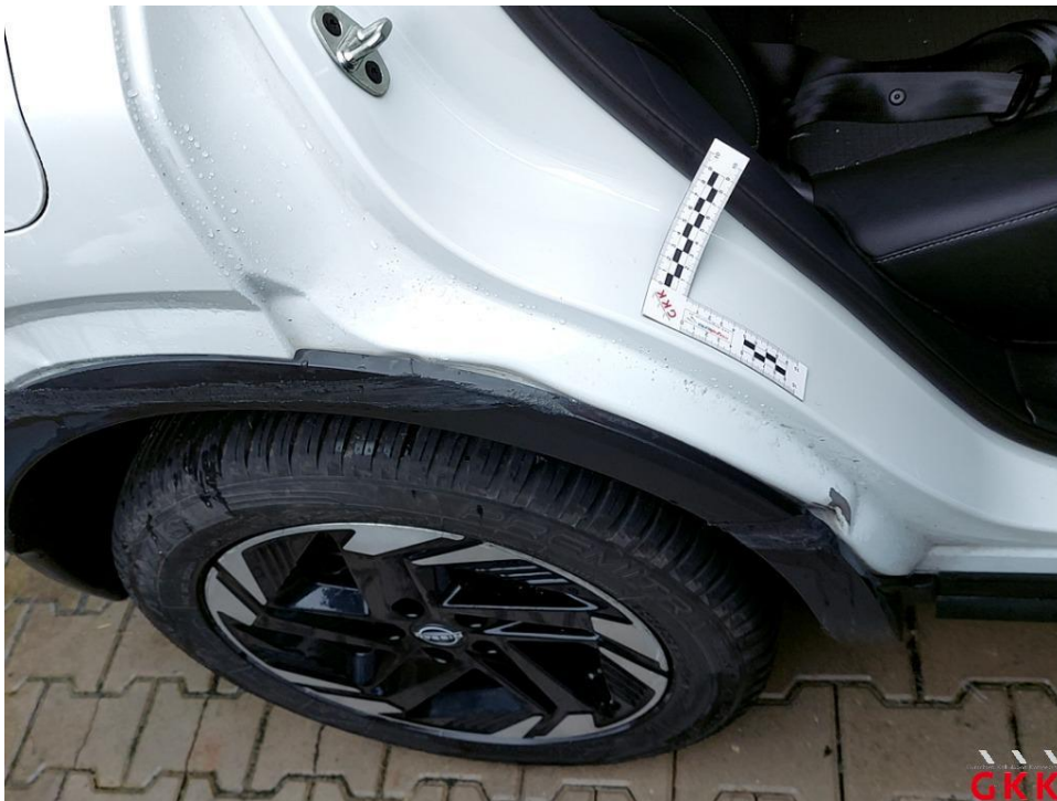
Bild 29 Seitenwand hinten rechts verformt und verkratzt
