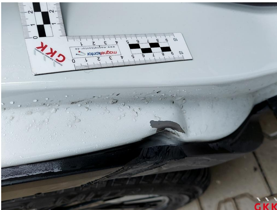
Bild 30 Seitenwand hinten rechts verformt und verkratzt
