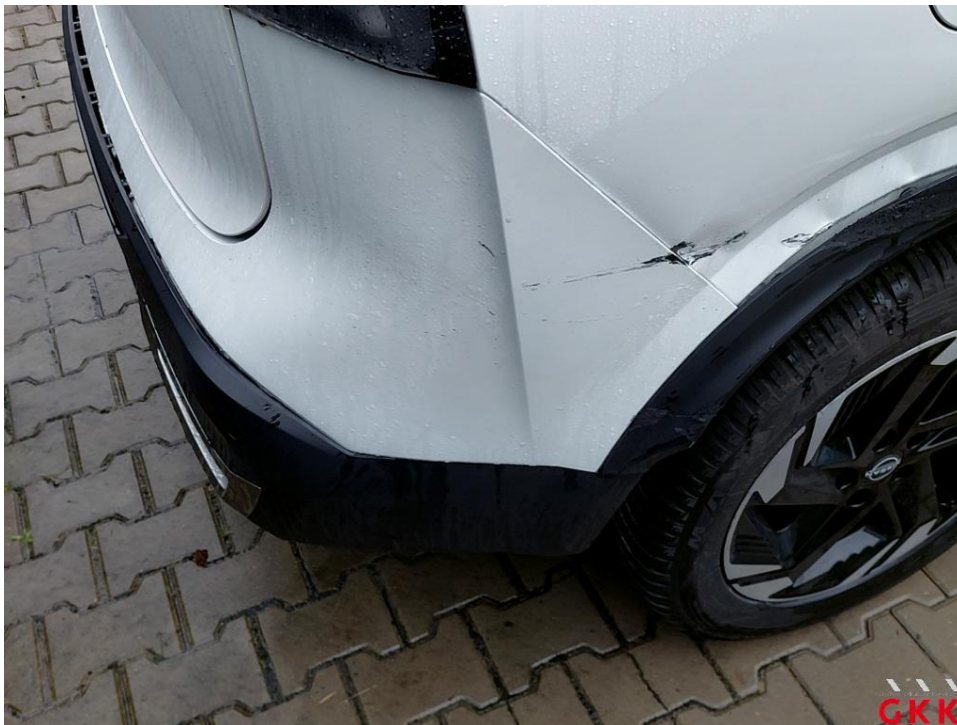
Bild 35 Stoßfänger hinten gestaucht und verkratzt
