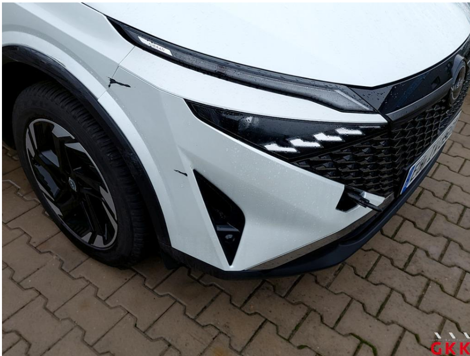
Bild 13 Stoßfänger vorn gestaucht und verkratzt
