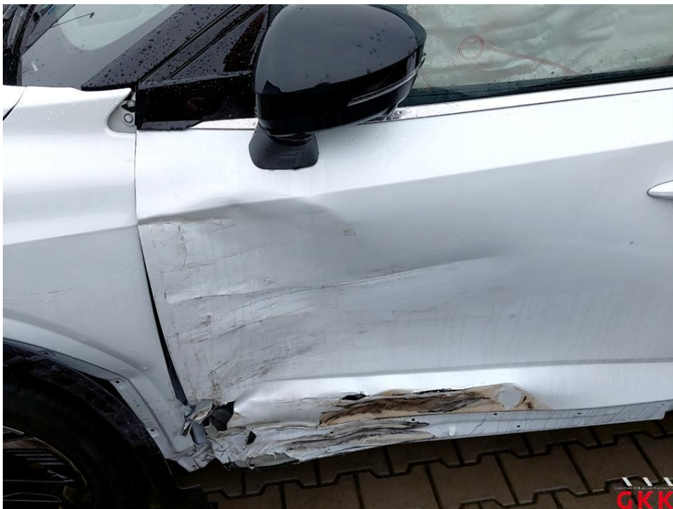
Bild 46 Tür vorn links eingerissen und verkratzt
