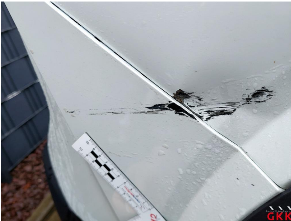
Bild 37 Stoßfänger hinten gestaucht und verkratzt
