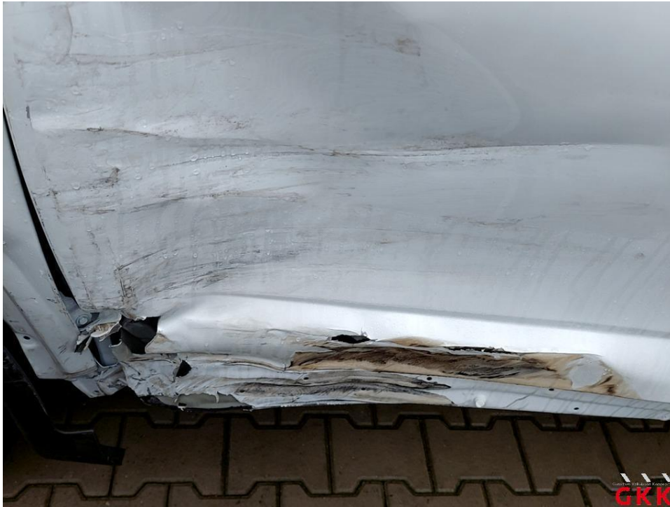
Bild 47 Tür vorn links eingerissen und verkratzt
