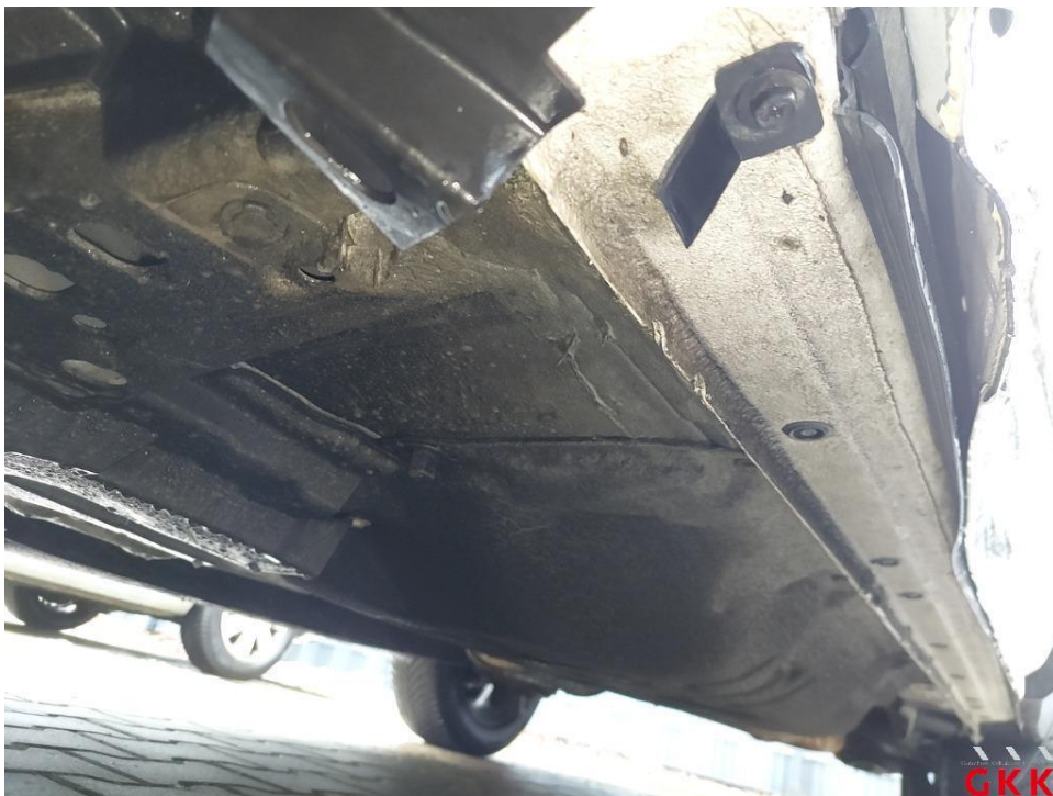
Bild 54 Schweller/Unterholm links eingedellt und verkratzt
