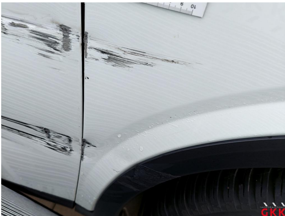
Bild 16 Kotflügel vorn rechts verformt und verkratzt
