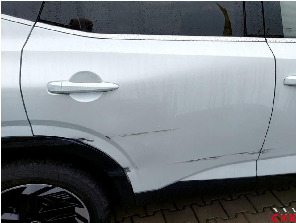
Bild 23 Tür hinten rechts verformt und verkratzt
