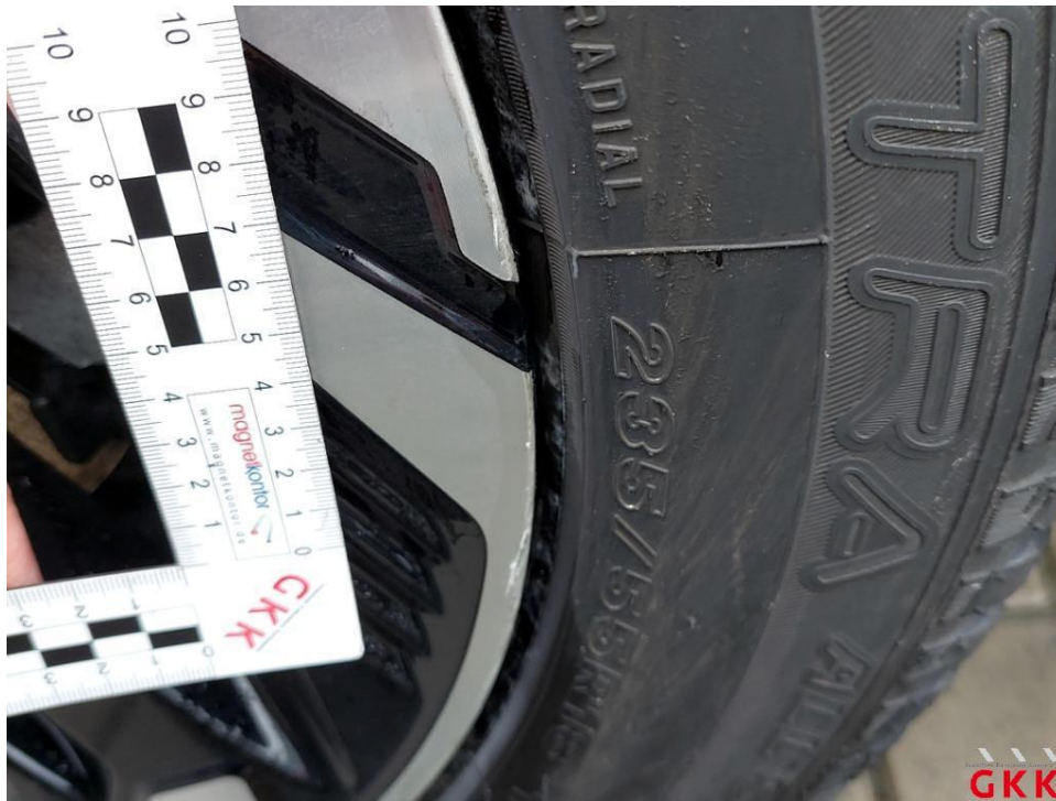
Bild 19 Rad/Reifen vorn rechts verkratzt/angestoßen
