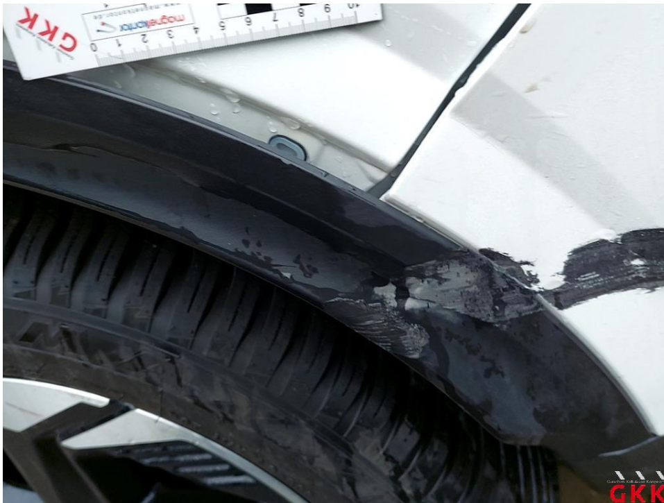
Bild 43 Radlaufverkleidung hinten links verformt und verkratzt
