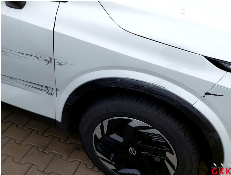
Bild 15 Kotflügel vorn rechts verformt und verkratzt
