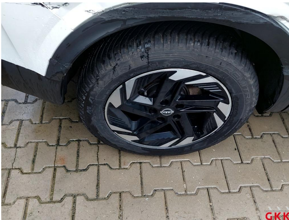
Bild 32 Rad/Reifen hinten rechts verkratzt/angestoßen
