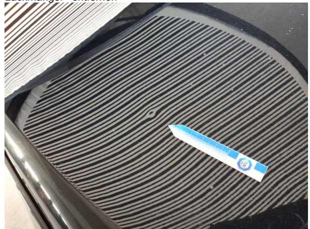
Beschädigung #15: Motorhaube: Motorhaube - Delle(n) - sanft instandsetzen
