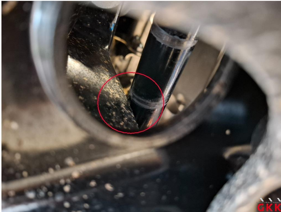
Bild 17 Gelenkwelle an Aggregateträger angeschlagen
