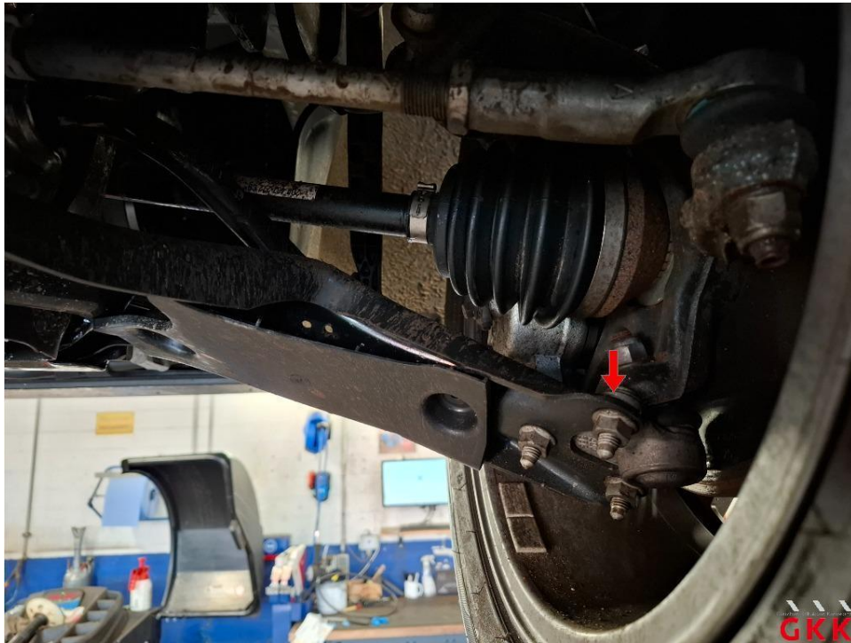
Bild 15 Querlenker vorne rechts deformiert
