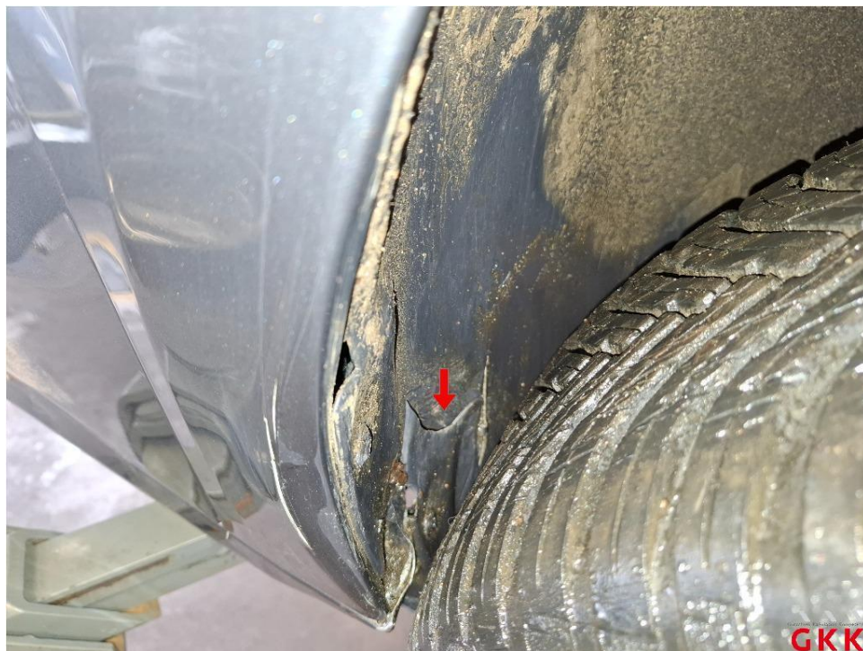
Bild 12 Radhausschale vorne rechts deformiert
