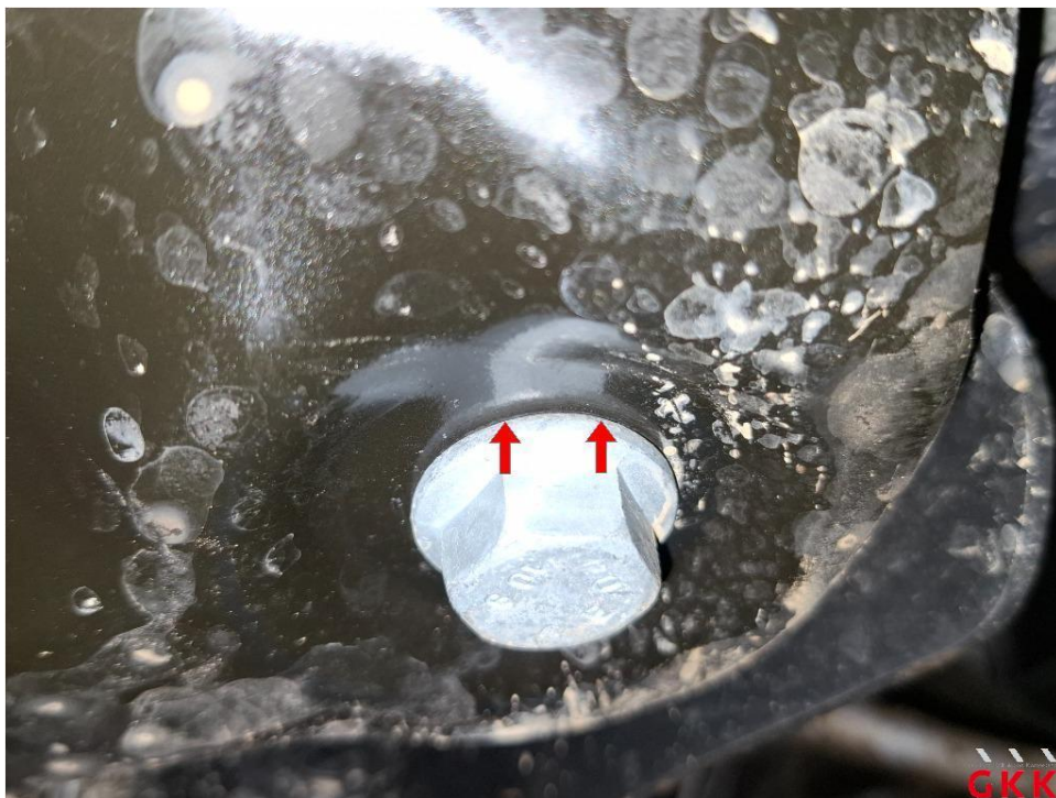
Bild 18 Aggregateträger nach hinten verschoben
