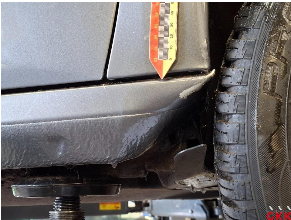
Bild 10 Schweller vorne rechts deformiert
