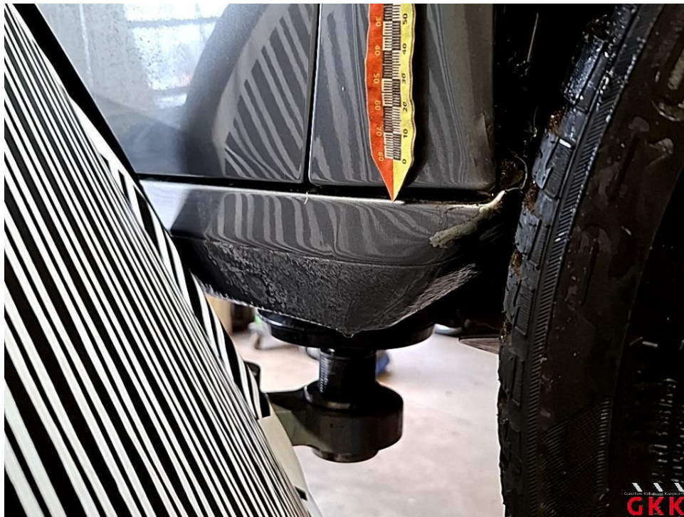
Bild 11 Trailer vorne rechts deformiert
