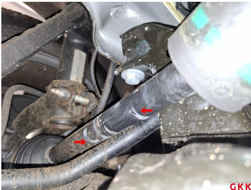
Bild 16 Gelenkwelle vorne rechts deformiert
