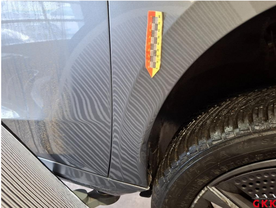
Bild 9 Kotflügel vorne rechts deformiert
