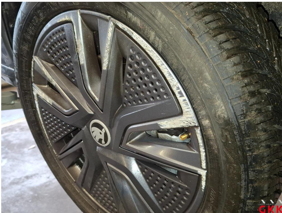
Bild 8 Scheibenrad vorne rechts deformiert
