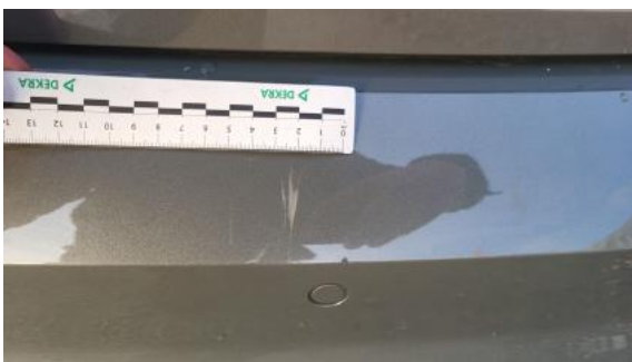
Fot. 27 Zderzak lakier. TYŁ - zarysowanie 1
