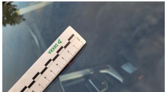
Fot. 26 Szyba barwiona PRZ - odprysk szkła 1
