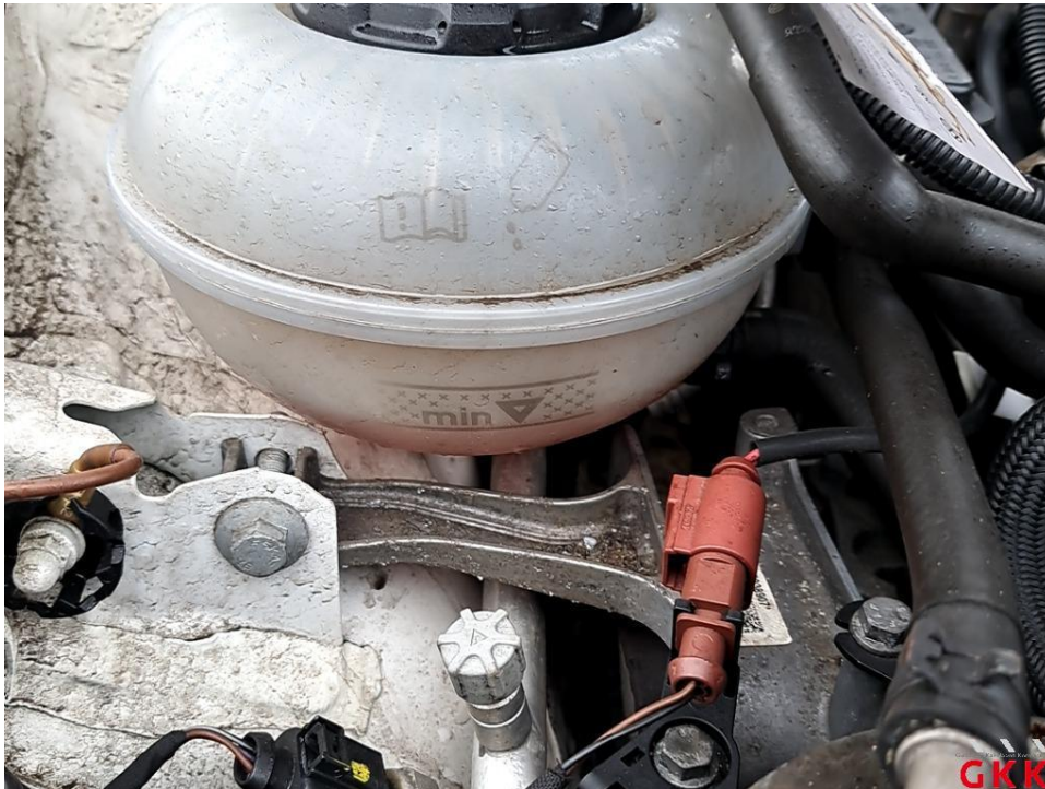
Bild 15 Kühlsystem, Kühlmittelstand, unter Minimum, prüfen
