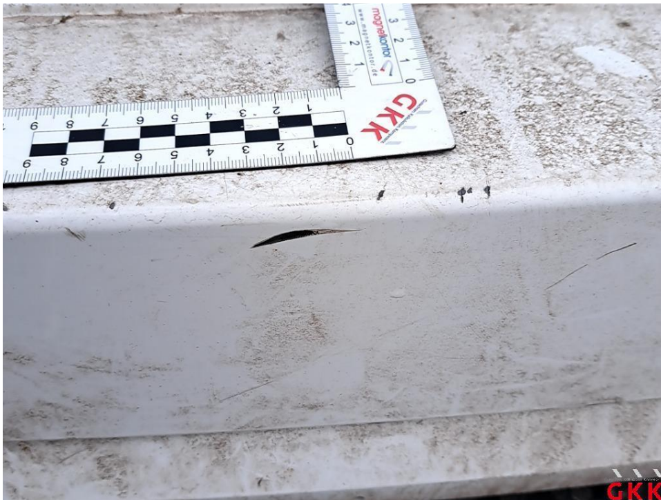
Bild 22 Stoßfänger hinten, Verkleidung -lackiert-, verkratzt, lackieren
