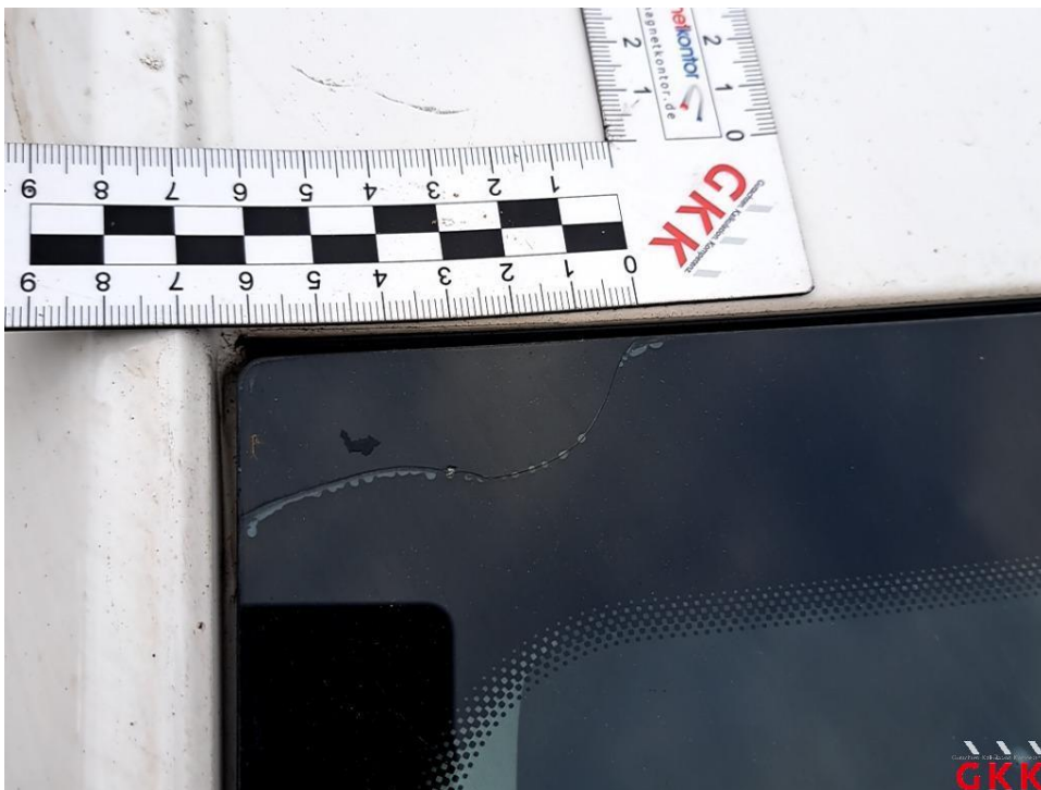
Bild 18 Frontscheibe, mit Regensensor, gerissen, ersetzen
