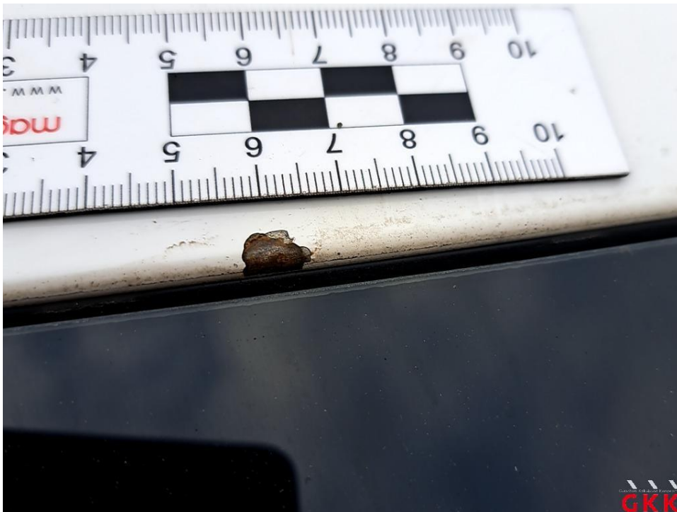
Bild 20 Dach, Lackierung abgeplatzt, Smartrepair
