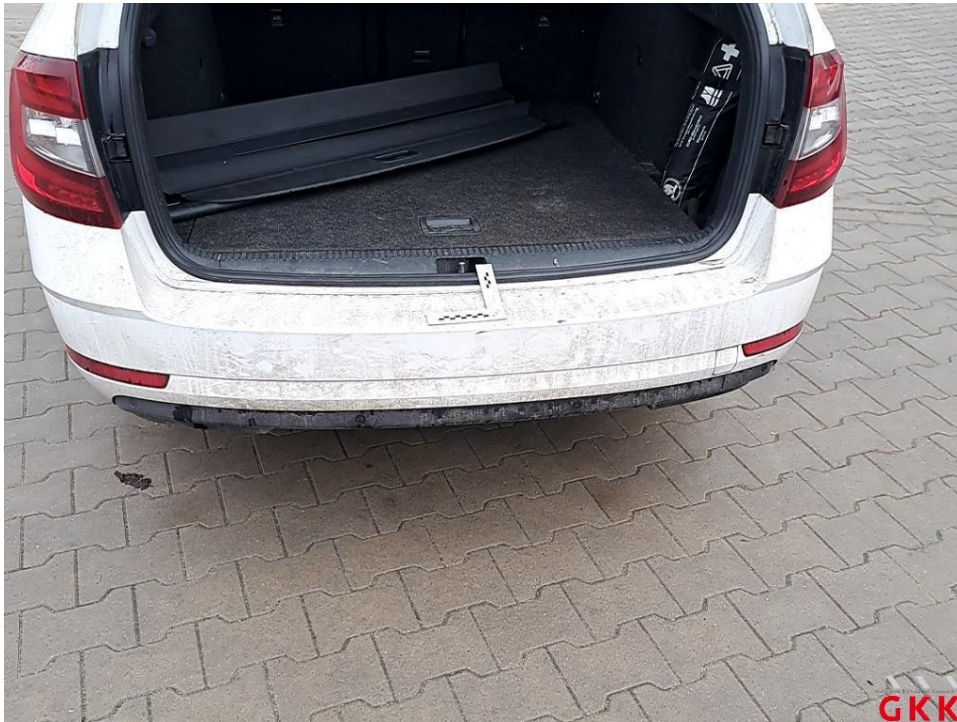
Bild 21 Stoßfänger hinten, Verkleidung -lackiert-, verkratzt, lackieren
