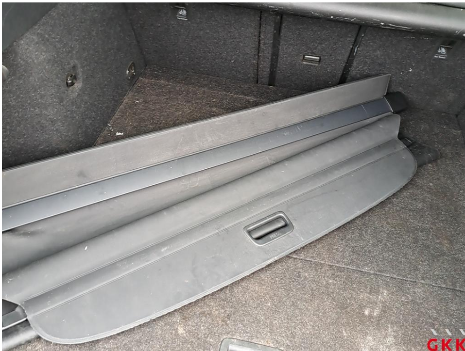
Bild 16 Laderaum, Abdeckung, defekt, ersetzen
