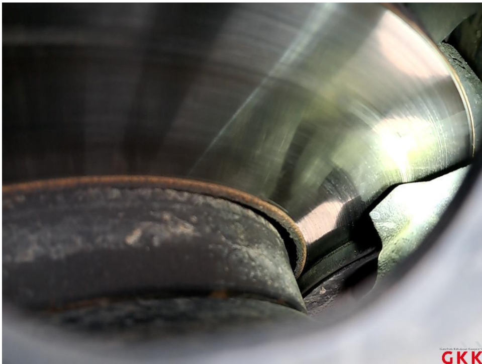
Bild 24 Bremsbeläge, vorne, Untermaß, ersetzen
