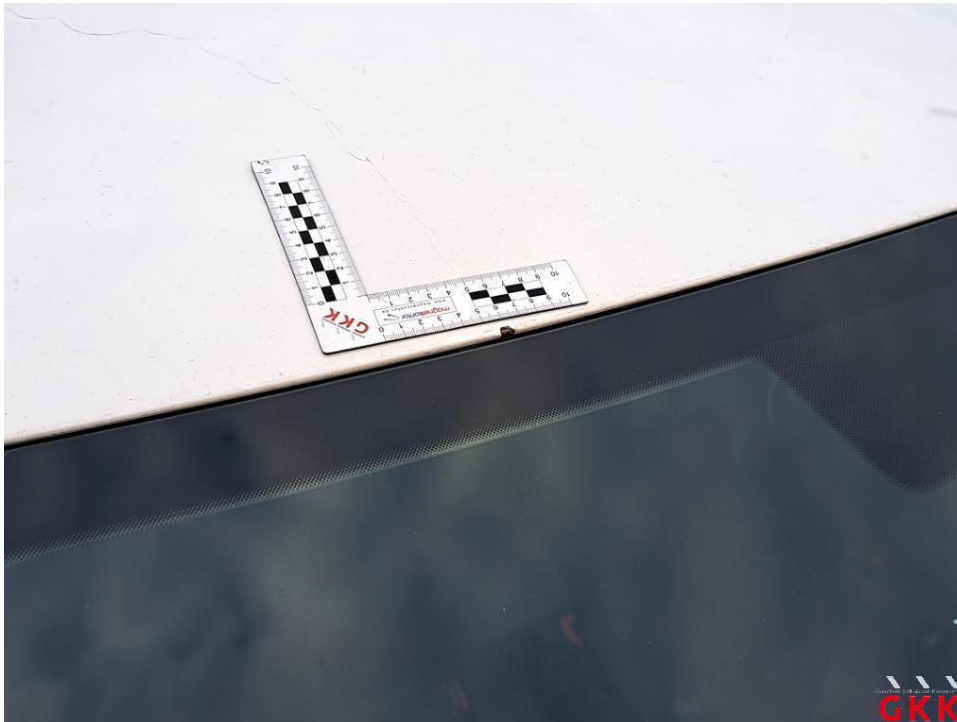
Bild 19 Dach, Lackierung abgeplatzt, Smartrepair
