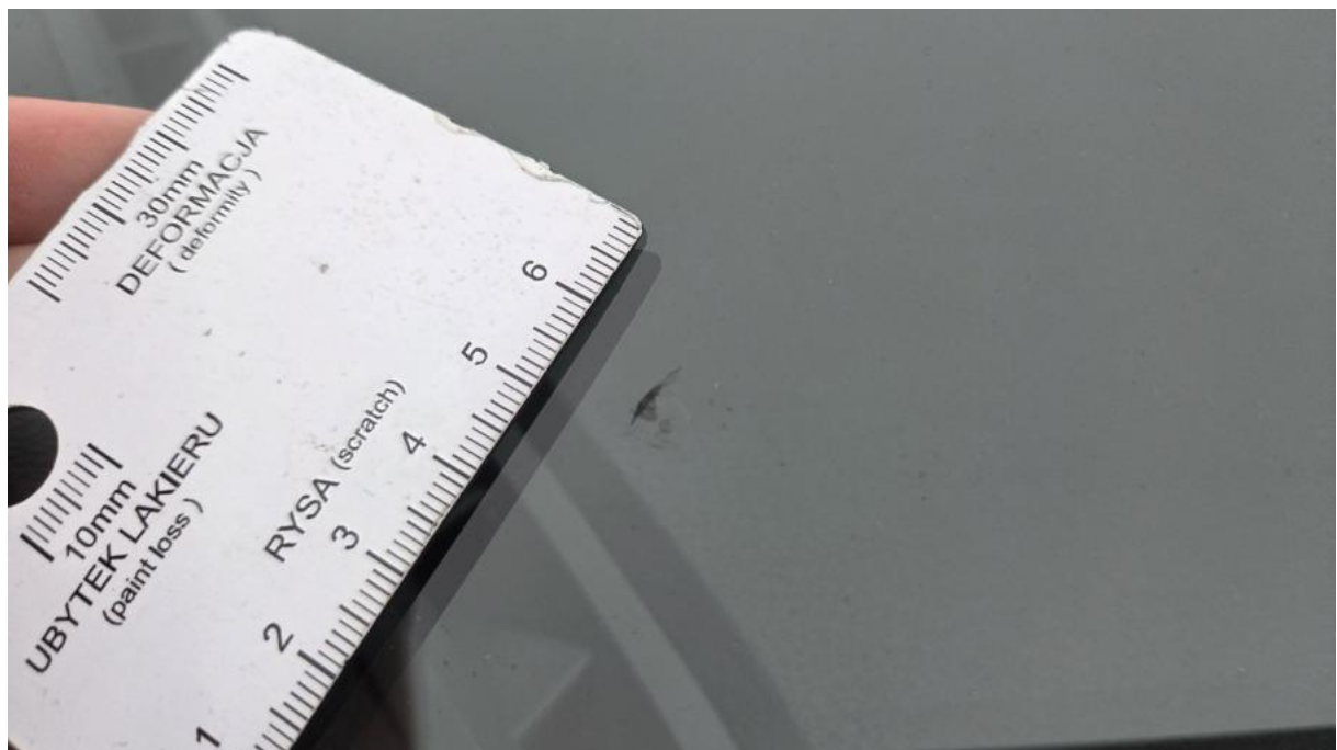
Fot. 32 Szyba czołowa - Rysa/odprysk 1
