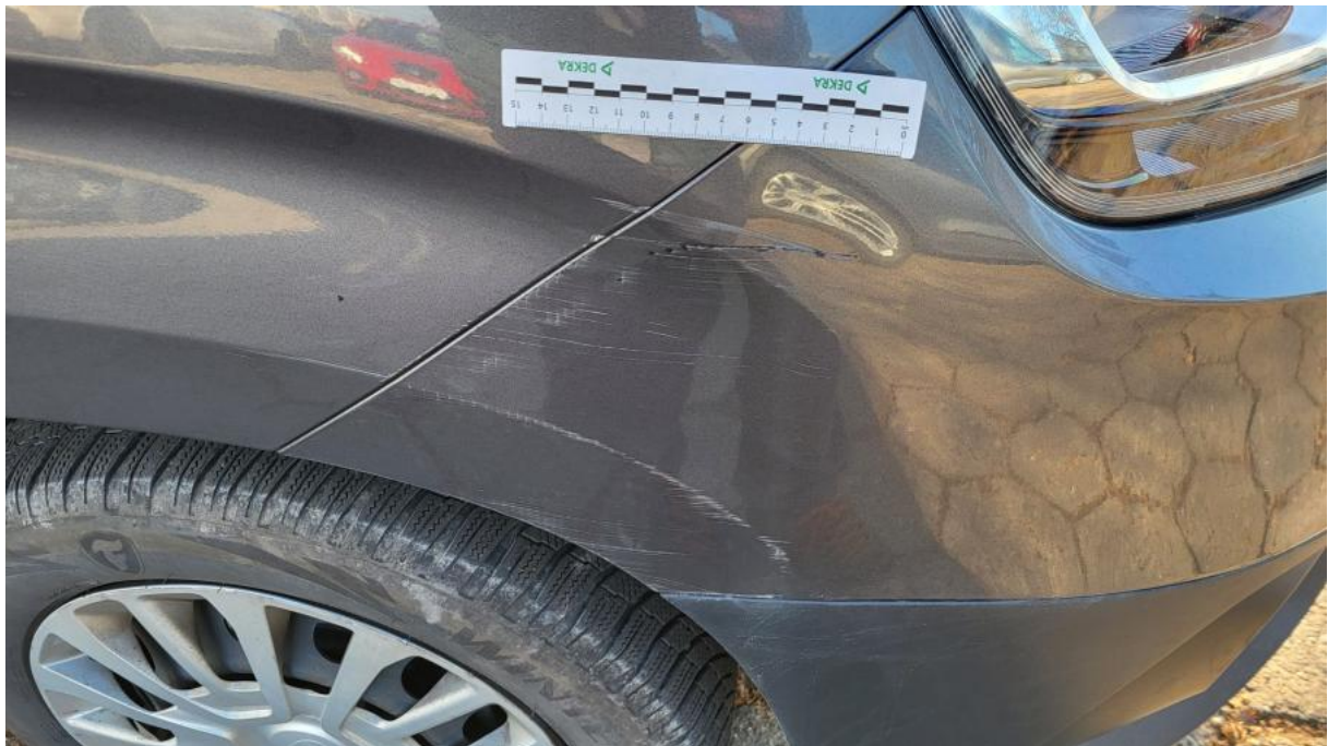
Fot. 32 Zderzak - Rysa/odprysk 1
