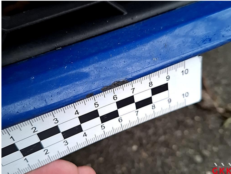
Bild 17 unten links Stoßfänger vorne, Verkleidung -lackiert-, verkratzt, Smartrepair
