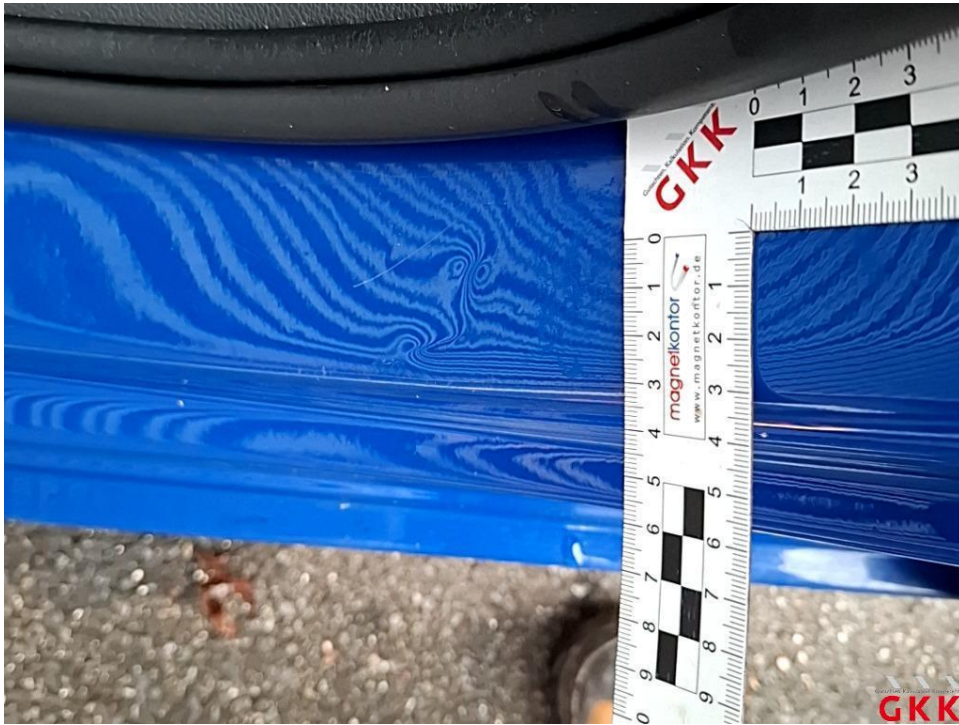
Bild 33 Tür vorne links, Einstieg, beschädigt, instand setzen - lackieren
