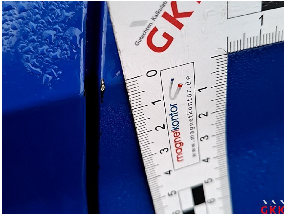
Bild 29 Tür hinten links, Kante, verkratzt, auslegen, schleifen, polieren
