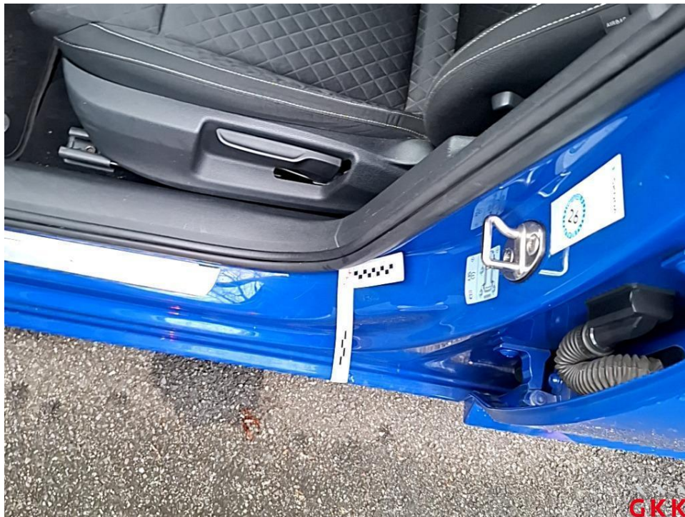
Bild 32 Tür vorne links, Einstieg, beschädigt, instand setzen - lackieren
