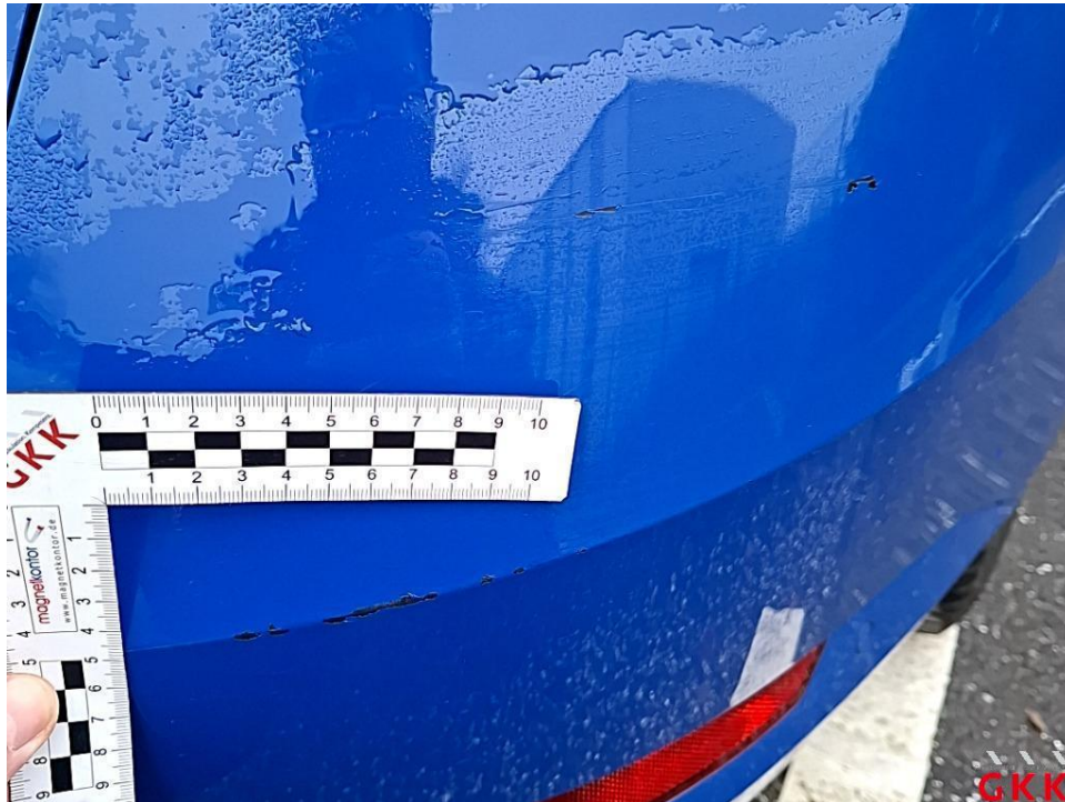
Bild 25 Stoßfänger hinten, Verkleidung -lackiert-, verkratzt, Smartrepair
