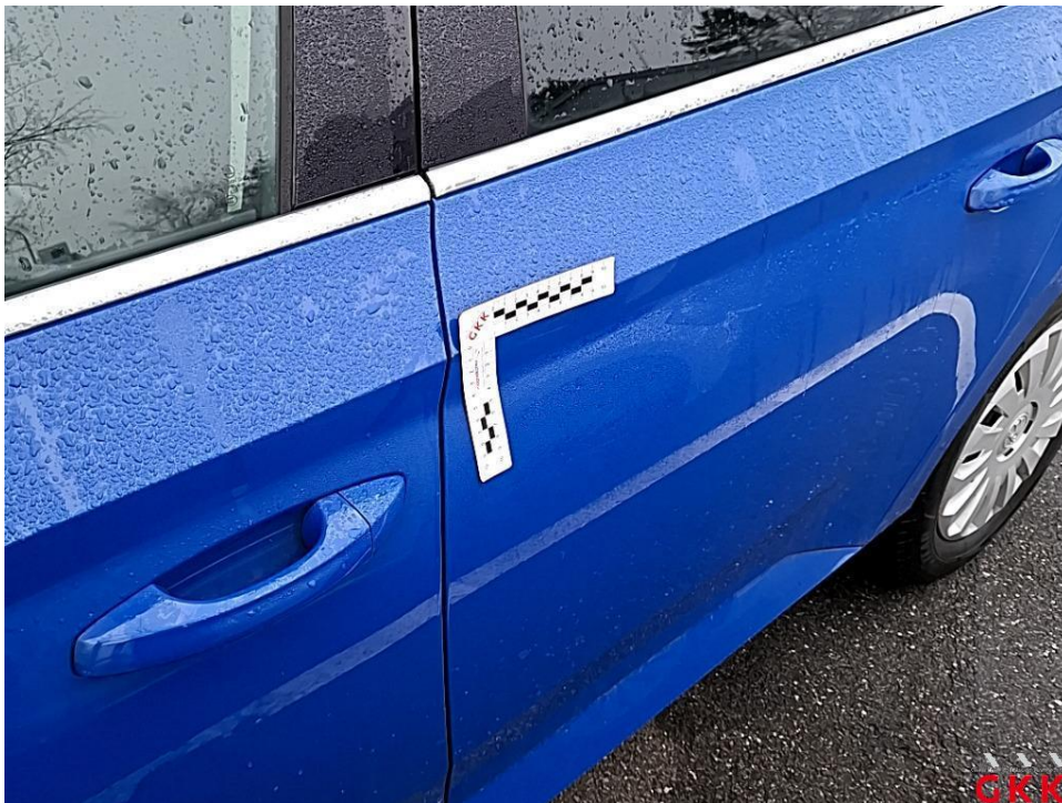
Bild 28 Tür hinten links, Kante, verkratzt, auslegen, schleifen, polieren
