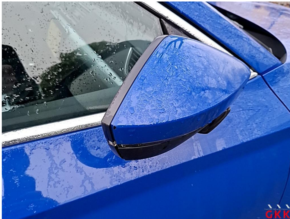
Bild 20 Spiegelgehäuse rechts, Blende -lackiert-, verkratzt, auslegen, schleifen, polieren
