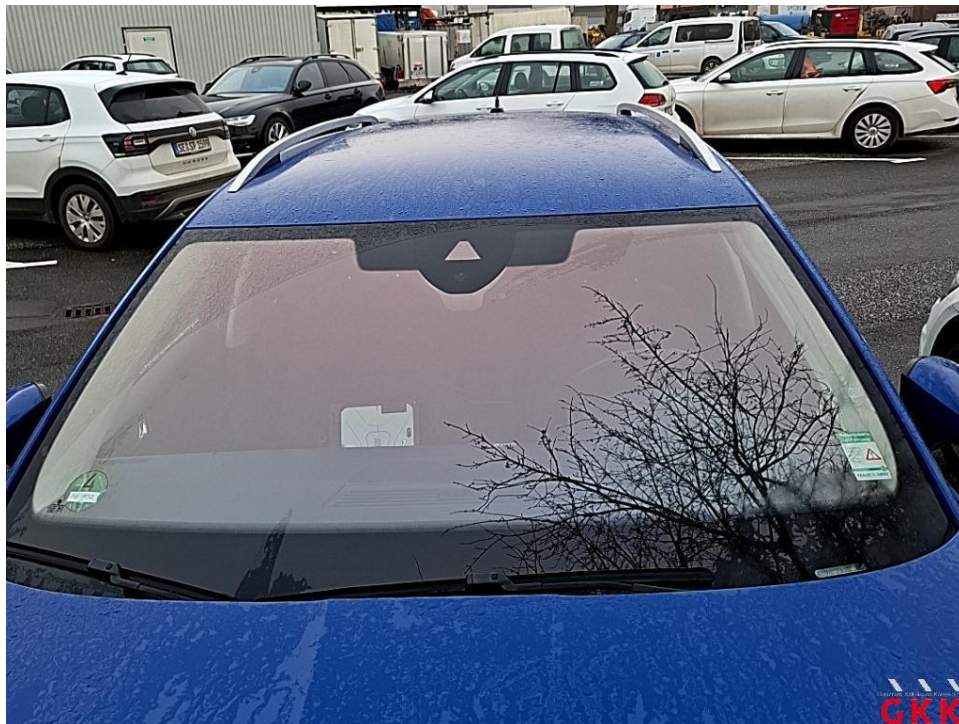
Bild 18 Frontscheibe, Steinschlag im Sichtfeld, ersetzen
