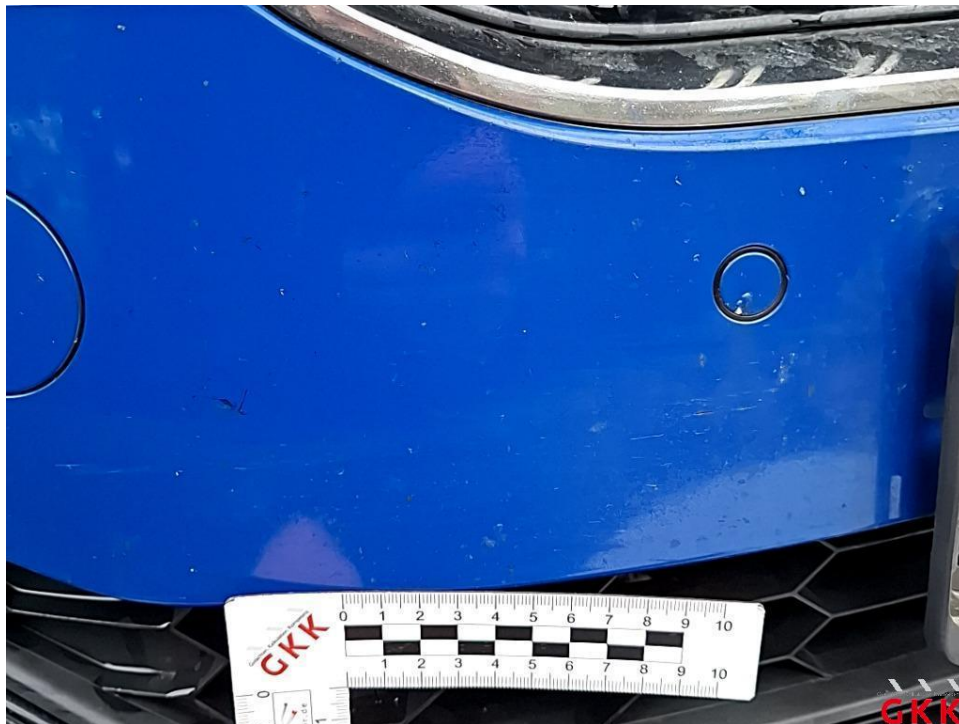
Bild 16 Mitte rechts Stoßfänger vorne, Verkleidung -lackiert-, verkratzt, Smartrepair
