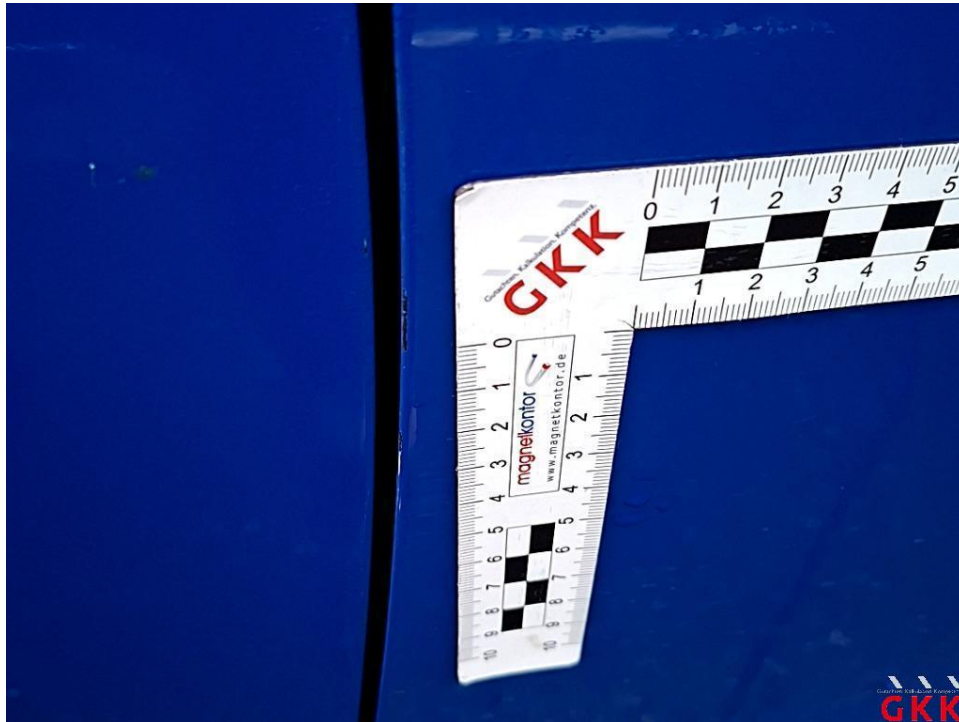
Bild 23 Tür vorne rechts, Kante, verkratzt, auslegen, schleifen, polieren
