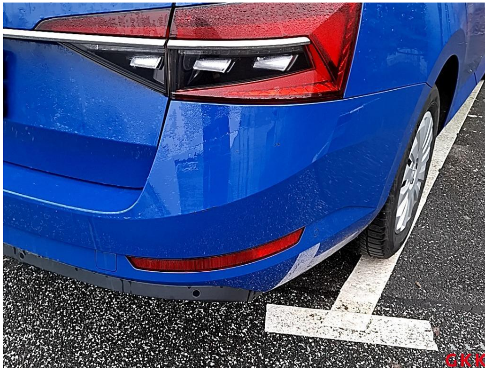
Bild 24 Stoßfänger hinten, Verkleidung -lackiert-, verkratzt, Smartrepair
