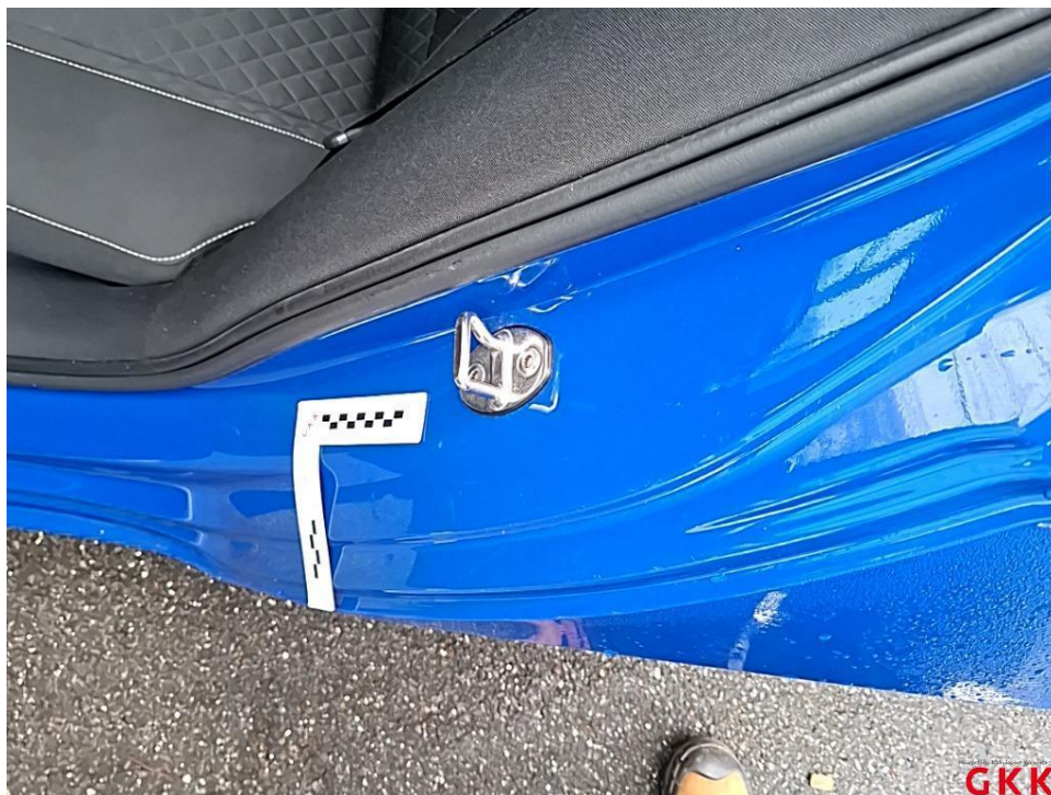
Bild 26 Tür hinten links, Einstieg, beschädigt, instand setzen - lackieren
