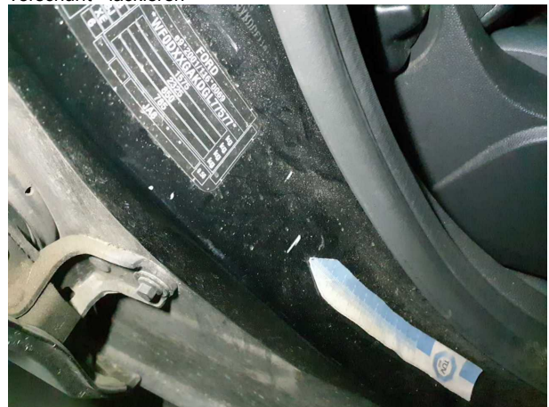
Beschädigung #8: Schweller rechts: Einstieg (Vo.re) - verkratzt / verschürft - lackieren
