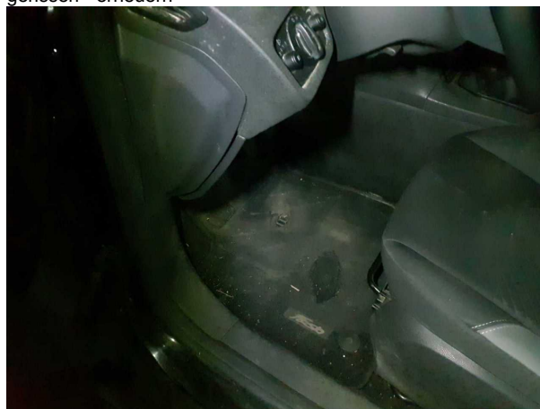
Beschädigung #2: Verkleidungen/Abdeckungen: Fußmatten - gebrochen / gerissen - erneuern
