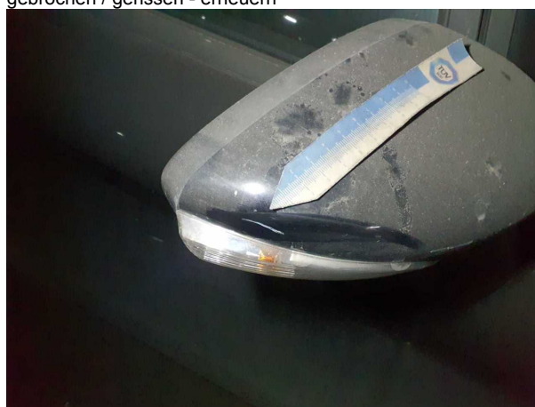
Beschädigung #6: Außenspiegel rechts: Abdeckkappe - verkratzt / verschürft - lackieren
