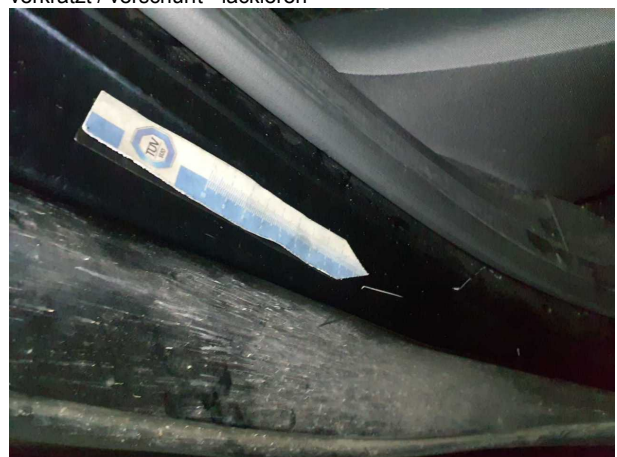
Beschädigung #9: Schweller rechts: Einstieg (Hi.re) - verkratzt / verschürft - lackieren
