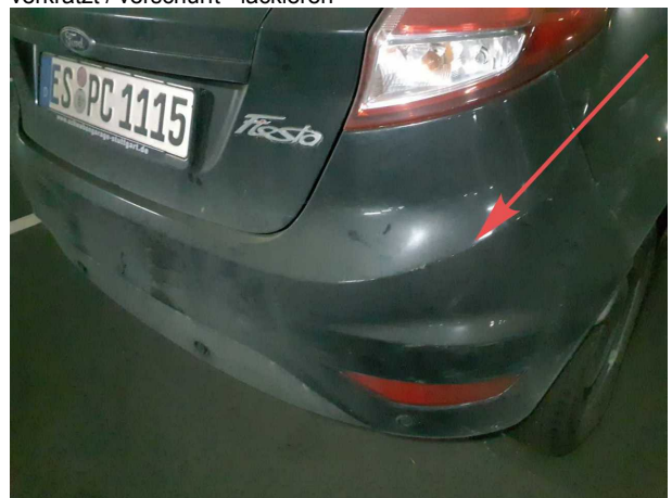
Beschädigung #10: Stossfänger hinten: Stossfänger hinten - verkratzt / verschürft - lackieren
