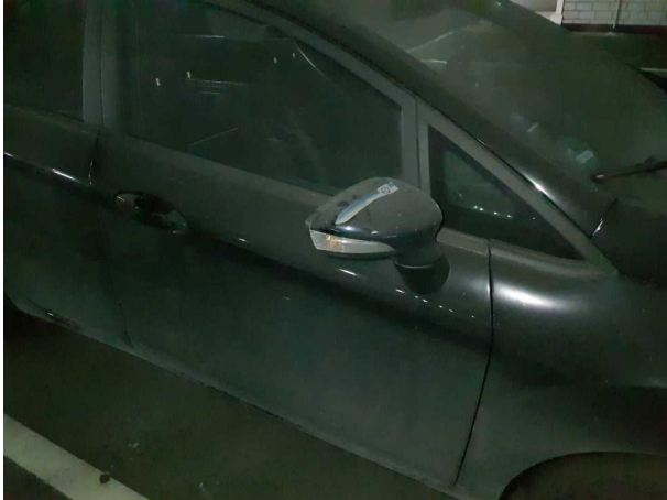
Beschädigung #6: Außenspiegel rechts: Abdeckkappe - verkratzt / verschürft - lackieren
