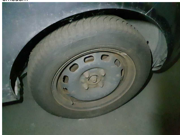
Beschädigung #12: Rad/Reifen: Reifensatz komplett - defekt - erneuern
