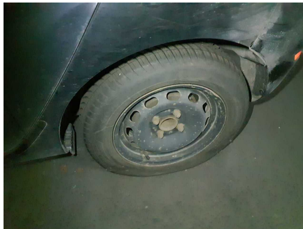
Beschädigung #12: Rad/Reifen: Reifensatz komplett - defekt - erneuern
