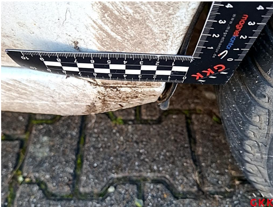
Bild 16 Schweller rechts, vorne, beschädigt, instand setzen - lackieren
