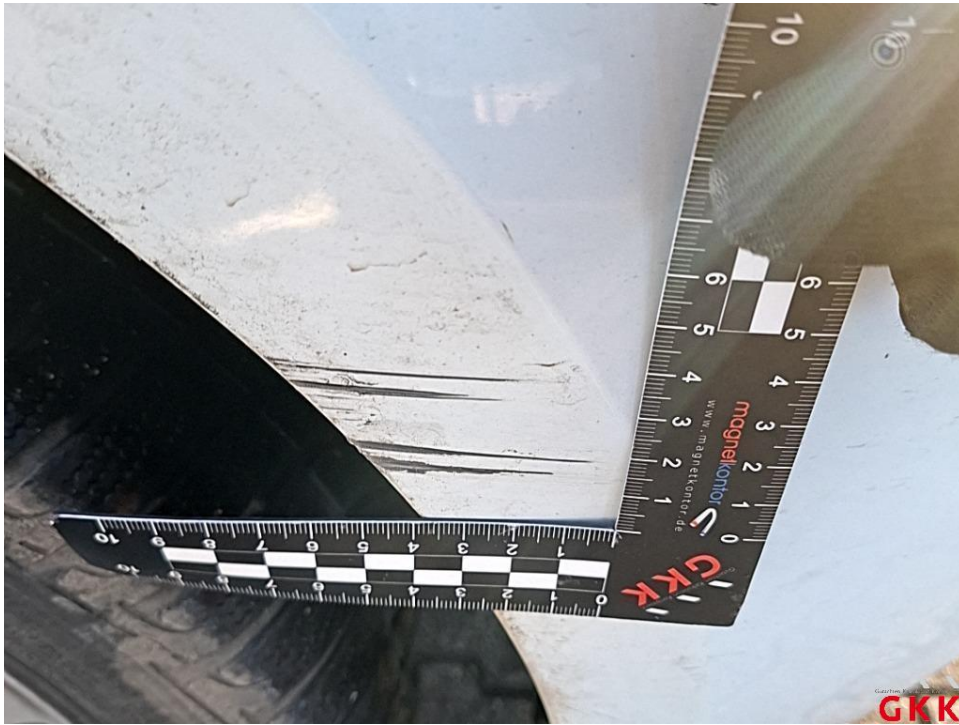
Bild 17 Stoßfänger vorne, Verkleidung -lackiert-, beschädigt, lackieren
