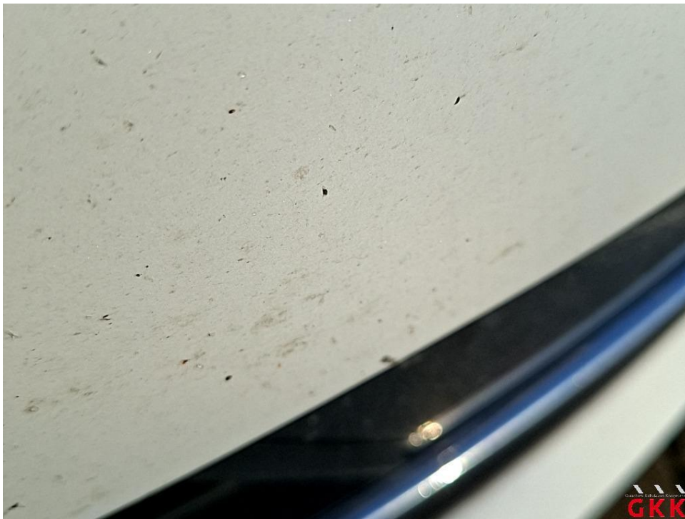
Bild 18 Stoßfänger vorne, Verkleidung -lackiert-, beschädigt, lackieren
