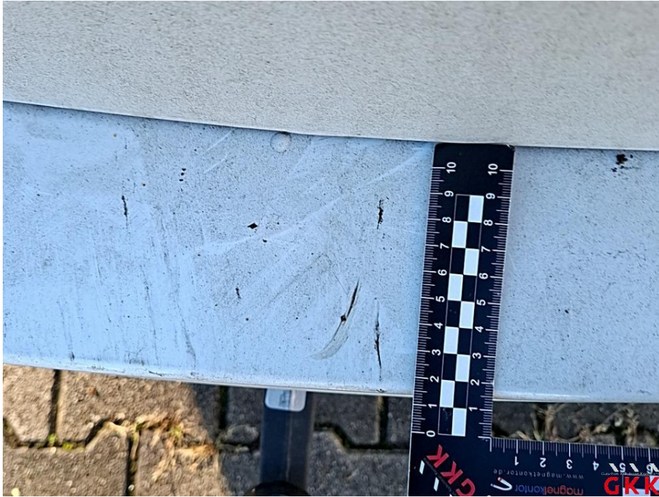
Bild 21 Stoßfänger hinten, Verkleidung -lackiert-, verkratzt, lackieren
