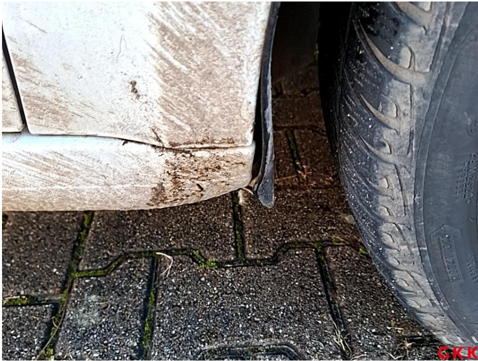
Bild 15 Schweller rechts, vorne, beschädigt, instand setzen - lackieren
