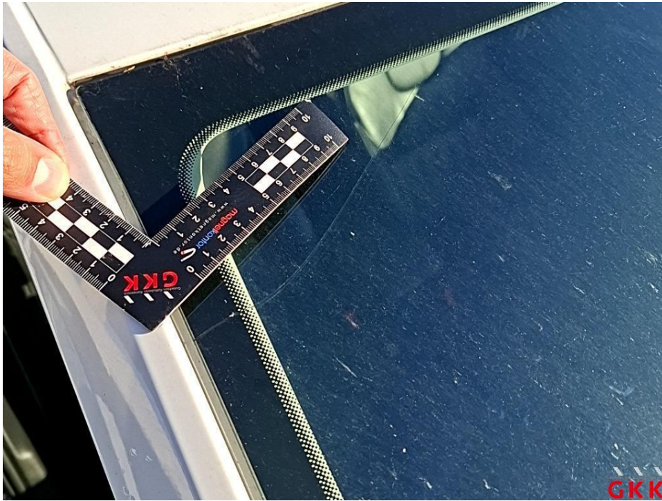
Bild 25 Frontscheibe, beheizt mit Regensensor und Frontkamera, gerissen, ersetzen
