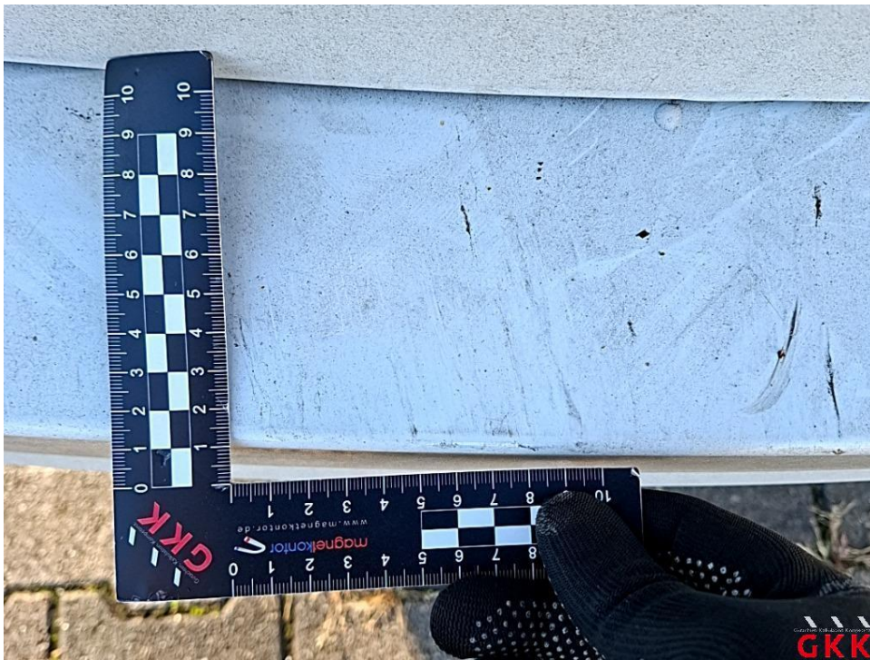
Bild 22 Stoßfänger hinten, Verkleidung -lackiert-, verkratzt, lackieren
