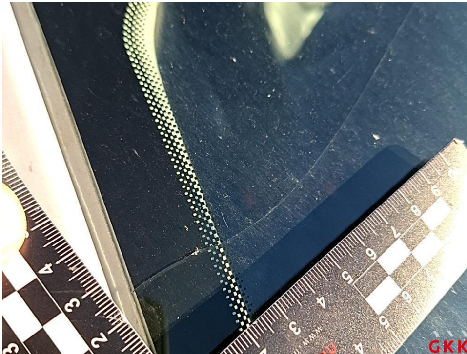
Bild 26 Frontscheibe, beheizt mit Regensensor und Frontkamera, gerissen, ersetzen
