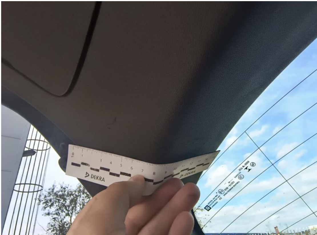
Fot. 111 Wykładzina pokrywy tylnej() - Rysa/odprysk 3
