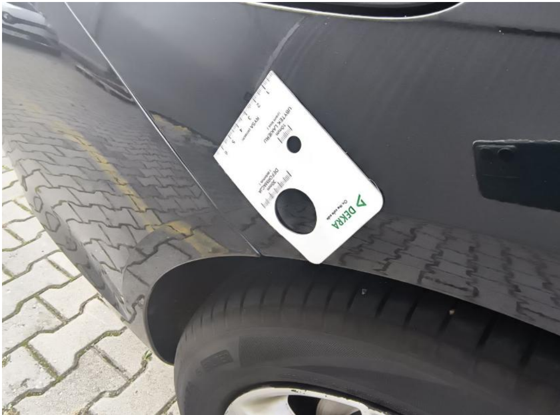
Fot. 57 Błotnik tylny P / Ściana boczna P - Wgniecenie/odkształcenie 2
