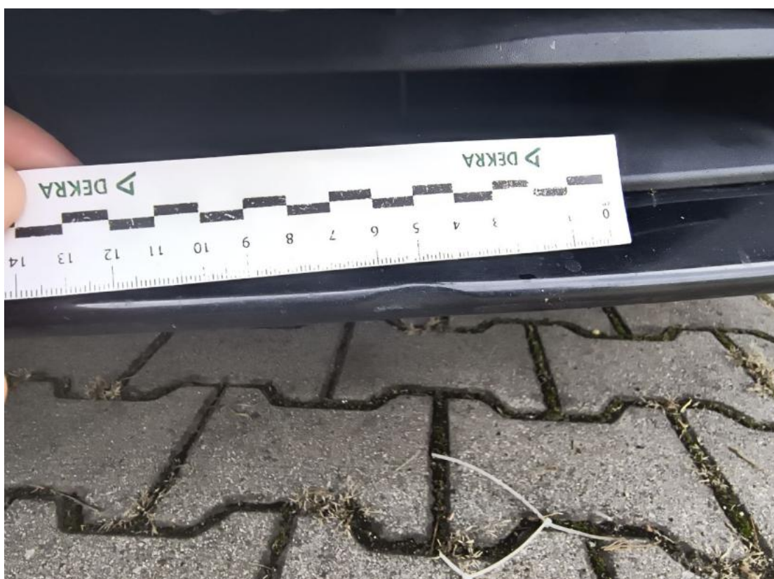
Fot. 44 Zderzak - Wgniecenie/odkształcenie 2
