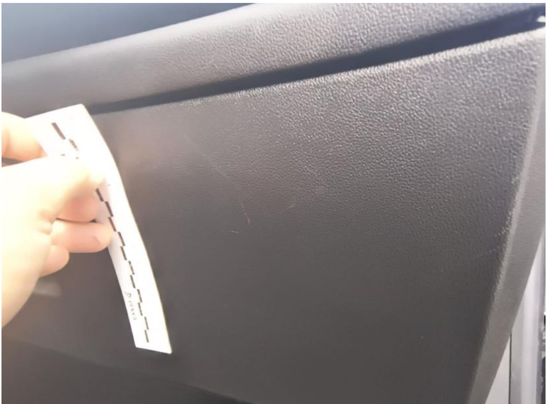
Fot. 80 Pokrywa schowka deski rozd. - Rysa/odprysk 1
