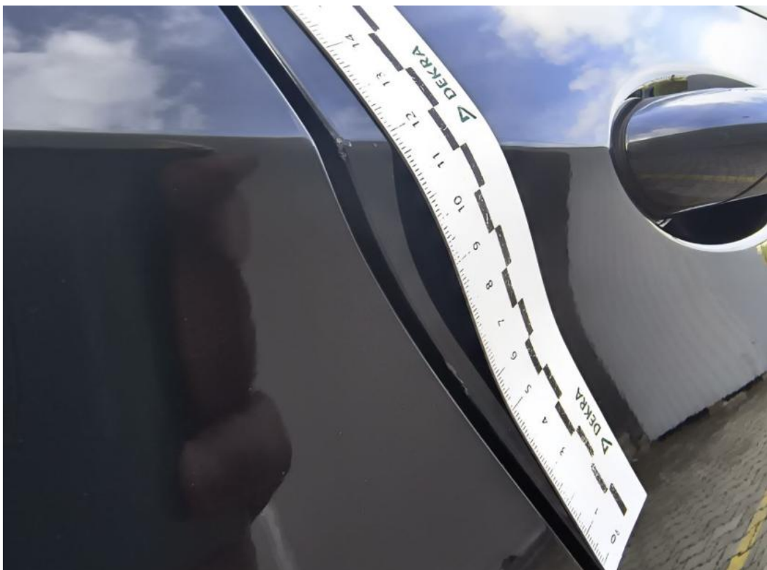
Fot. 52 Drzwi tylne P - Rysa/odprysk 2
