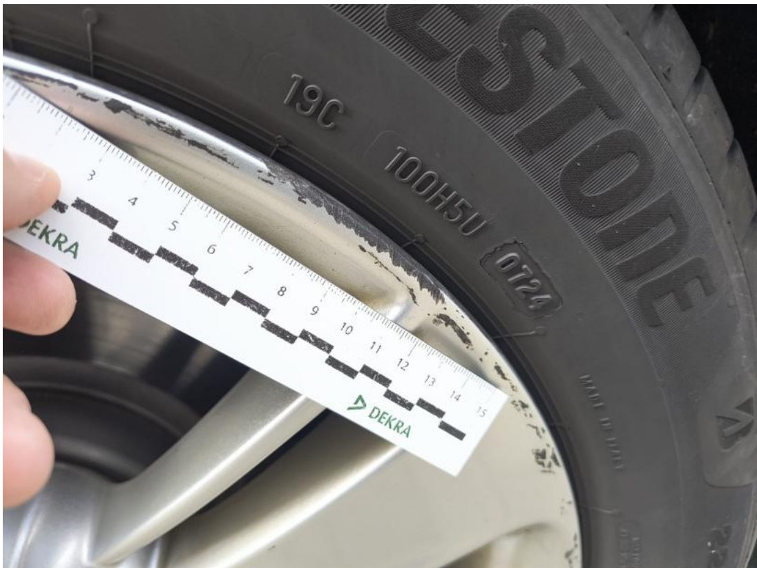
Fot. 59 Felga aluminiowa tylna P - Wgniecenie/odkształcenie 1
