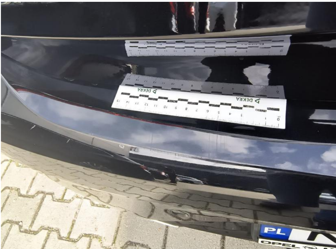
Fot. 64 Zderzak tylny() - Rysa/odprysk 3
