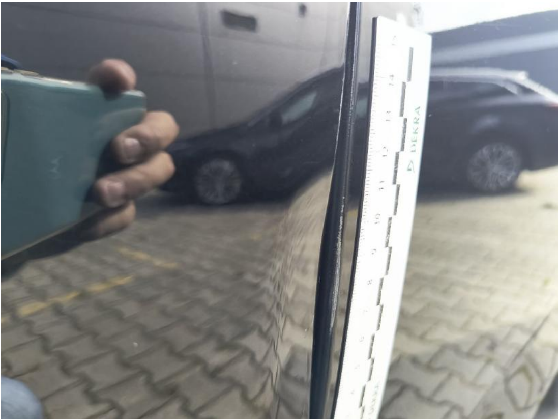
Fot. 73 Drzwi tylne L - Rysa/odprysk 2
