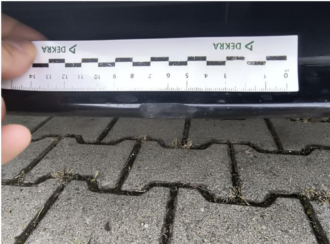
Fot. 45 Zderzak() - Wgniecenie/odkształcenie 3
