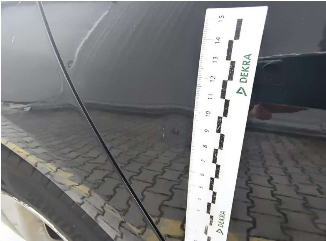
Fot. 53 Drzwi tylne P - Wgniecenie/odkształcenie 1
