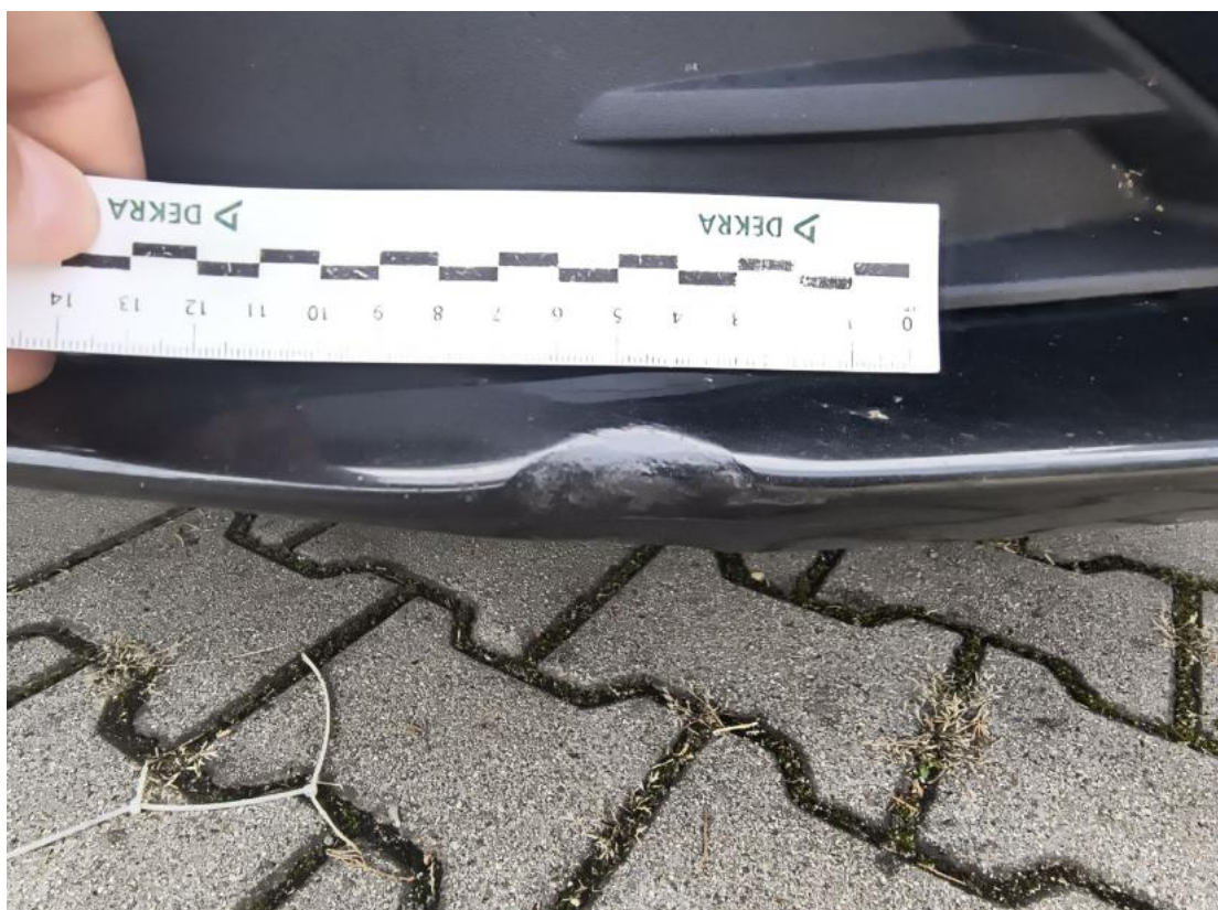
Fot. 43 Zderzak - Wgniecenie/odkształcenie 1
