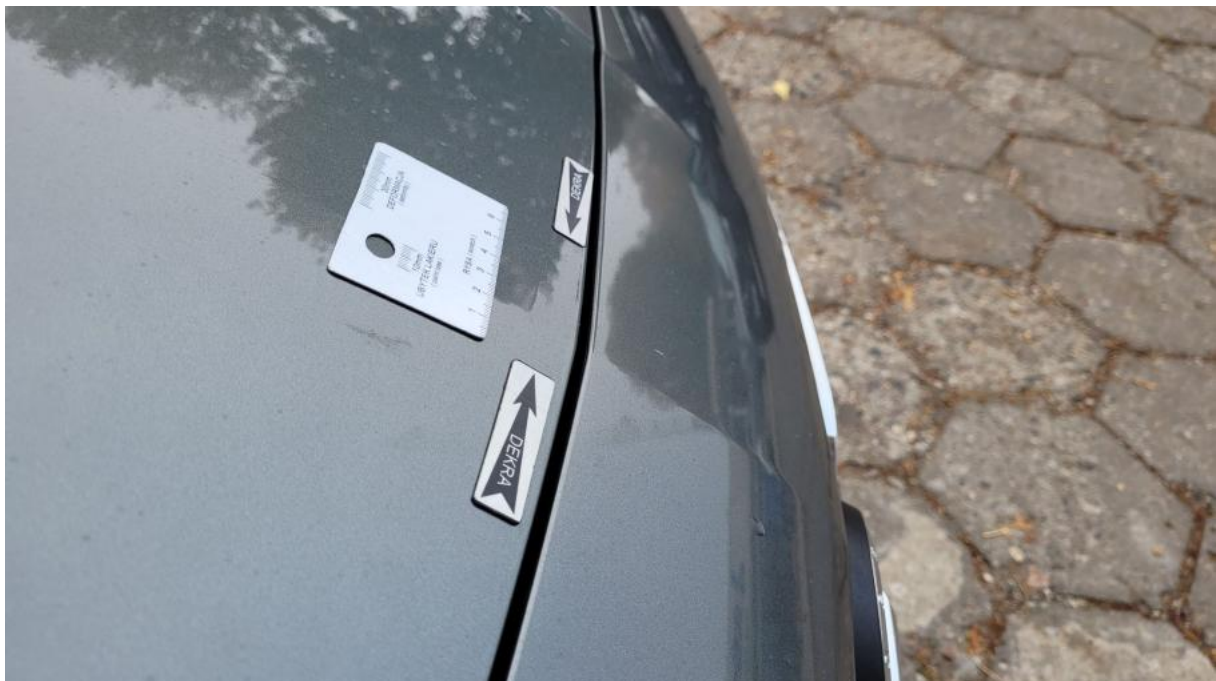
Fot. 34 Pokrywa komory silnika - Wgniecenie/odkształcenie 1
