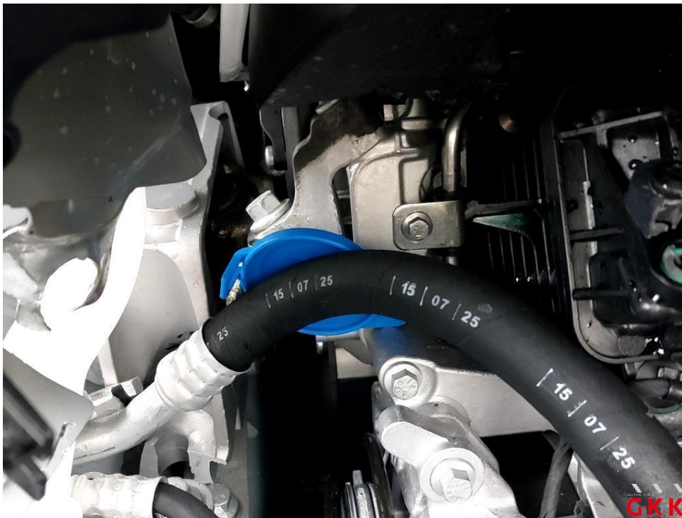
Bild 39 Motorträger vorne rechts verformt
