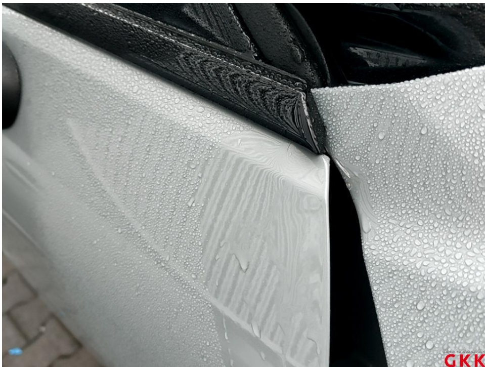
Bild 34 Tür vorne rechts verformt
