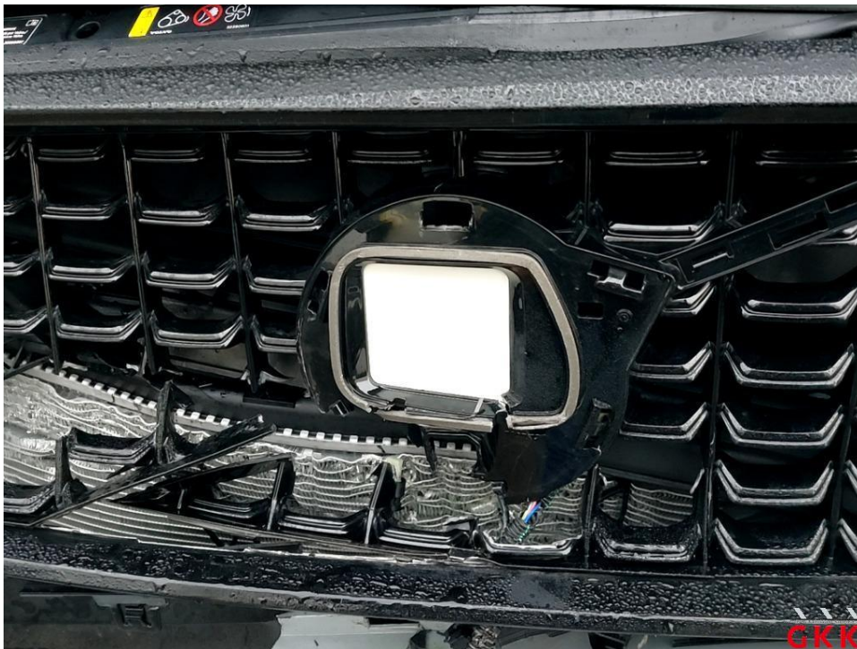
Bild 15 Radarsensor vorne Anstoß
