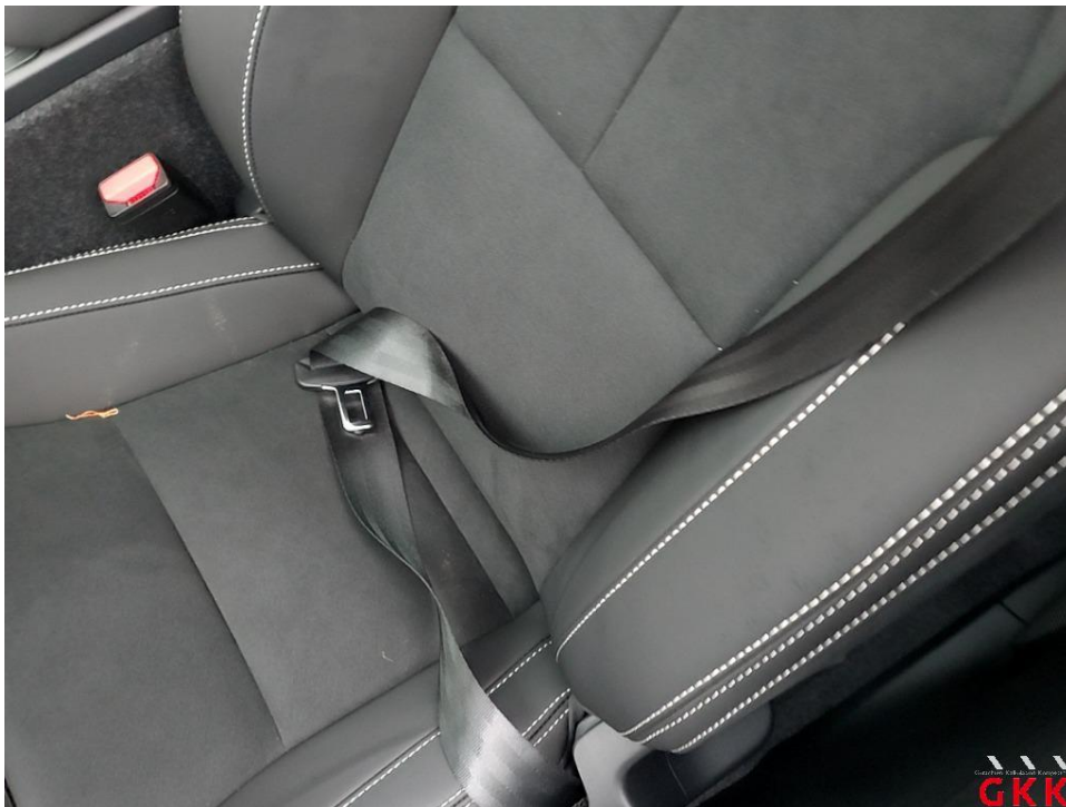
Bild 9 kurzstraffersystem vorne links ausgelöst
