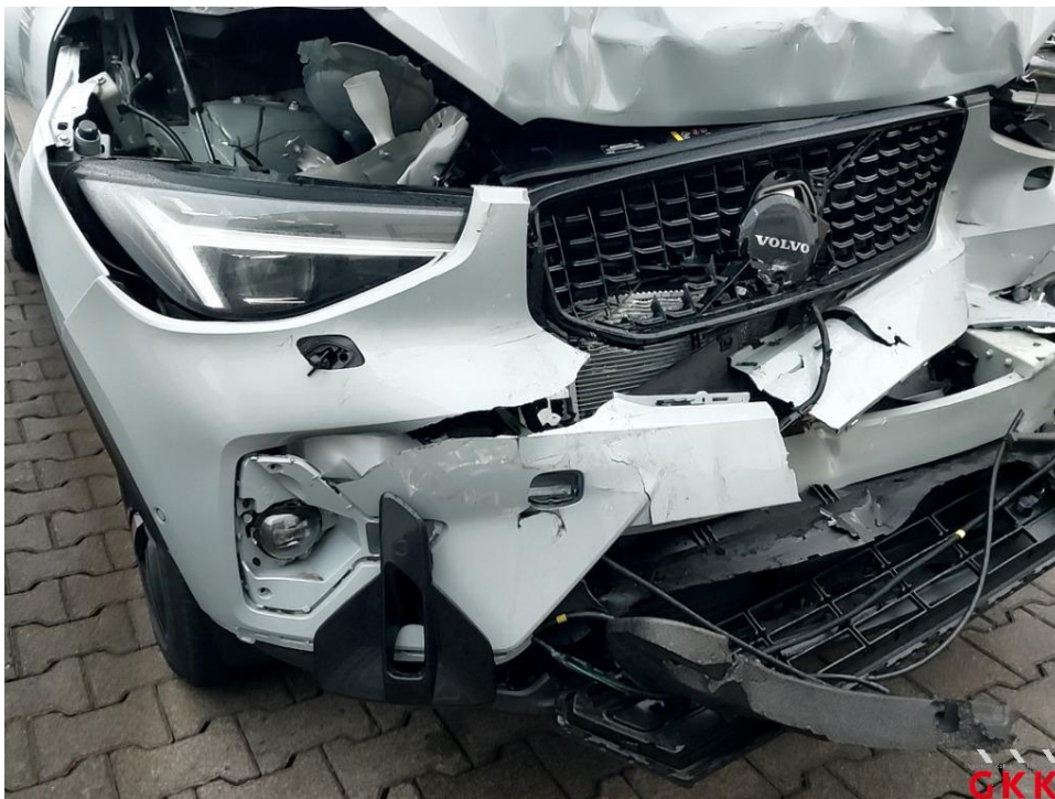
Bild 10 Stoßfänger vorne gebrochen
