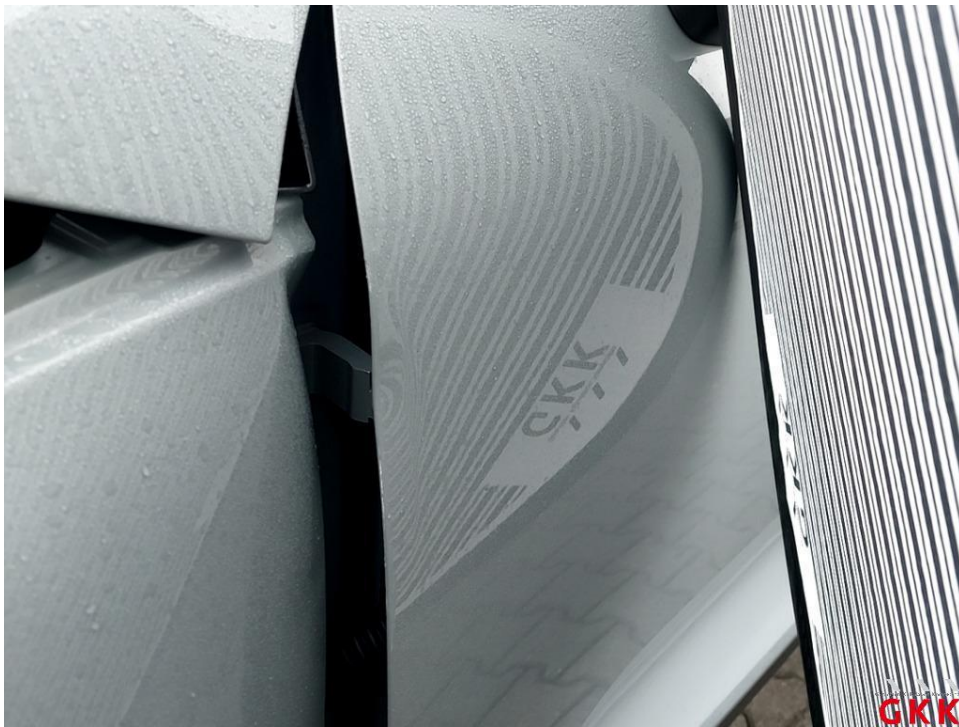
Bild 33 Tür vorne links verformt
