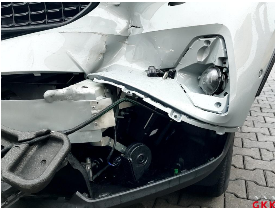
Bild 16 Nebelscheinwerfer vorne links gebrochen
