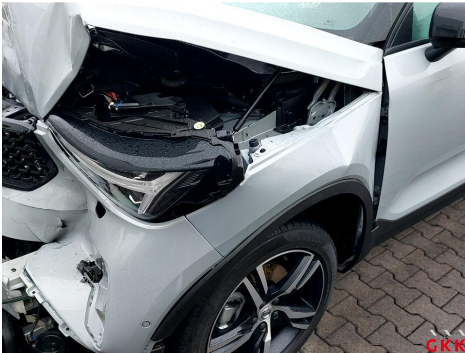
Bild 31 Kotflügel vorne links verformt
