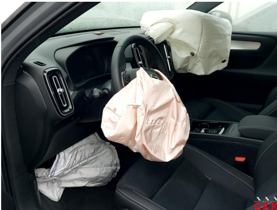
Bild 8 Airbags vorne ausgelöst
