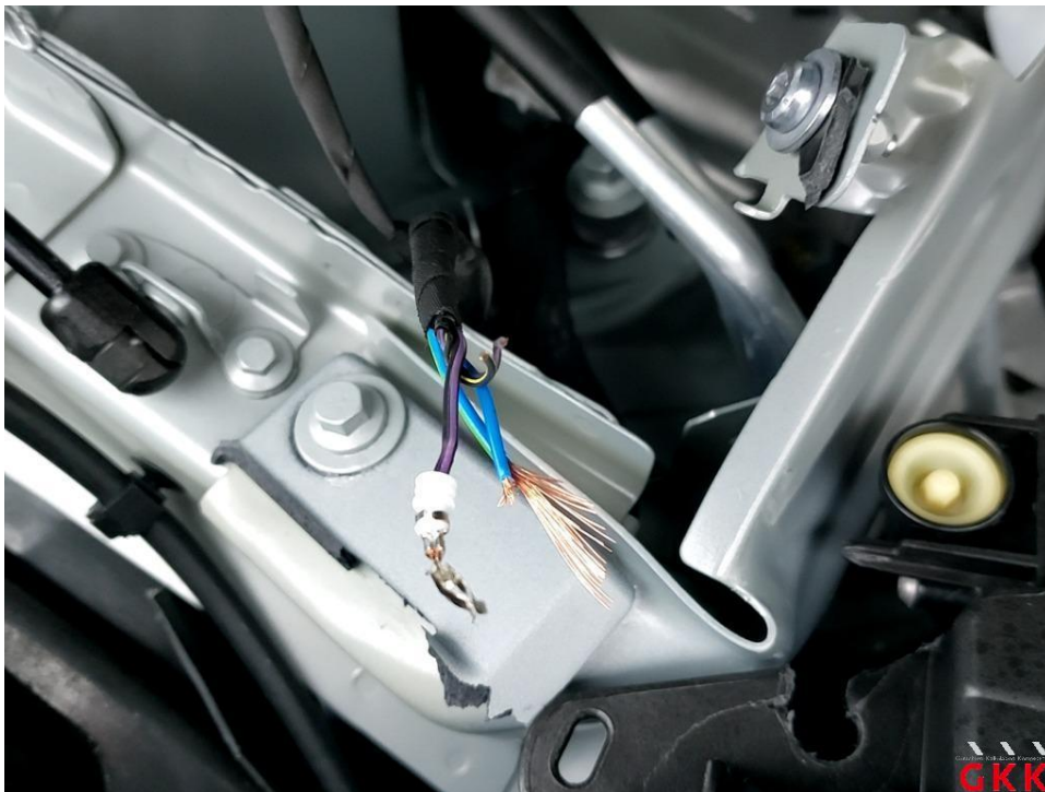
Bild 23 Leitungsstrang Motorraum gebrochen
