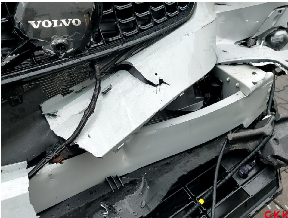
Bild 14 Querträger vorne verformt
