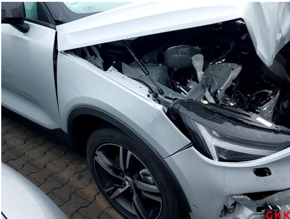
Bild 32 Kotflügel vorne rechts verformt
