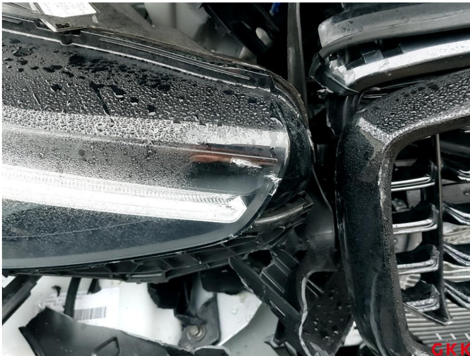
Bild 13 Scheinwerfer vorne rechts gebrochen
