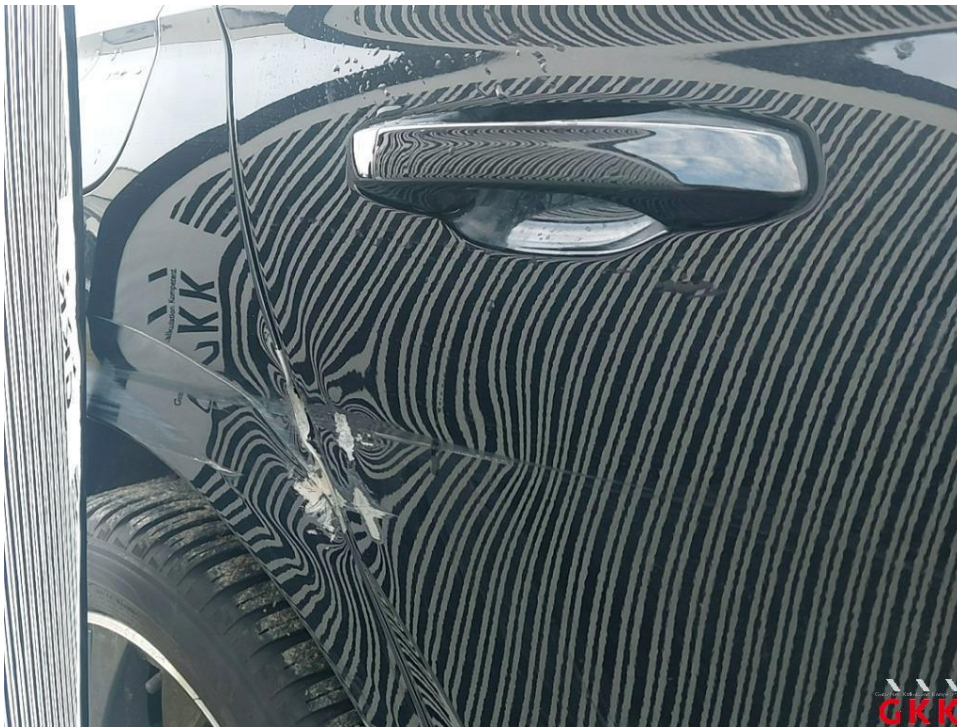
Bild 19 Tür hinten rechts - verformt
