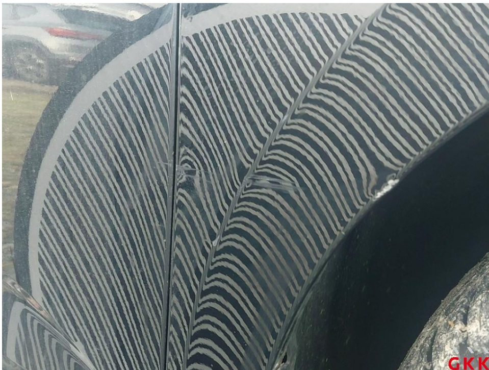
Bild 22 Kotflügel vorn rechts - verformt
