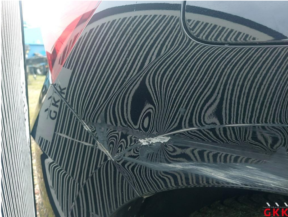
Bild 15 Seitenwand rechts verformt
