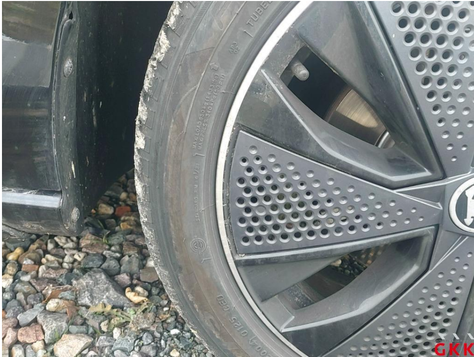
Bild 25 Reifen vorn rechts verschliffen
