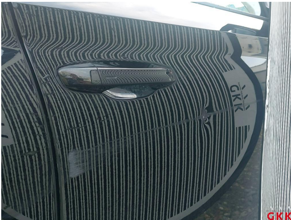
Bild 20 Tür vorn rechts - verformt
