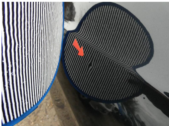
Bild 7: Karosserie / Seitenteil links Delle + Kratzer
