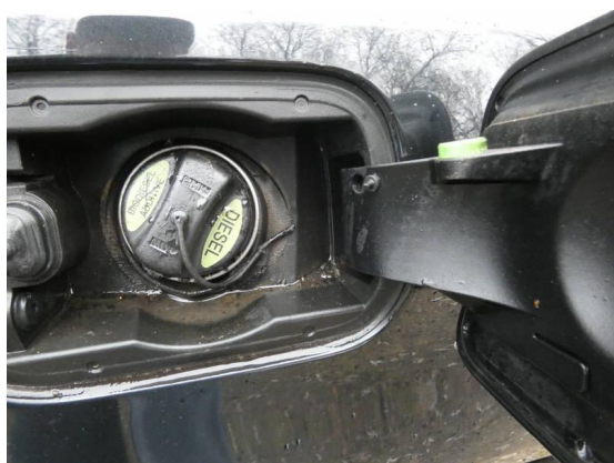
Bild 15: Technik / Takdeckelband gerissen
