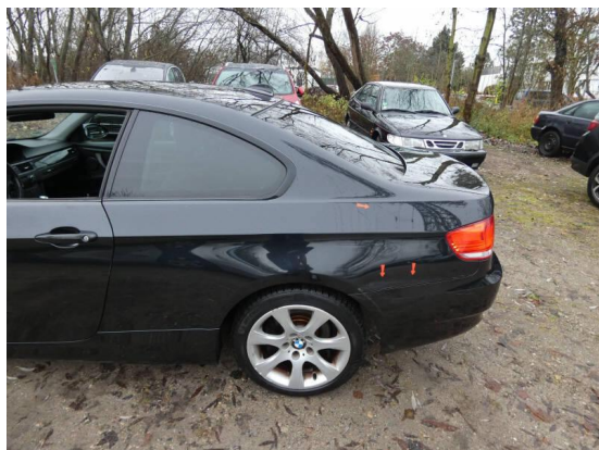
Bild 5: Karosserie / Seitenteil links Delle + Kratzer
