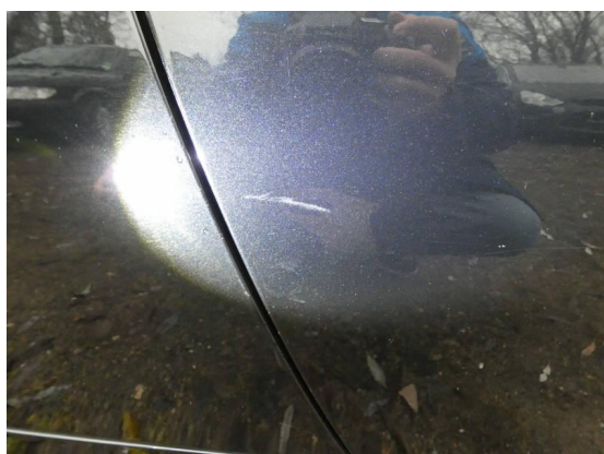
Bild 17: Karosserie / Beifahrertür Kratzer + Delle
