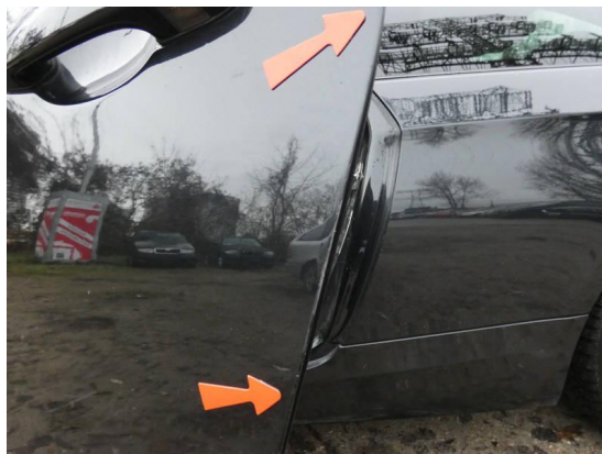
Bild 14: Karosserie / Fahrertür zerkratzt + Delle
