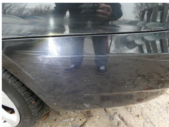
Bild 21: Karosserie / Stoßfänger hinten zerkratzt + Beklebt
