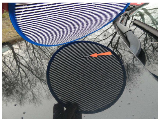
Bild 4: Karosserie / Motorhaube + Dach Hagelschaden
