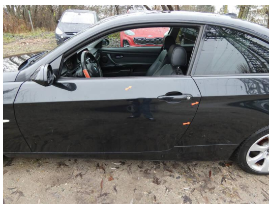
Bild 12: Karosserie / Fahrtür zerkratzt + Delle
