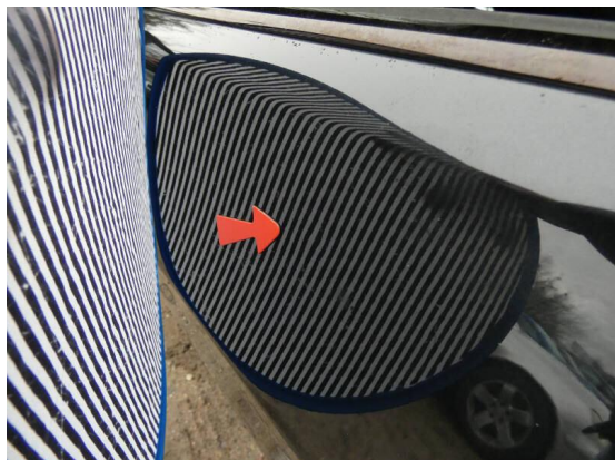
Bild 13: Karosserie / Fahrertür zerkratzt + Delle
