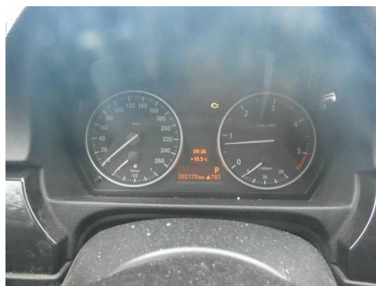
Bild 22: Technik / Motorkontrollleuchte aktiv
