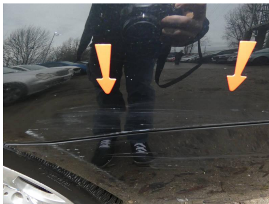
Bild 6: Karosserie / Seitenteil links Delle + Kratzer
