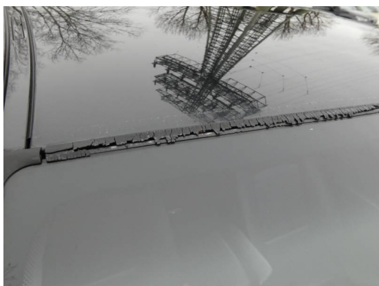
Bild 9: Karosserie / Dichtung Windschutzscheibe porös
