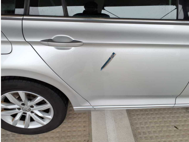
Beschädigung #19: Tür hinten rechts: Tür - Kratzer - instandsetz... und lackieren
