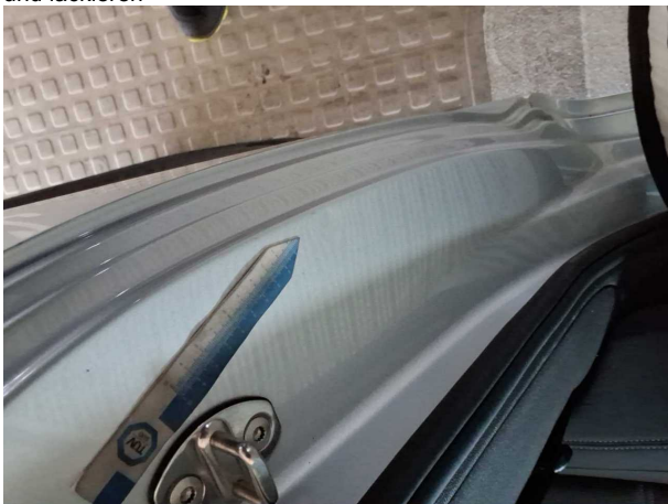
Beschädigung #26: Karosserie: C-Säule links - Delle(n) - sanft instandsetzen
