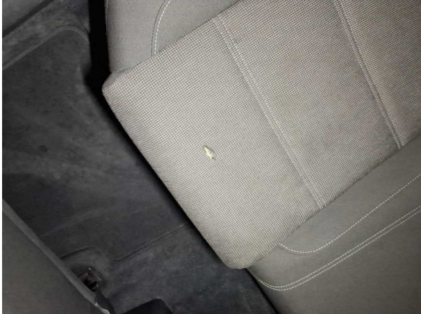
Beschädigung #8: Sitz hinten: Rücksitz - gebrochen / gerissen - instandsetzen
