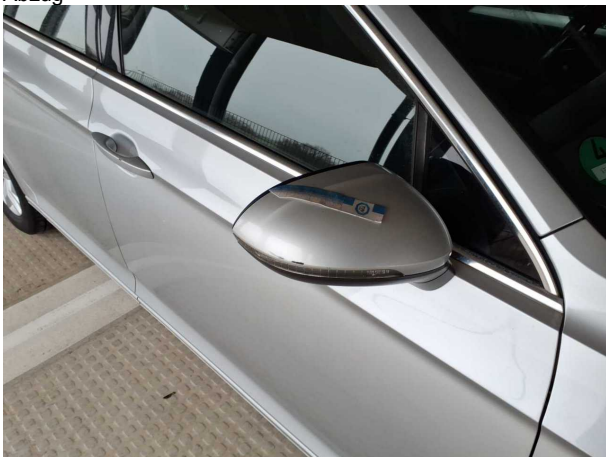
Beschädigung #15: Außenspiegel rechts: Abdeckkappe - verkratzt / verschürft - instandsetzen und lackieren
