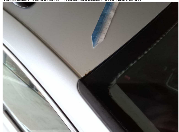
Beschädigung #16: Fahrzeugdach: Dach (Dachkante vorne) - Korrosion - Smart Repair
