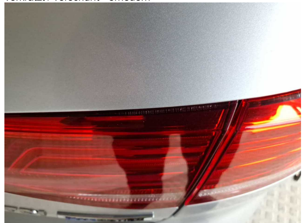
Beschädigung #22: Heckleuchte: Heckleuchte rechts - verkratzt / verschürft - erneuern
