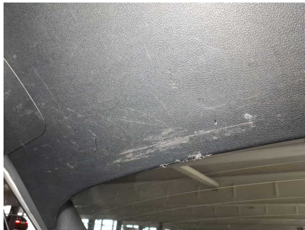
Beschädigung #5: Verkleidungen/Abdeckungen: Kofferraumverkleidung - verkratzt / verschürft - Wertminderung
