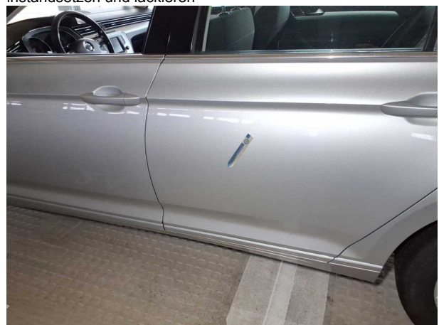
Beschädigung #25: Tür hinten links: Tür - Kratzer - instandsetzen und lackieren
