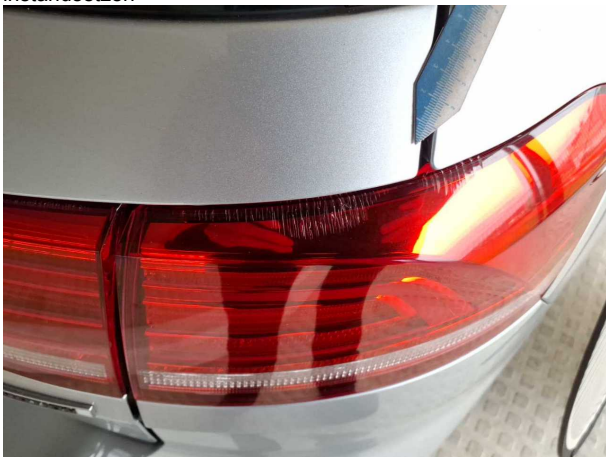
Beschädigung #22: Heckleuchte: Heckleuchte rechts - verkratzt / verschürft - erneuern
