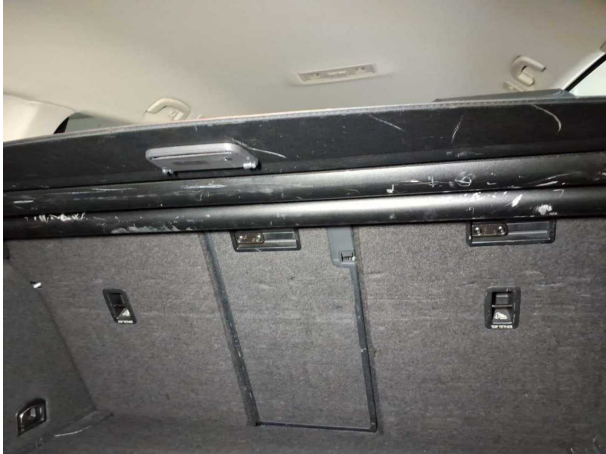
Beschädigung #5: Verkleidungen/Abdeckungen: Kofferraumverkleidung - verkratzt / verschürft - Wertminderung
