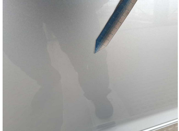
Beschädigung #19: Tür hinten rechts: Tür - Kratzer - instandsetzen und lackieren
