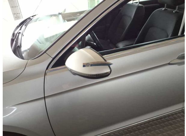
Beschädigung #28: Außenspiegel links: Abdeckkappe - Kratzer - kein Abzug
