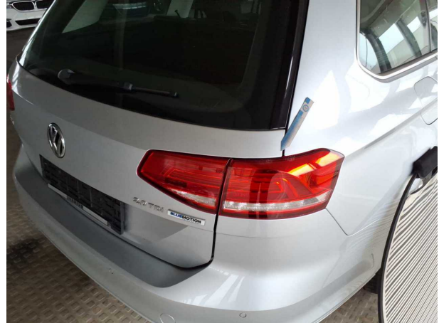
Beschädigung #22: Heckleuchte: Heckleuchte rechts - verkratzt / verschürft - erneuern
