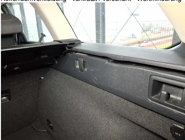
Beschädigung #5: Verkleidungen/Abdeckungen: Kofferraumverkleidung - verkratzt / verschürft - Wertminderung
