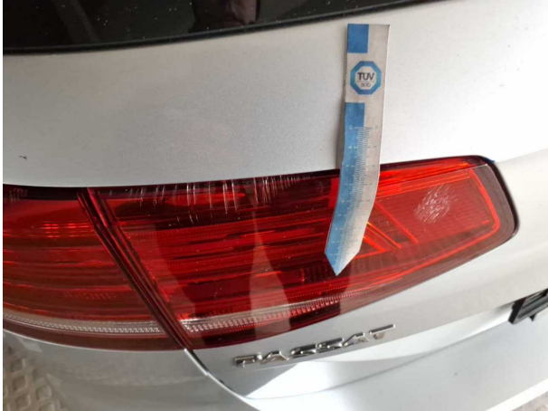
Beschädigung #23: Heckleuchte: Heckleuchte links - verkratzt / verschürft - erneuern
