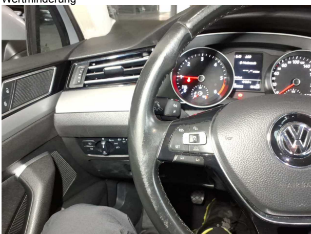
Beschädigung #10: Lenkanlage: Lenkrad - verkratzt / verschürft - Wertminderung
