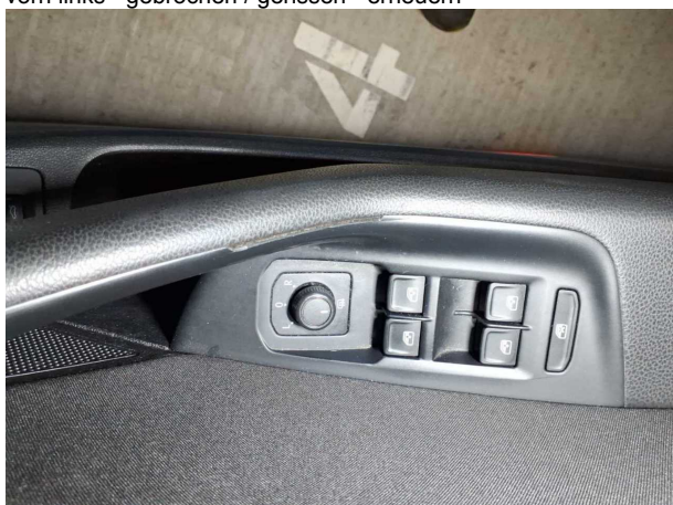
Beschädigung #4: Verkleidungen/Abdeckungen: Türverkleidung vorn links - gebrochen / gerissen - erneuern
