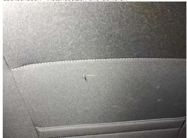
Beschädigung #7: Sitz vorn: Lehnenbezug rechts - porös / rissig - Smart Repair
