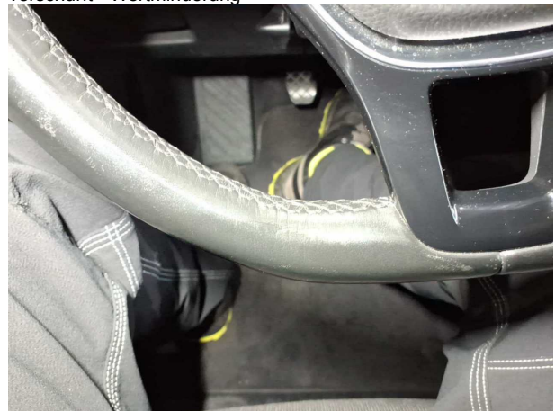
Beschädigung #10: Lenkanlage: Lenkrad - verkratzt / verschürft - Wertminderung
