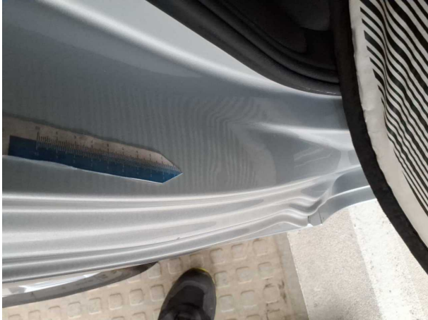
Beschädigung #21: Karosserie: C-Säule rechts - Delle(n) - sanft instandsetzen
