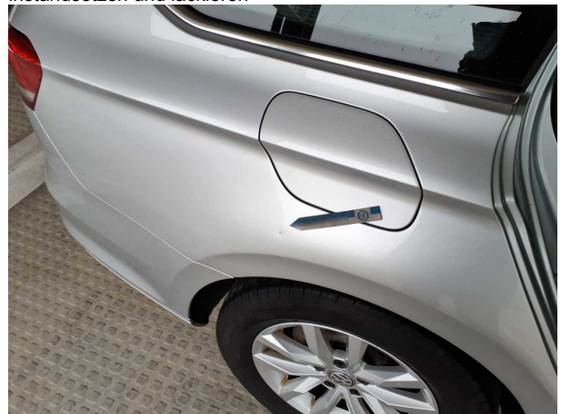
Beschädigung #20: Seitenwand rechts: Seitenwand - Delle / Lackschaden - instandsetzen und lackieren
