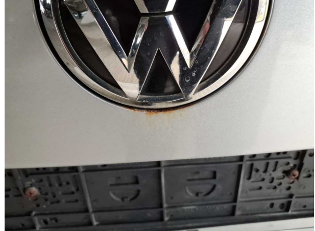
Beschädigung #6: Heckklappe/-tür: Heckklappe - Delle / Lackschaden - instandsetzen und lackieren
