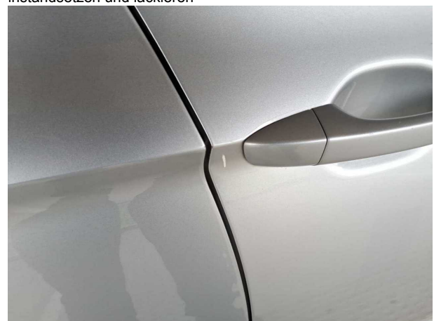
Beschädigung #18: Tür vorn rechts: Tür - Kratzer - instandsetzen und lackieren
