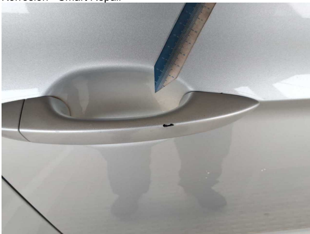
Beschädigung #17: Tür vorn rechts: Griff außen - Kratzer - instandsetzen und lackieren
