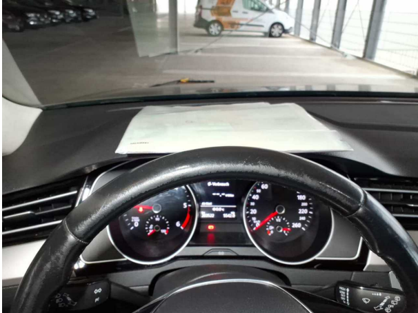
Beschädigung #10: Lenkanlage: Lenkrad - verkratzt / verschürft - Wertminderung
