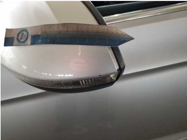
Beschädigung #28: Außenspiegel links: Abdeckkappe - Kratzer - kein Abzug
