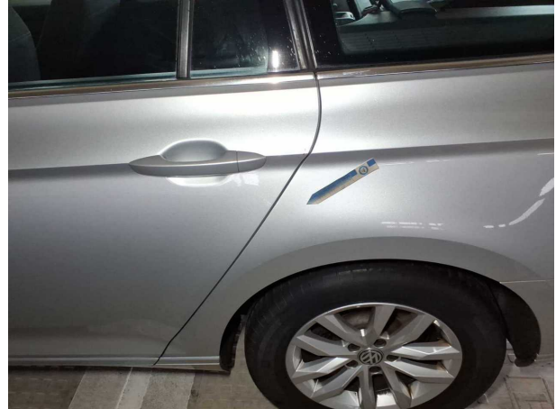
Beschädigung #24: Seitenwand links: Seitenwand - Kratzer - instandsetzen und lackieren
