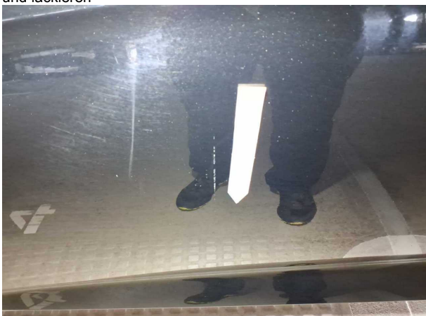
Beschädigung #16: Tür vorn links: Tür - verkratzt / verschürft - instandsetzen und lackieren
