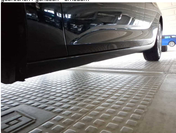
Beschädigung #5: Schweller links: Schweller - Delle(n) - instandsetzen
