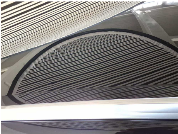
Beschädigung #1: Fahrzeugdach: Dach - Delle(n) - sanft instandsetzen
