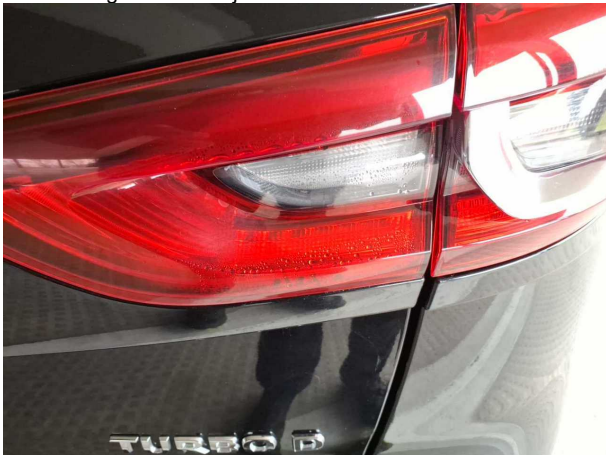
Beschädigung #14: Heckleuchte: Heckleuchte rechts - undicht - erneuern
