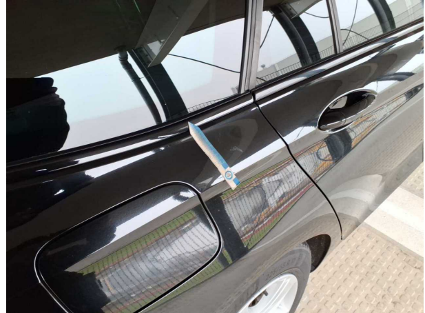
Beschädigung #12: Seitenwand rechts: Seitenwand (Harzreste) - Lackmangel - entfernen
