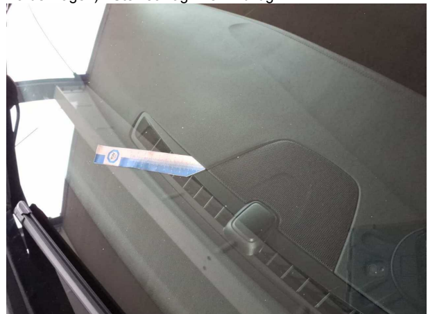
Beschädigung #8: Verglasung: Frontscheibe - Steinschlag - kein Abzug
