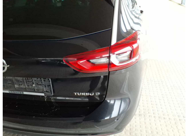
Beschädigung #14: Heckleuchte: Heckleuchte rechts - undic... - erneuern
