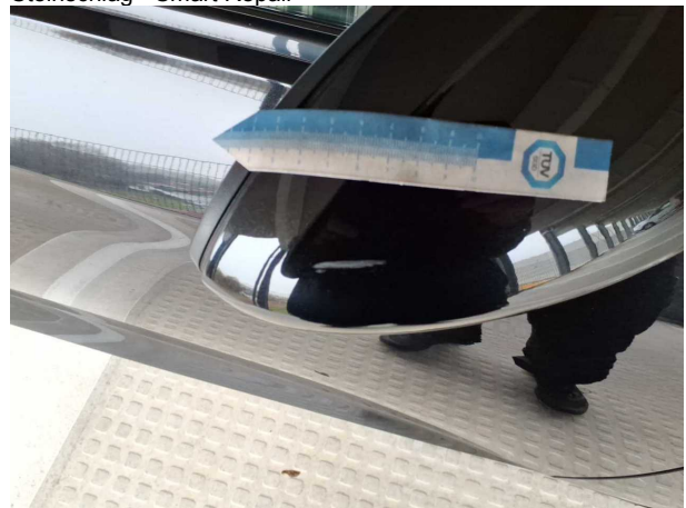
Beschädigung #10: Außenspiegel rechts: Abdeckkappe - Kratzer - instandsetzen und lackieren
