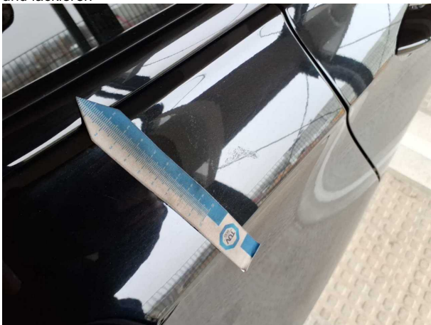
Beschädigung #12: Seitenwand rechts: Seitenwand (Harzreste) - Lackmangel - entfernen
