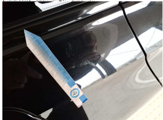
Beschädigung #12: Seitenwand rechts: Seitenwand (Harzreste) - Lackmangel - entfernen
