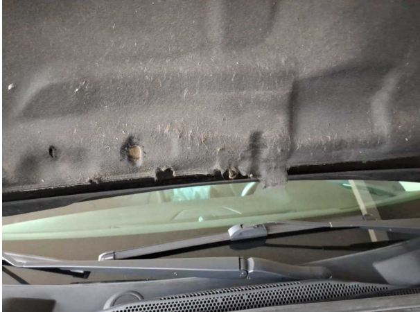
Beschädigung #2: Motorhaube: Dämmmatte - Marderschaden - erneuern
