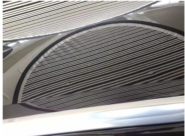
Beschädigung #1: Fahrzeugdach: Dach - Delle(n) - sanft instandsetzen
