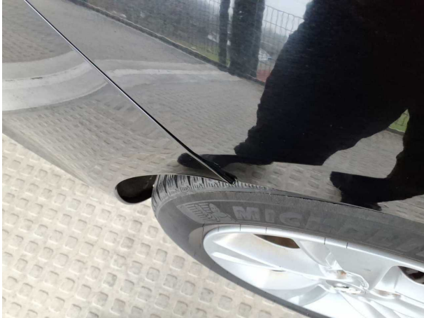
Beschädigung #13: Stossfänger hinten: Stossfänger hinten - Fehlstellung - einstellen/justieren
