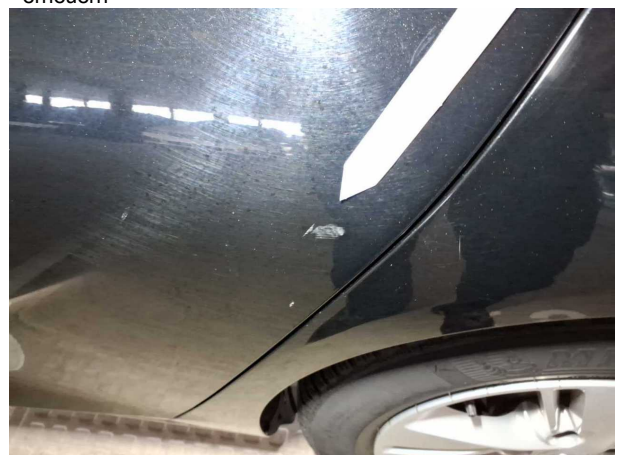
Beschädigung #15: Tür hinten links: Tür - Kratzer - instandsetzen und lackieren
