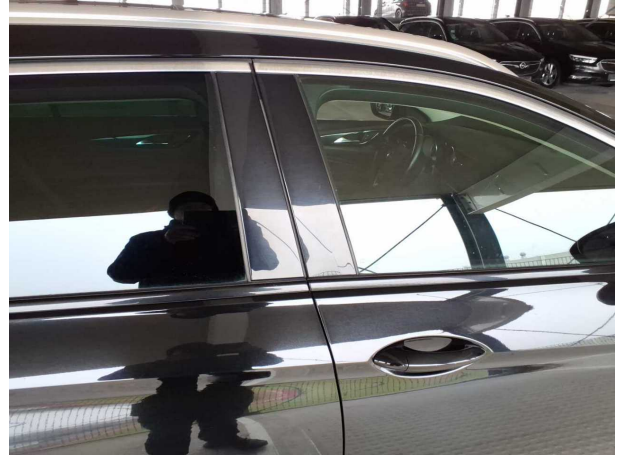
Beschädigung #4: Tür vorn rechts: Fensterführung (Blende) - gebrochen / gerissen - erneuern
