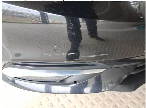
Beschädigung #16: Stossfänger vorn: Stossfänger vorn - verkratzt / verschürft - instandsetzen und lackieren
