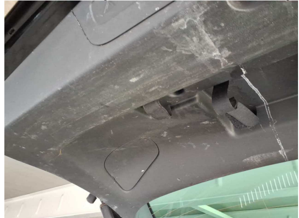
Beschädigung #1: Verkleidungen/Abdeckungen: Kofferraumverkleidung - verkratzt / verschürft - Wertminderung
