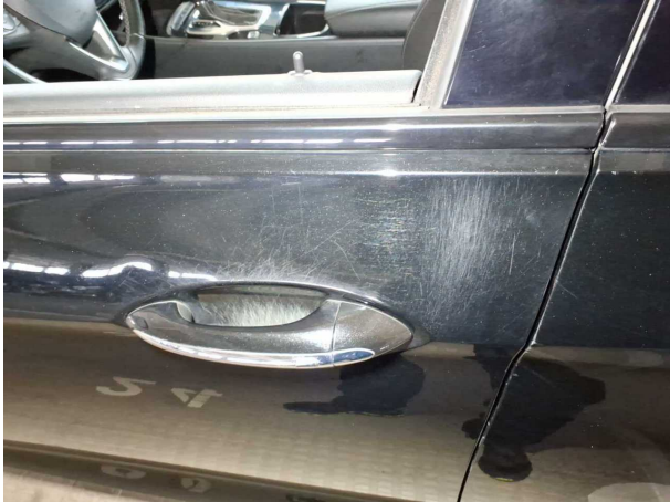
Beschädigung #29: Tür vorn links: Tür - verkratzt / verschürft - instandsetzen und lackieren
