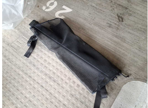
Beschädigung #9: Interieur: Trennnetz - gebrochen / gerissen - erneuern
