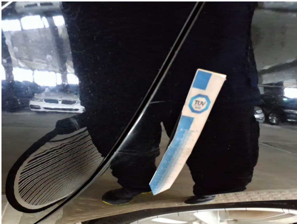
Beschädigung #27: Seitenwand links: Seitenwand - Delle / Lackschaden - instandsetzen und lackieren
