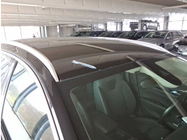
Beschädigung #17: Fahrzeugdach: Dach (Dachkante vorne) - Steinschlag - Smart Repair
