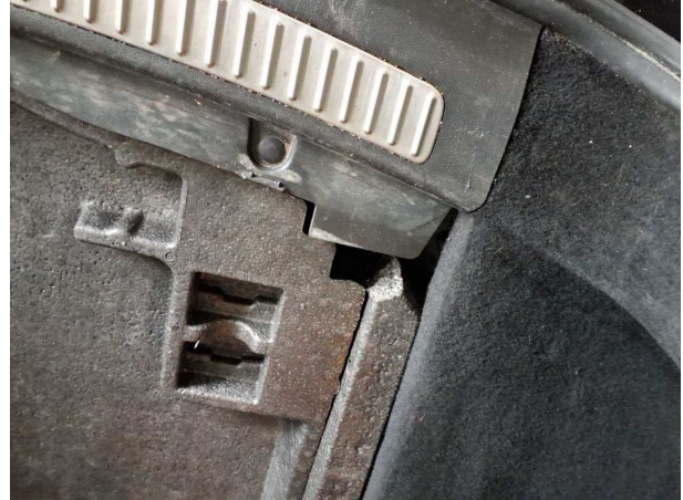
Beschädigung #1: Verkleidungen/Abdeckungen: Kofferraumverkleidung - verkratzt / verschürft - Wertminderung
