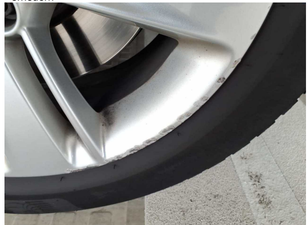
Beschädigung #10: Rad/Reifen: Leichtmetallfelge vorn rechts - verkratzt / verschürft - Smart Repair
