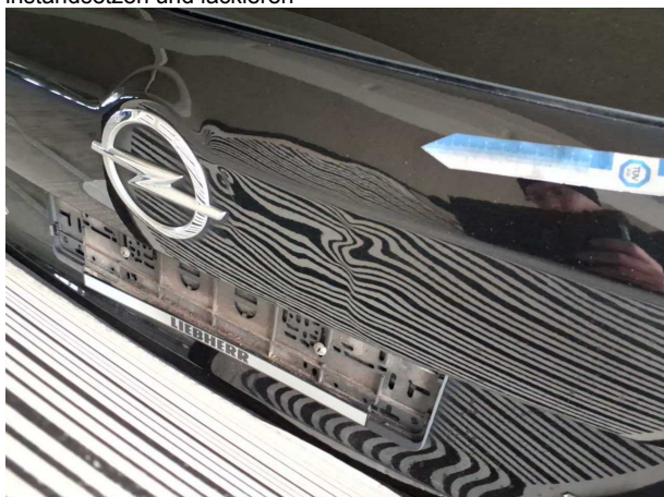
Beschädigung #26: Heckklappe/-tür: Heckklappe - verformt - instandsetzen und lackieren
