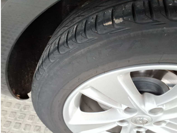
Beschädigung #6: Rad/Reifen: Reifen hinten (Unterschiedliche Hersteller) - Funktion / Zulässigkeit - erneuern
