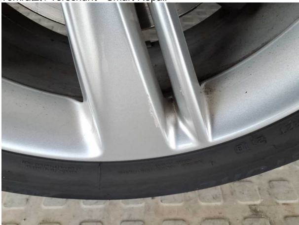
Beschädigung #11: Rad/Reifen: Leichtmetallfelge hinten rechts - Kratzer - Smart Repair
