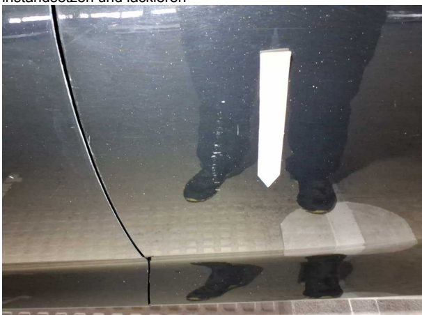
Beschädigung #30: Tür hinten links: Tür - verkratzt / verschürft - instandsetzen und lackieren
