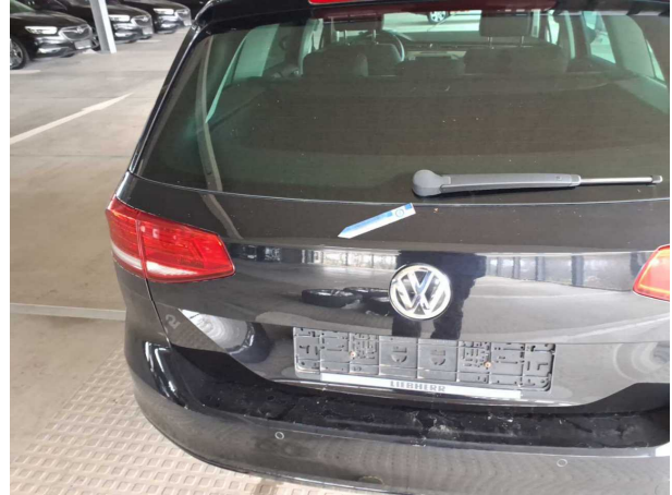
Beschädigung #11: Heckklappe/-tür: Heckklappe - Kratzer - auslegen / polieren
