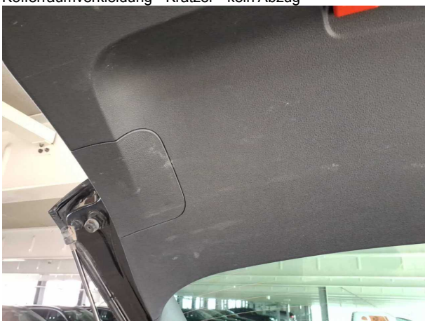
Beschädigung #1: Verkleidungen/Abdeckungen: Kofferraumverkleidung - Kratzer - kein Abzug
