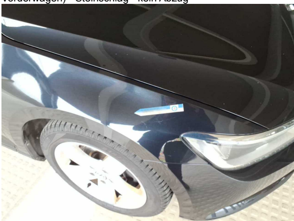
Beschädigung #8: Kotflügel rechts: Kotflügel rechts - Kratzer - instandsetzen und lackieren
