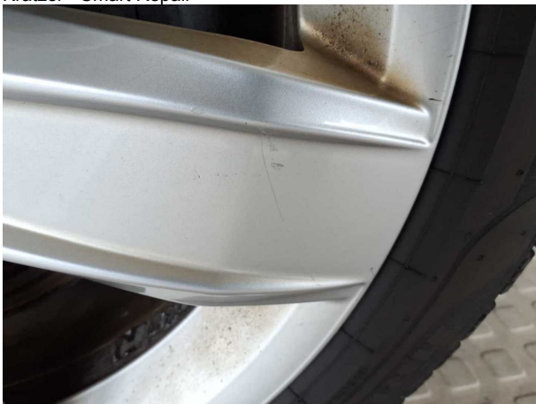
Beschädigung #5: Rad/Reifen: Leichtmetallfelge vorn rechts - Kratzer - Smart Repair
