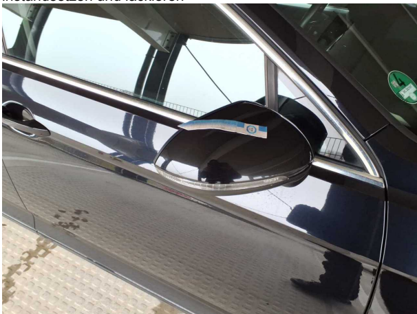
Beschädigung #9: Außenspiegel rechts: Abdeckkappe - Kratzer - kein Abzug
