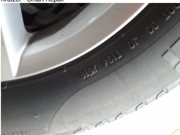
Beschädigung #6: 2.Radsatz: 2 Reifen (Reifenalter) - Funktion / Zulässigkeit - erneuern
