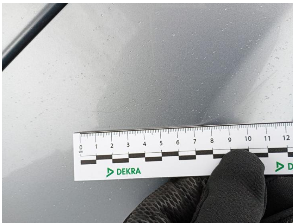
Fot. 41. Drzwi przednie P - Rysa/odprysk 1
