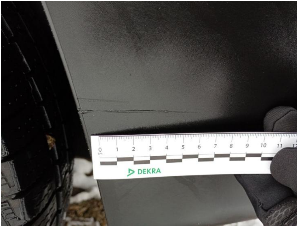
Fot. 45. Zderzak tylny cz L - Rysa/odprysk 1
