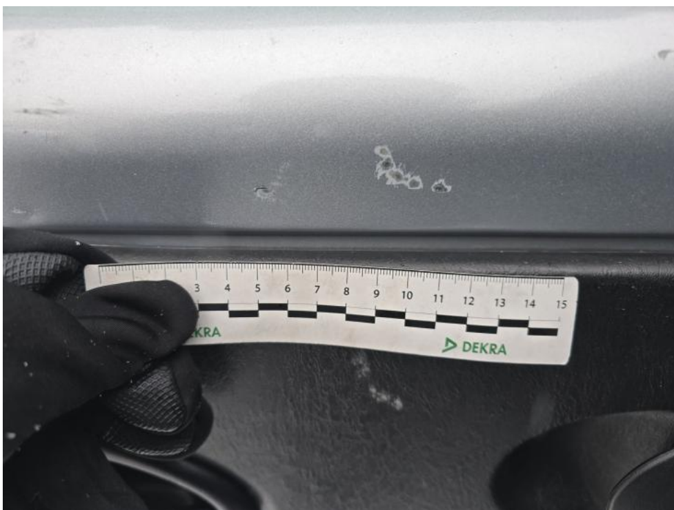
Fot. 48. Drzwi tyłu lewe - Rysa/odprysk 1
