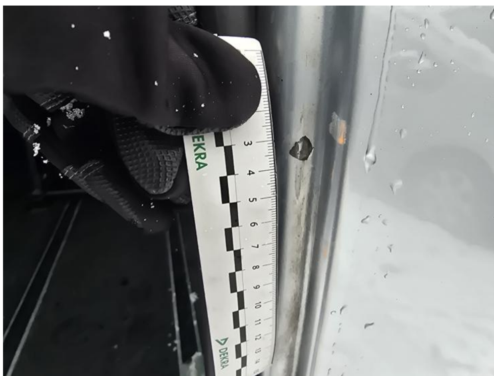
Fot. 52. Drzwi tyłu prawe - Rysa/odprysk 2
