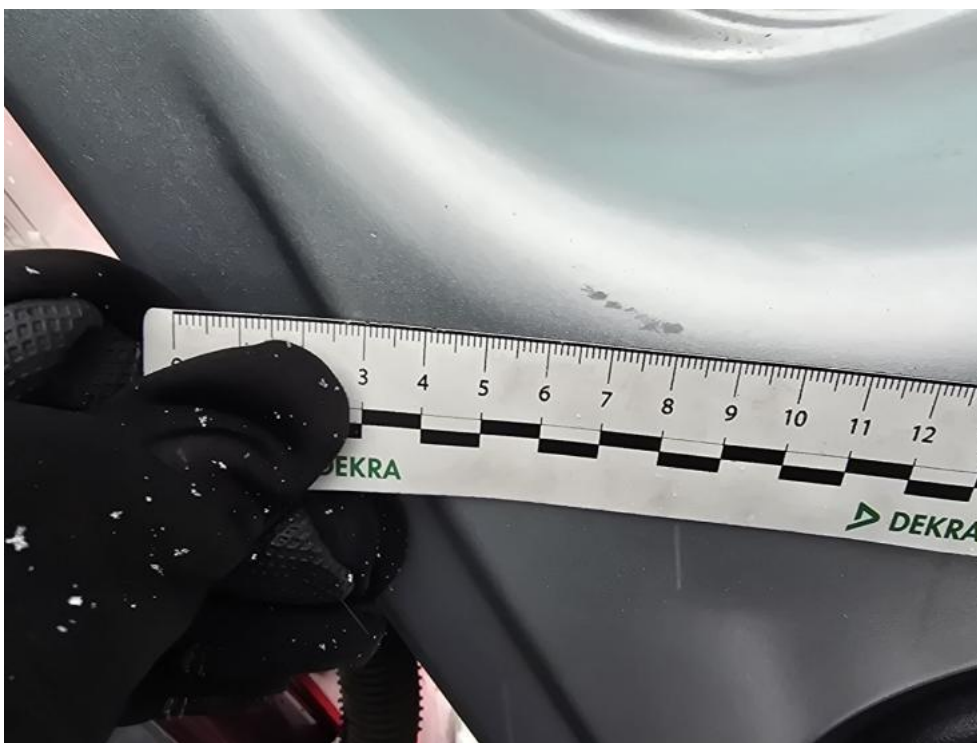
Fot. 53. Drzwi tyłu prawe() - Rysa/odprysk 3
