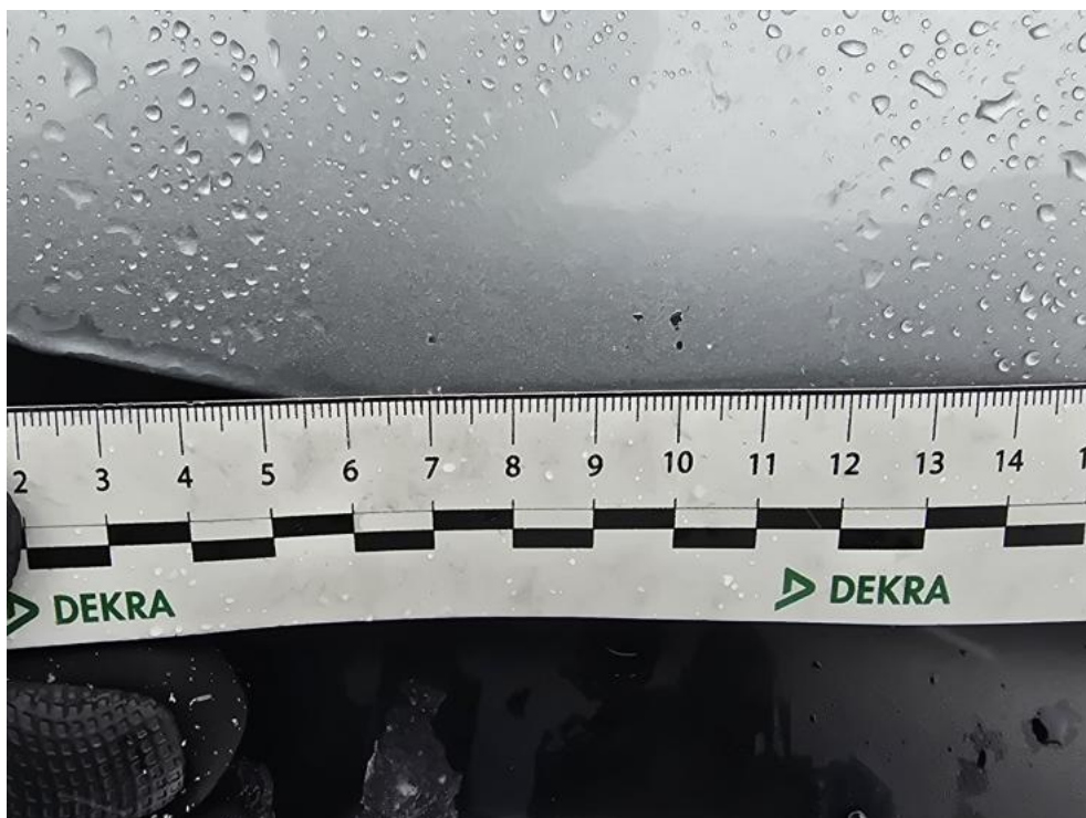
Fot. 36. Pokrywa komory silnika - Rysa/odprysk 1
