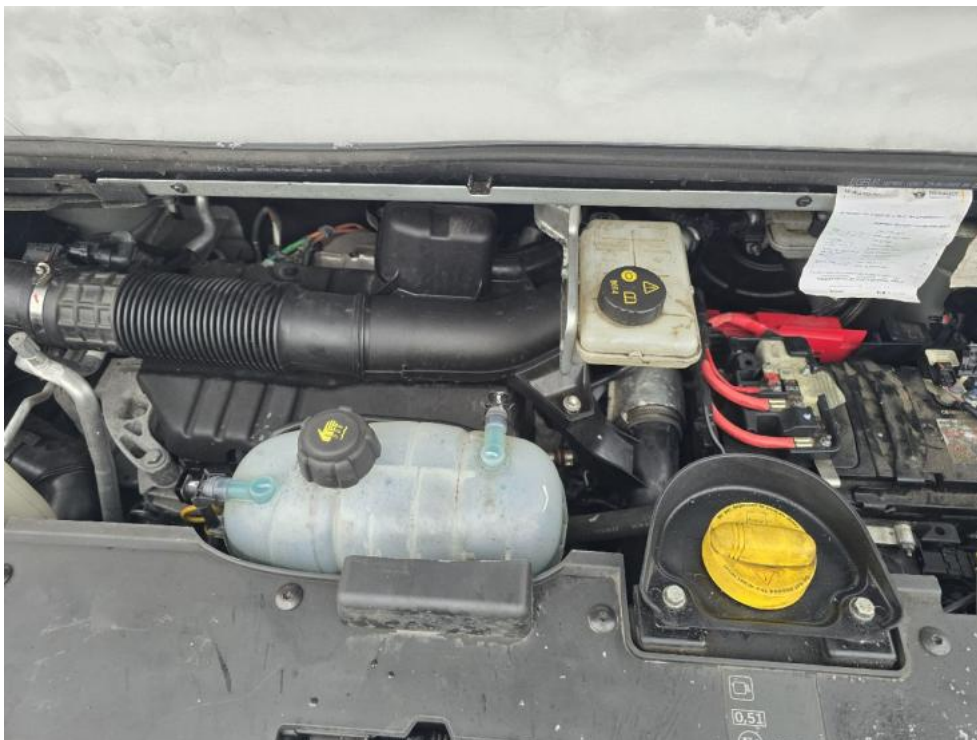
Fot. 23. Komora silnika
