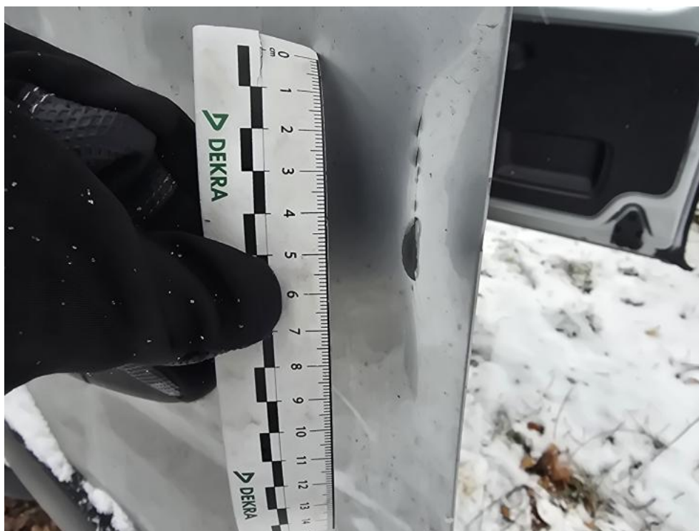
Fot. 47. Drzwi tyłu lewe - Wgniecenie/odkształcenie 1
