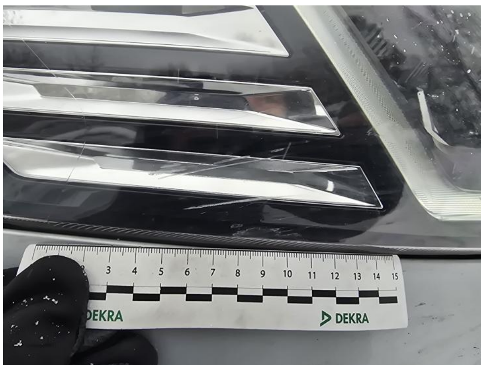
Fot. 38. Reflektor P - Rysa/odprysk 1
