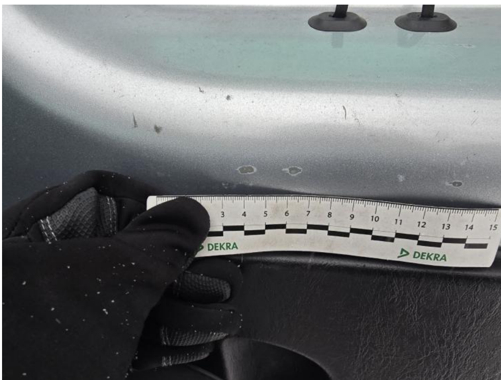
Fot. 52. Drzwi tyłu prawe() - Rysa/odprysk 3
