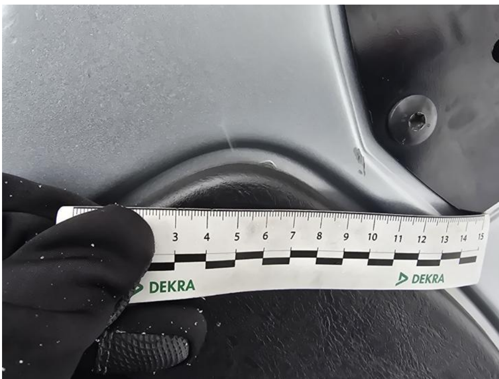
Fot. 51. Drzwi tyłu prawe - Rysa/odprysk 2
