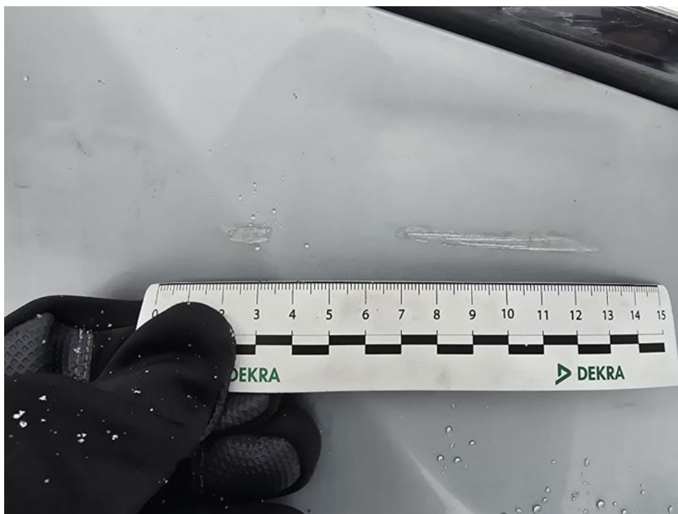
Fot. 37. Zderzak() - Rysa/odprysk 3
