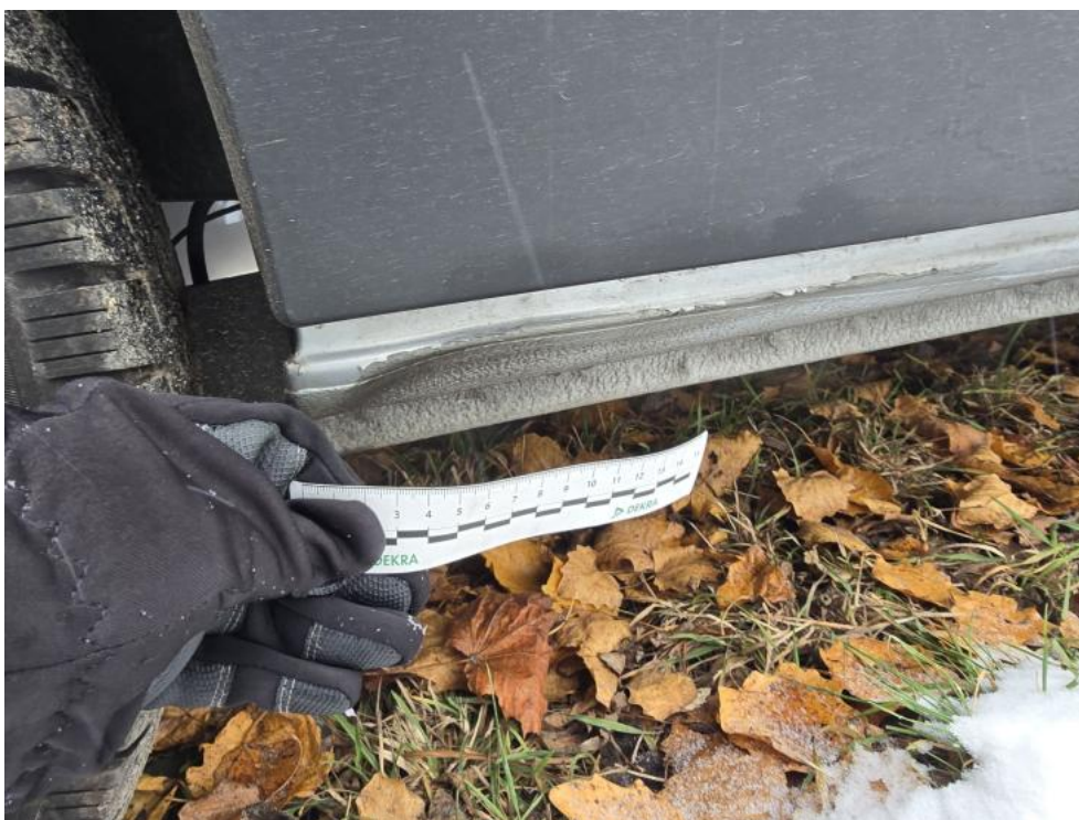
Fot. 39. Próg P - Wgniecenie/odkształcenie 1
