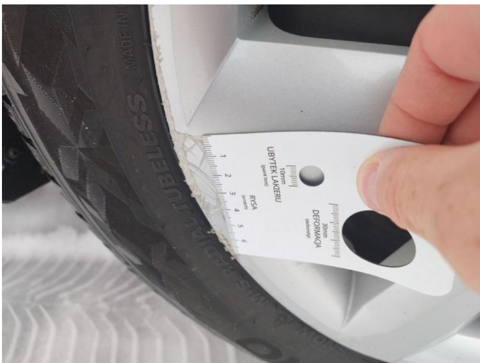
Fot. 43. Kołpak przedni P - Rysa/odprysk 1
