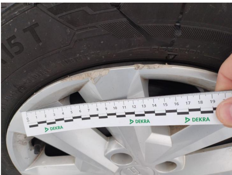
Fot. 42. Kołpak przedni P - Rysa/odprysk 1
