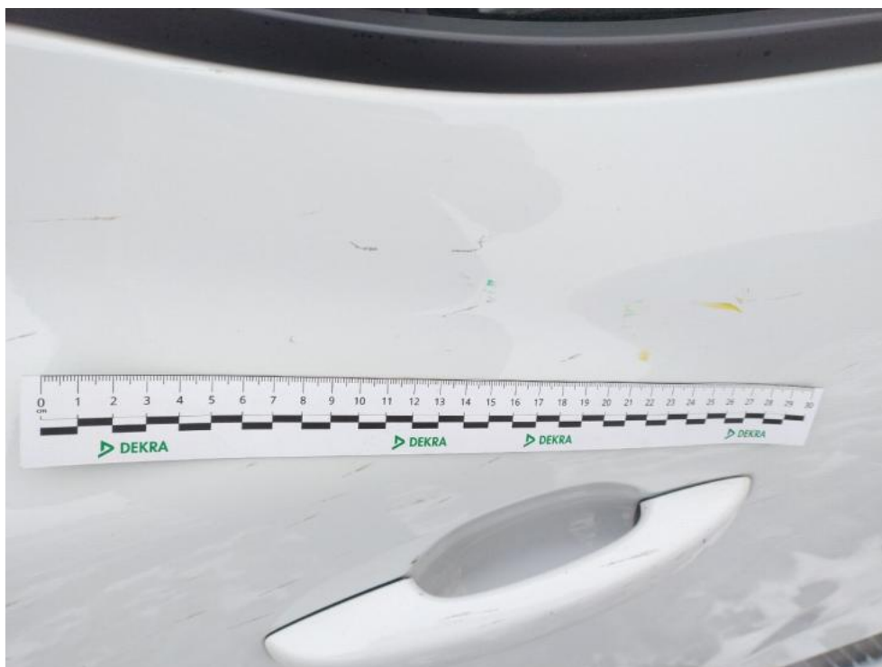
Fot. 45. Drzwi tylne P() - Rysa/odprysk 3
