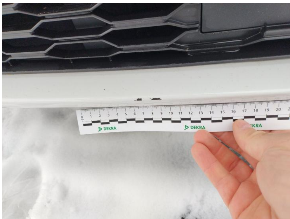
Fot. 40. Zderzak - Rysa/odprysk 1
