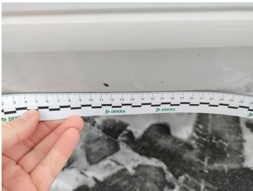
Fot. 55. Zderzak tylny - Rysa/odprysk 1
