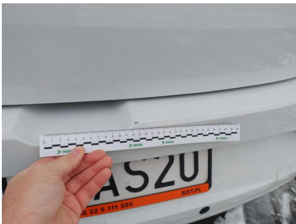
Fot. 56. Zderzak tylny - Rysa/odprysk 2
