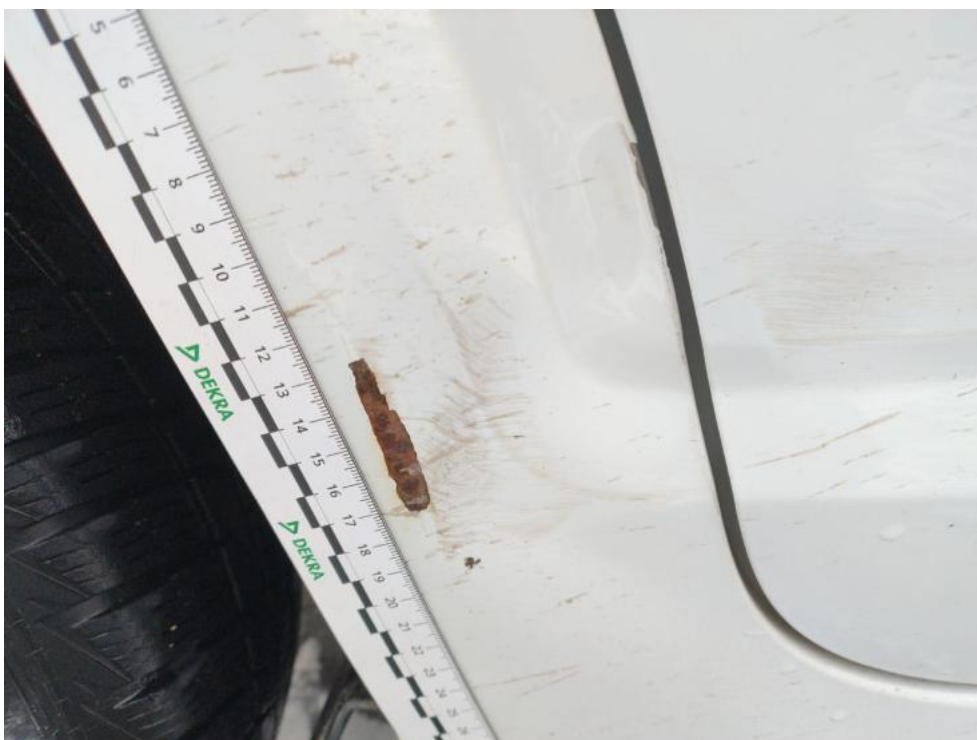
Fot. 49. Błotnik tylny P / Ściana boczna P - Wgniecenie/odkształcenie 1
