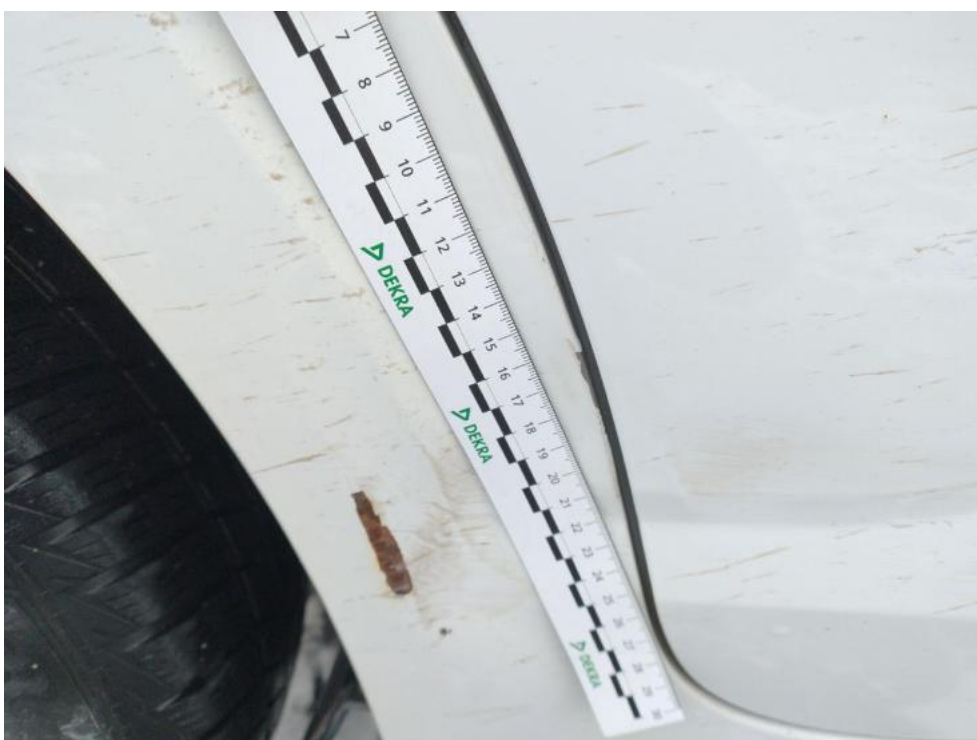
Fot. 50. Błotnik tylny P / Ściana boczna P - Wgniecenie/odkształcenie 2
