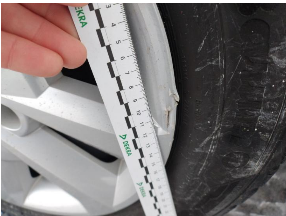
Fot. 52. Kołpak tylny P - Wgniecenie/odkształcenie 1
