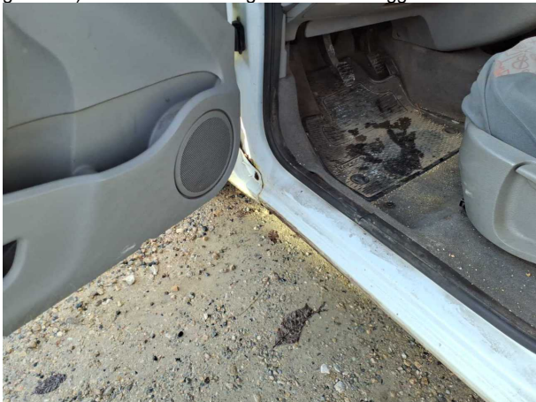
Beschädigung #13: Schweller links: Einstieg (Rostbildung) - Lackmangel - instandsetzen und lackieren
