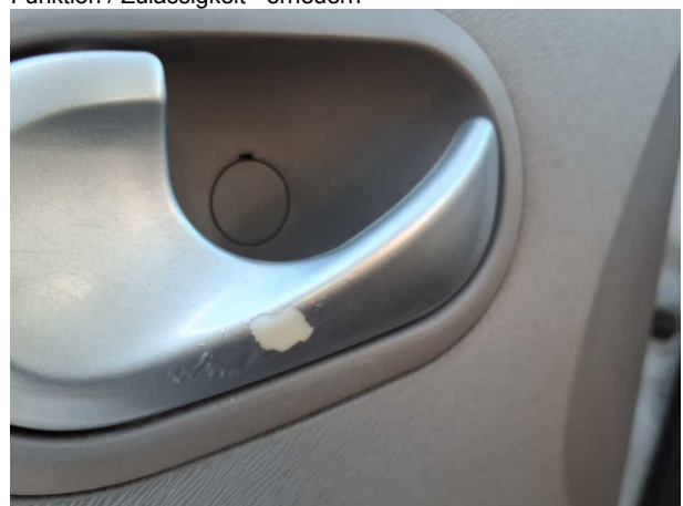
Beschädigung #16: Tür vorn links: Griff innen - Lackmangel - erneuern
