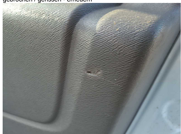
Beschädigung #8: Verkleidungen/Abdeckungen: Türverkleidung vorn rechts - Kratzer - Wertminderung
