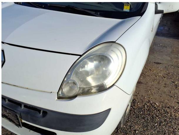
Beschädigung #1: Scheinwerfer: Scheinwerfer links (Trüb) - Funktion / Zulässigkeit - erneuern
