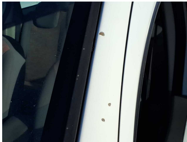
Beschädigung #23: Karosserie: A-Säule links - Steinschlag - Smart Repair
