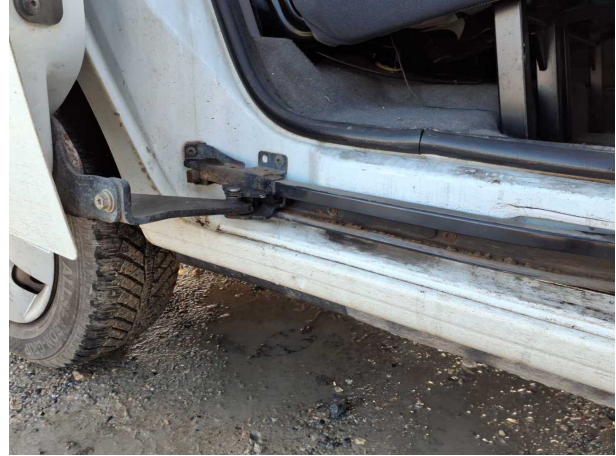
Beschädigung #9: Tür hinten rechts: Scharnier Satz (Trocken gelaufen) - Funktion / Zulässigkeit - befunden ggf.
