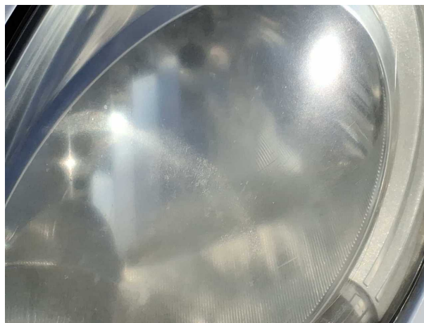
Beschädigung #1: Scheinwerfer: Scheinwerfer links (Trüb) - Funktion / Zulässigkeit - erneuern
