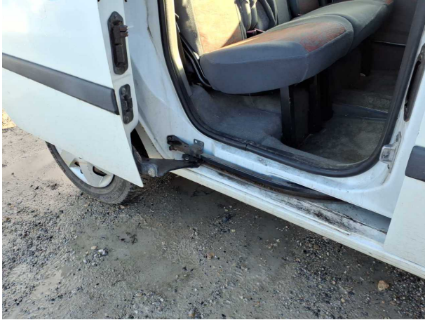
Beschädigung #9: Tür hinten rechts: Scharnier Satz (Trocken gelaufen) - Funktion / Zulässigkeit - befunden ggf. instandsetzen
