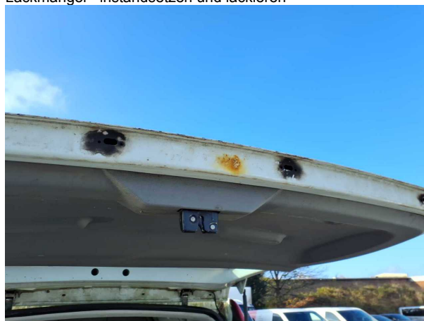
Beschädigung #21: Heckklappe/-tür: Heckklappe - Lackmangel - instandsetzen und lackieren
