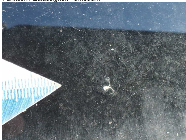
Beschädigung #2: Verglasung: Frontscheibe (Mit Rißbildung... Steinschlag - erneuern
