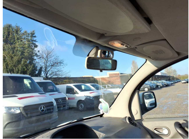
Beschädigung #15: Instrumententafel: Innenspiegel - Funktion / Zulässigkeit - erneuern
