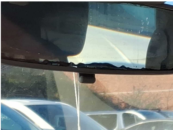
Beschädigung #15: Instrumententafel: Innenspiegel - Funktion / Zulässigkeit - erneuern
