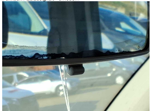
Beschädigung #15: Instrumententafel: Innenspiegel - Funktion / Zulässigkeit - erneuern
