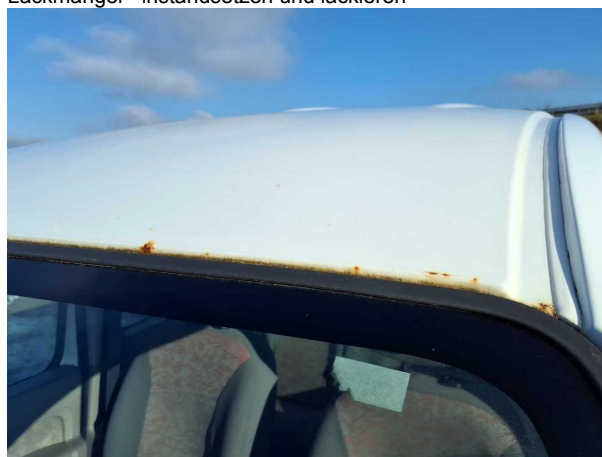
Beschädigung #22: Fahrzeugdach: Dach (Steinschlag mit Rostbildung) - Lackmangel - instandsetzen und lackieren
