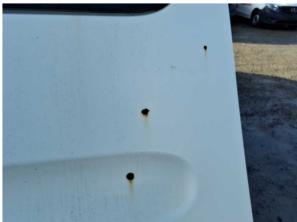
Beschädigung #21: Heckklappe/-tür: Heckklappe - Lackmangel - instandsetzen und lackieren
