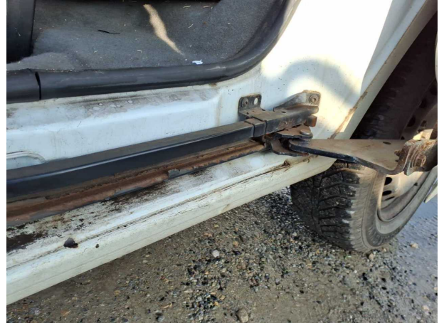
Beschädigung #12: Tür hinten links: Scharnier unten (Trocken gelaufen) - Funktion / Zulässigkeit - befunden ggf.
