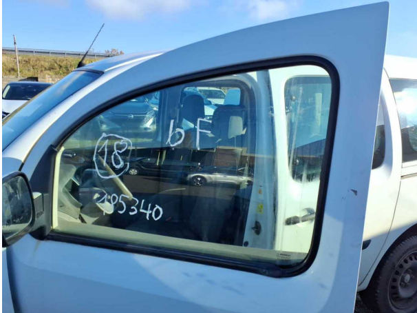
Beschädigung #17: Verglasung: Türscheibe vorn links - Kratzer - erneuern
