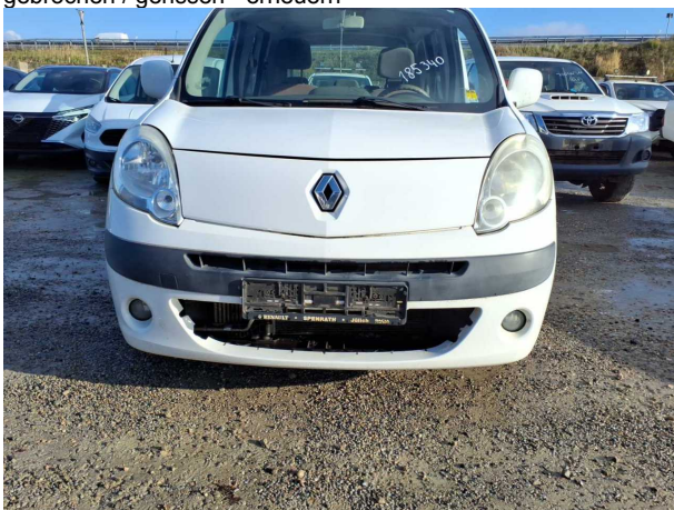
Beschädigung #4: Stossfänger vorn: Grill - fehlt - erneuern
