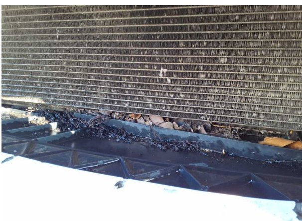
Beschädigung #4: Stossfänger vorn: Grill - fehlt - erneuern
