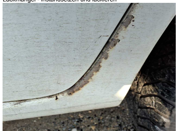
Beschädigung #11: Seitenwand links: Seitenwand - Lackmangel - instandsetzen und lackieren
