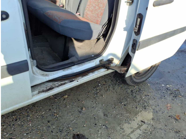
Beschädigung #12: Tür hinten links: Scharnier unten (Trocken gelaufen) - Funktion / Zulässigkeit - befunden ggf. instandsetzen
