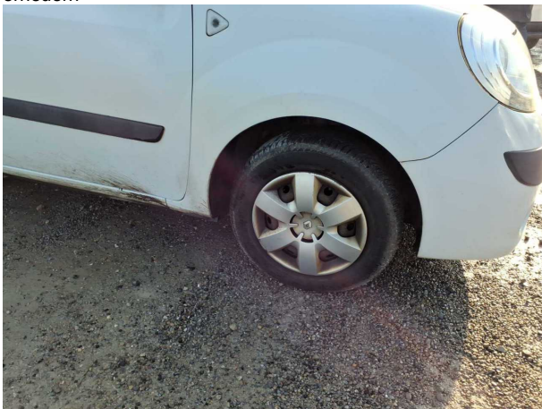
Beschädigung #7: Rad/Reifen: Radblende vorn rechts - gebrochen / gerissen - erneuern
