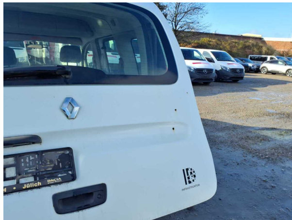
Beschädigung #21: Heckklappe/-tür: Heckklappe - Lackmangel - instandsetzen und lackieren
