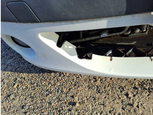
Beschädigung #3: Stossfänger vorn: Stossfänger vorn - gebrochen / gerissen - erneuern
