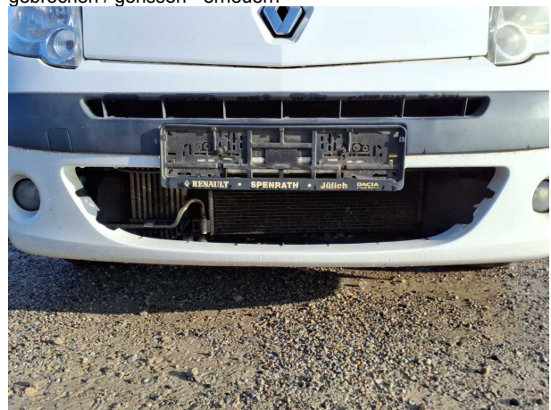
Beschädigung #4: Stossfänger vorn: Grill - fehlt - erneuern
