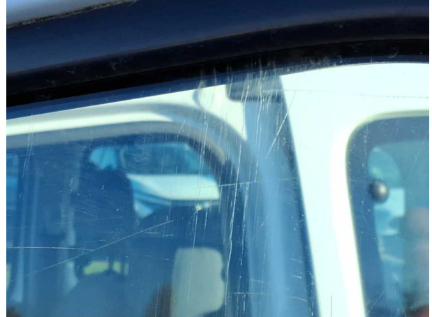
Beschädigung #17: Verglasung: Türscheibe vorn links - Kratzer - erneuern
