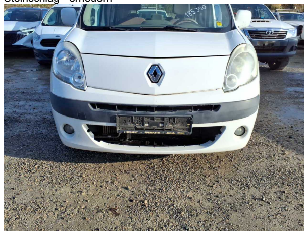
Beschädigung #3: Stossfänger vorn: Stossfänger vorn - gebrochen / gerissen - erneuern
