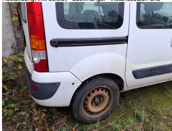
Beschädigung #20: Seitenwand rechts: Seitenwand (Mit Rostbildung) - Lackmangel - instandsetzen und lackieren
