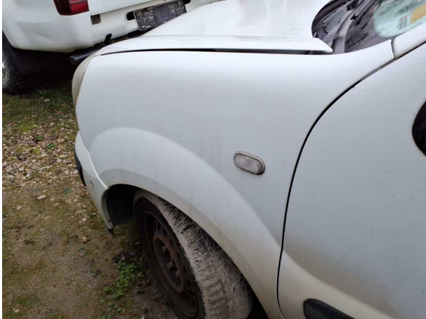
Beschädigung #8: Blinkleuchte: Blinkleuchte seitlich (Links) - undicht - erneuern
