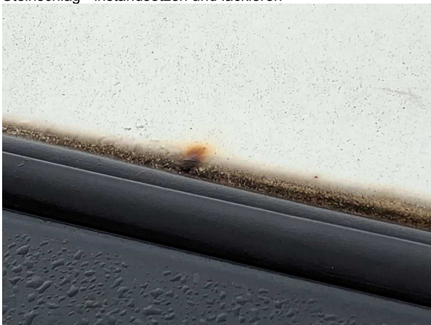
Beschädigung #10: Fahrzeugdach: Dach (Mit Rostbildung) - Steinschlag - instandsetzen und lackieren
