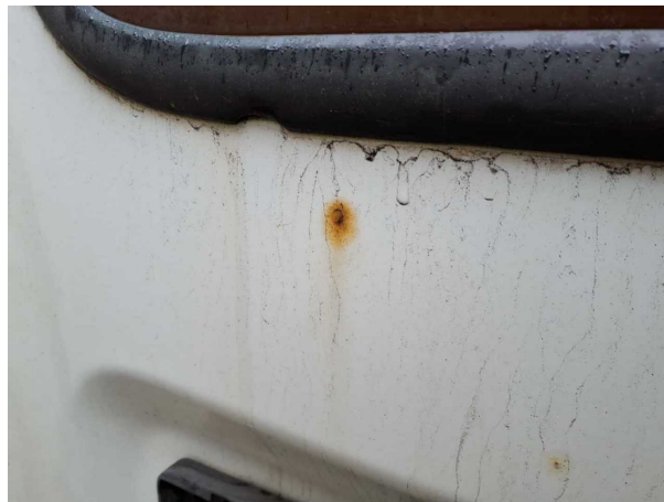
Beschädigung #19: Heckklappe/-tür: Hecktür links (Mit Rostbildung, inkl Leiste) - Lackmangel - instandsetzen und
