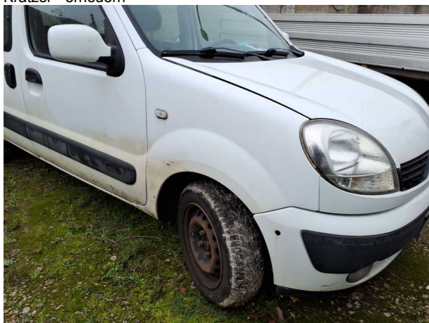
Beschädigung #13: Kotflügel rechts: Kotflügel rechts (Mit Rostbildung) - Delle / Lackschaden - instandsetzen und lackieren
