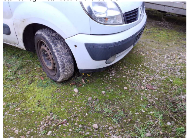
Beschädigung #11: Stossfänger vorn: Stossfänger vorn - Kratzer - lackieren
