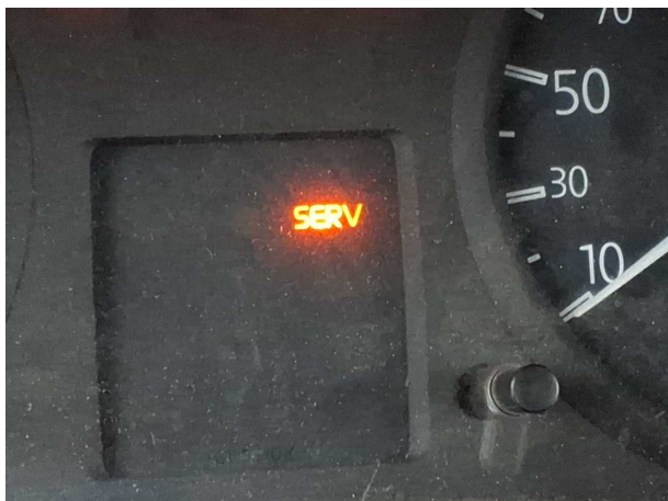
Beschädigung #1: Sonstiges: Inspektion/Wartung - fällig - durchführen
