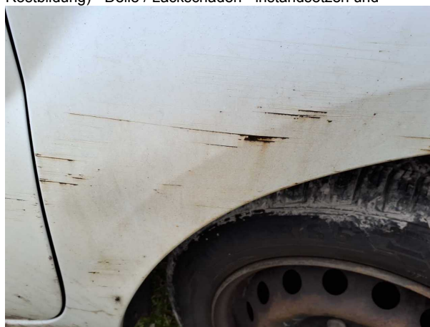
Beschädigung #13: Kotflügel rechts: Kotflügel rechts (Mit Rostbildung) - Delle / Lackschaden - instandsetzen und
