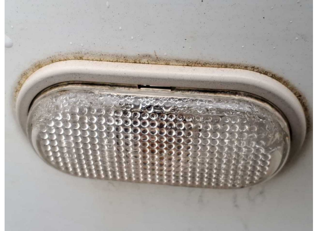
Beschädigung #8: Blinkleuchte: Blinkleuchte seitlich (Links) - undicht - erneuern
