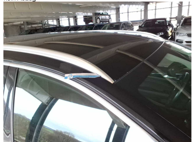
Beschädigung #10: Fahrzeugdach: Dachreling rechts - Krat... - Wertminderung
