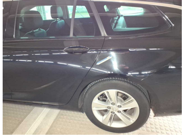
Beschädigung #14: Seitenwand links: Seitenwand - Kratzer - Smart Repair
