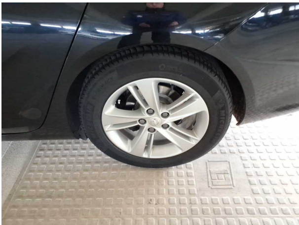
Beschädigung #6: Rad/Reifen: Leichtmetallfelge hinten links - Kratzer - Smart Repair
