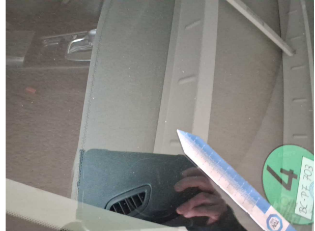
Beschädigung #9: Verglasung: Frontscheibe - Steinschlag - kein Abzug
