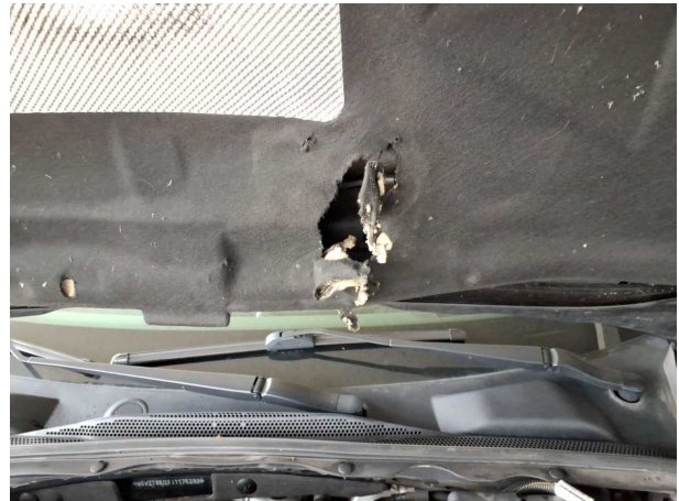
Beschädigung #1: Motorhaube: Dämmmatte - Marderschaden - erneuern
