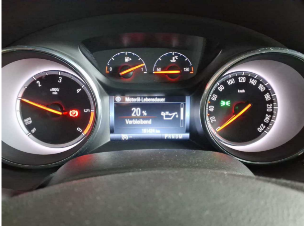
Beschädigung #4: Sonstiges: Inspektion/Wartung (In Kürze) - fällig
