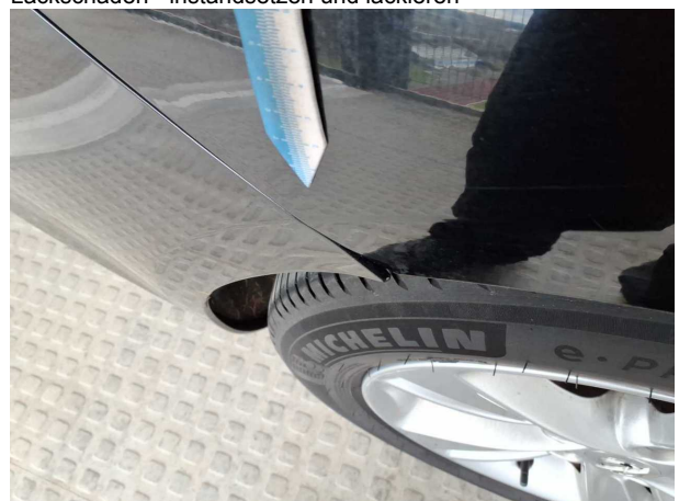
Beschädigung #13: Stossfänger hinten: Stossfänger hinten - Fehlstellung - instandsetzen
