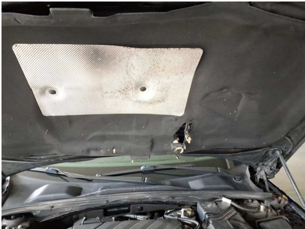
Beschädigung #1: Motorhaube: Dämmmatte - Marderschaden - erneuern
