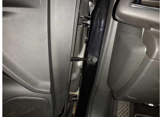
Beschädigung #5: Tür vorn links: Fangband / Feststeller - Geräusch - instandsetzen
