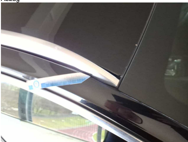
Beschädigung #10: Fahrzeugdach: Dachreling rechts - Kratzer - Wertminderung
