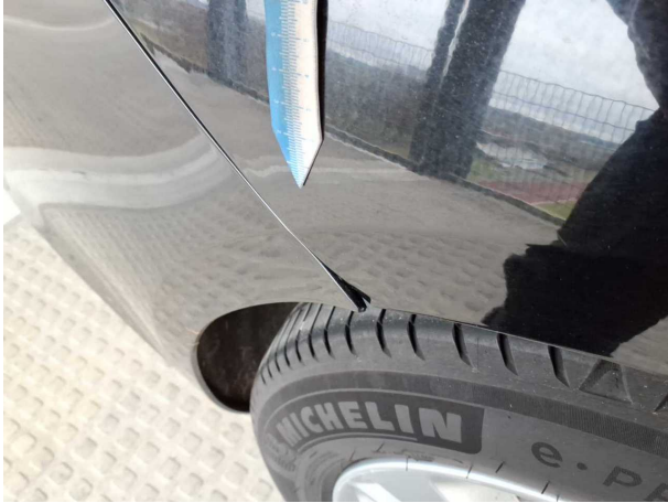
Beschädigung #13: Stossfänger hinten: Stossfänger hinten - Fehlstellung - instandsetzen
