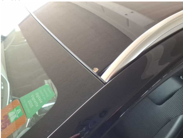
Beschädigung #2: Fahrzeugdach: Dach (Dachkante vorne) - Steinschlag - Smart Repair
