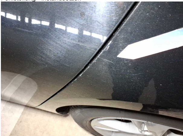
Beschädigung #14: Seitenwand links: Seitenwand - Kratzer - Smart Repair
