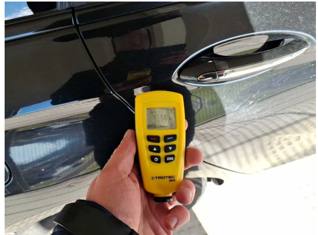
Nachlackierung 1: Seitenwand rechts
