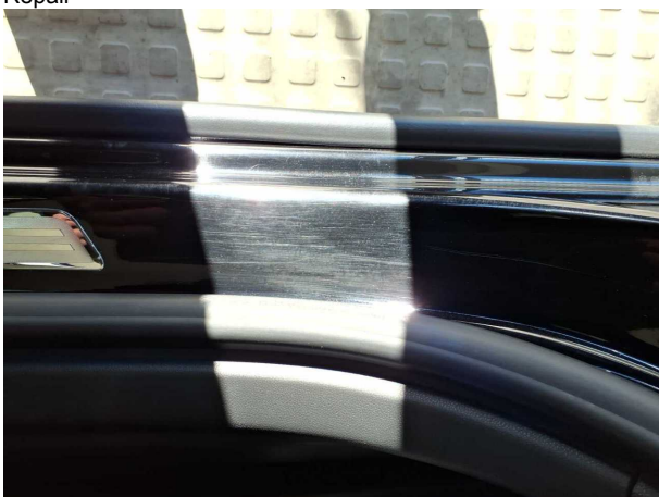
Beschädigung #9: Schweller rechts: Einstieg - Kratzer - Smart Repair
