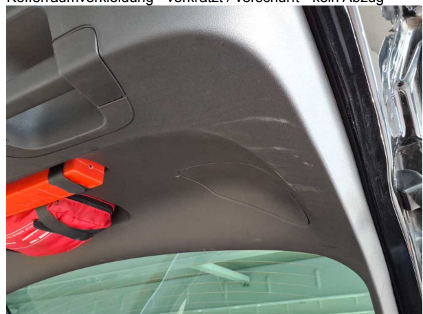
Beschädigung #1: Verkleidungen/Abdeckungen: Kofferraumverkleidung - verkratzt / verschürft - kein Abzug
