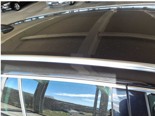
Beschädigung #17: Karosserie: Karosserie - Hagelschaden - sa... instandsetzen
