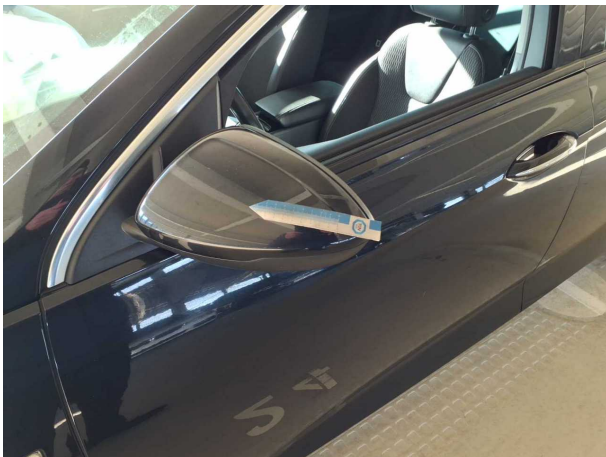
Beschädigung #12: Außenspiegel links: Abdeckkappe - verkratzt / verschürft - instandsetzen und lackieren
