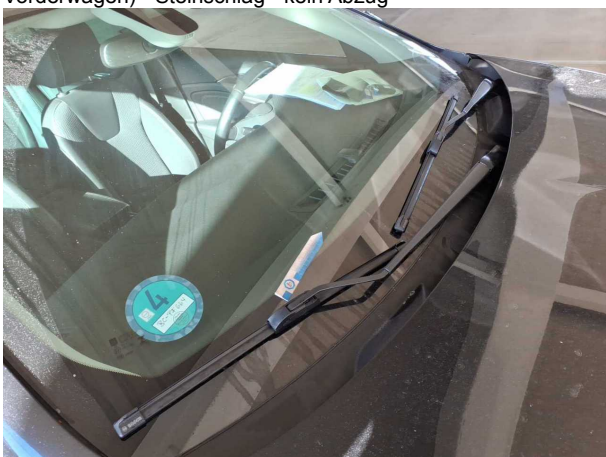
Beschädigung #7: Verglasung: Frontscheibe - gebrochen / gerissen - erneuern
