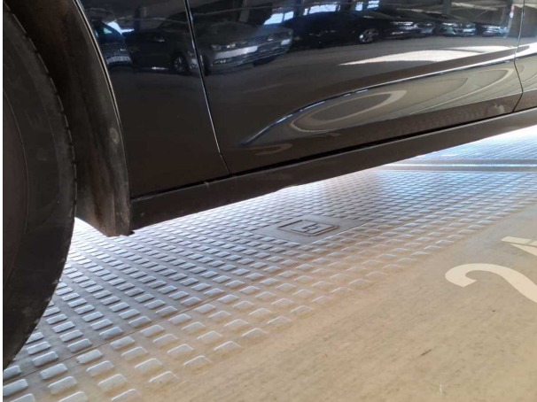
Beschädigung #3: Schweller links: Schweller - verformt - instandsetzen und lackieren
