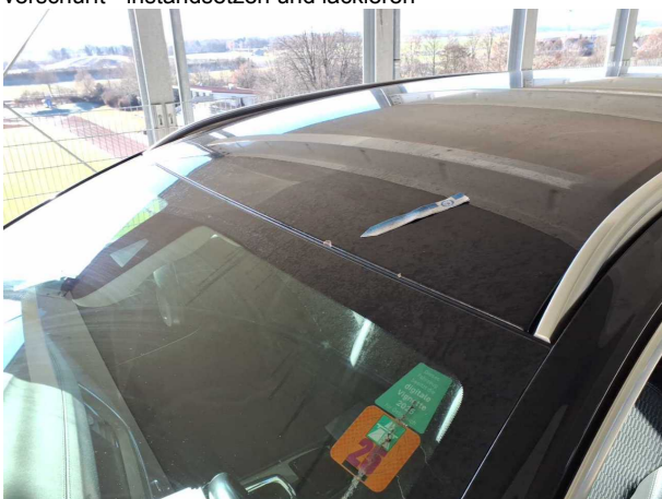
Beschädigung #13: Fahrzeugdach: Dach - Korrosion - Smart Repair
