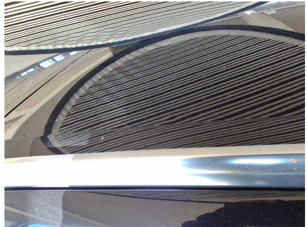
Beschädigung #17: Karosserie: Karosserie - Hagelschaden - sanft instandsetzen
