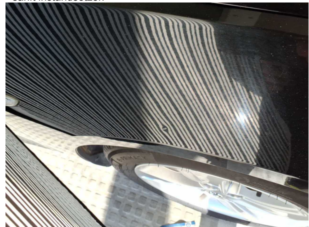
Beschädigung #16: Kotflügel rechts: Kotflügel rechts - Delle / Lackschaden - instandsetzen und lackieren
