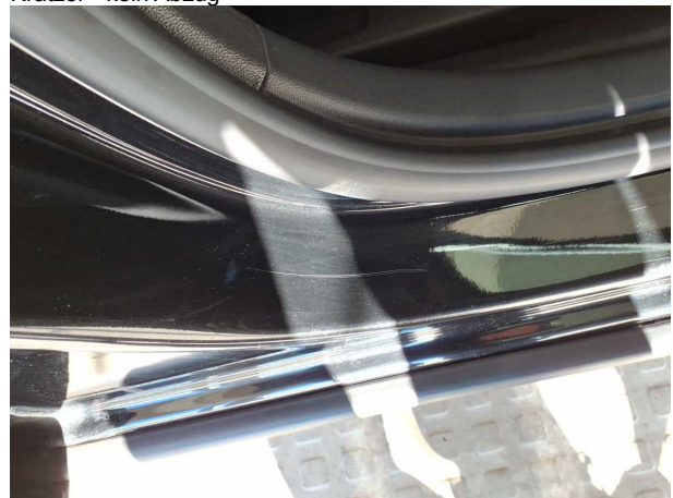
Beschädigung #9: Schweller rechts: Einstieg - Kratzer - Smart Repair
