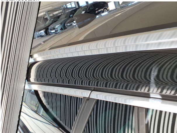
Beschädigung #17: Karosserie: Karosserie - Hagelschaden - sa... instandsetzen
