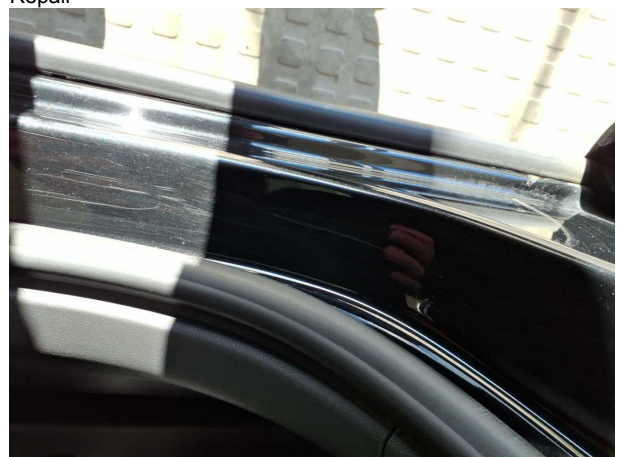
Beschädigung #9: Schweller rechts: Einstieg - Kratzer - Smart Repair
