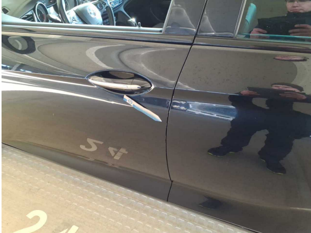
Beschädigung #11: Tür vorn links: Türkante - Kratzer - kein Abzug
