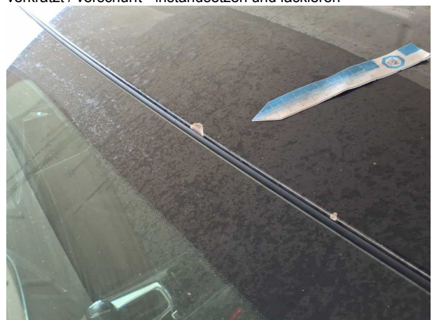
Beschädigung #13: Fahrzeugdach: Dach - Korrosion - Smart Repair
