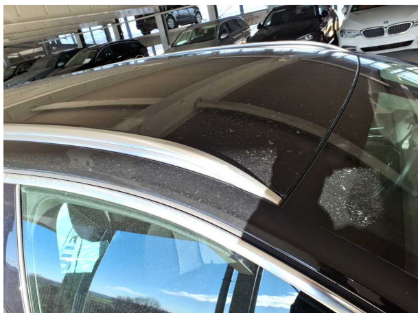
Beschädigung #19: Fahrzeugdach: Dachreling rechts - Kratzer - Wertminderung
