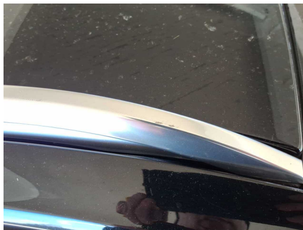
Beschädigung #19: Fahrzeugdach: Dachreling rechts - Krat... - Wertminderung
