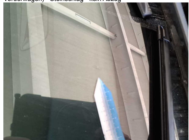
Beschädigung #7: Verglasung: Frontscheibe - gebrochen / gerissen - erneuern
