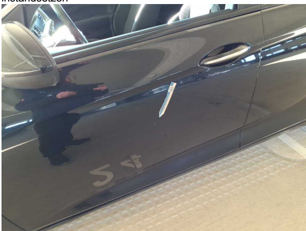
Beschädigung #18: Tür vorn links: Tür - verkratzt / verschürft - instandsetzen und lackieren
