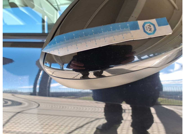
Beschädigung #8: Außenspiegel rechts: Abdeckkappe - Kratzer - kein Abzug
