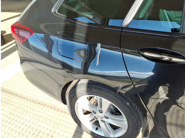
Beschädigung #15: Seitenwand rechts: Seitenwand - Delle(n) - sanft instandsetzen
