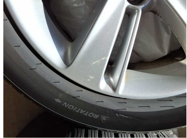
Beschädigung #5: 2.Radsatz: 1 Leichtmetallfelge - verkratzt / verschürft - Smart Repair
