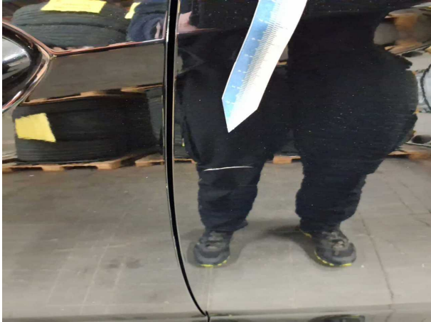
Beschädigung #13: Tür hinten links: Tür - Kratzer - instandsetzen und lackieren
