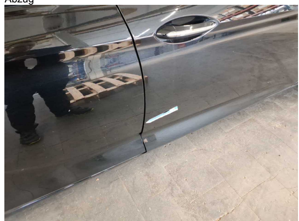
Beschädigung #10: Tür vorn rechts: Türkante - Kratzer - kein Abzug
