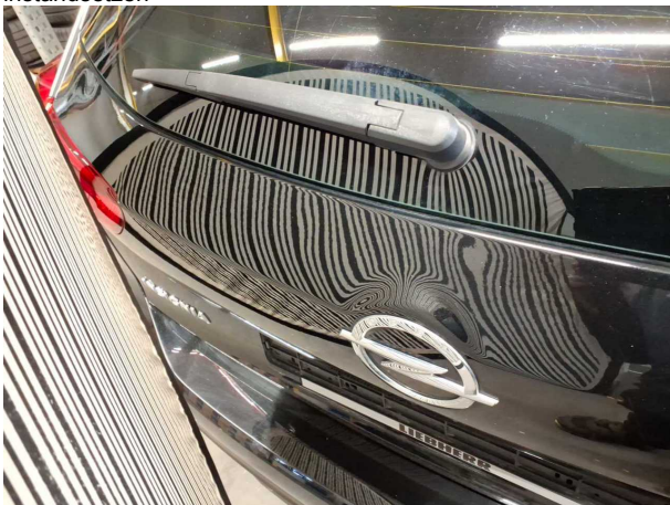
Beschädigung #20: Heckklappe/-tür: Heckklappe - Delle(n) - sanft instandsetzen
