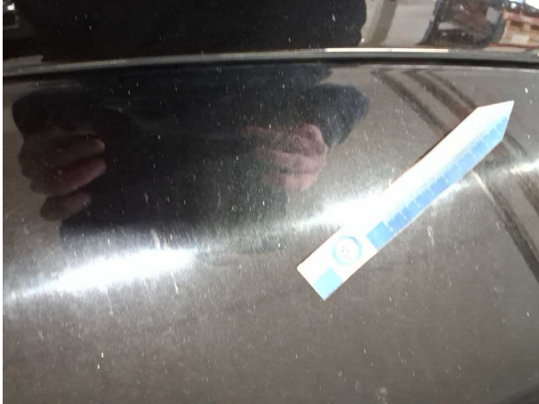
Beschädigung #6: Motorhaube: Motorhaube (Kompletter Vorderwagen) - Steinschlag
