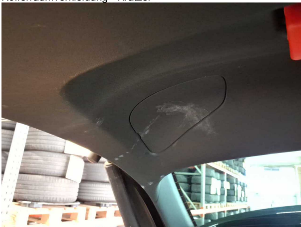
Beschädigung #4: Verkleidungen/Abdeckungen: Kofferraumverkleidung - Kratzer
