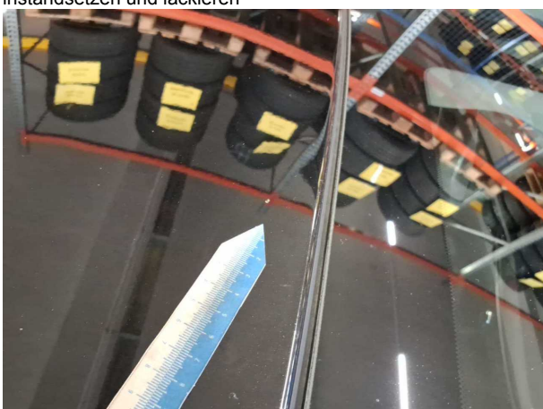
Beschädigung #9: Fahrzeugdach: Dach - Steinschlag - kein Abzug
