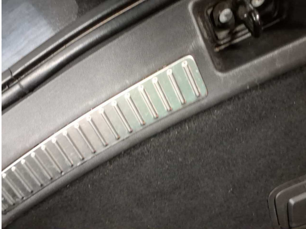
Beschädigung #4: Verkleidungen/Abdeckungen: Kofferraumverkleidung - Kratzer
