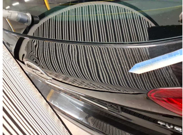
Beschädigung #20: Heckklappe/-tür: Heckklappe - Delle(n) - sanft instandsetzen
