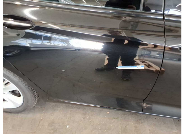
Beschädigung #11: Tür hinten rechts: Tür - Kratzer - instandsetzen und lackieren
