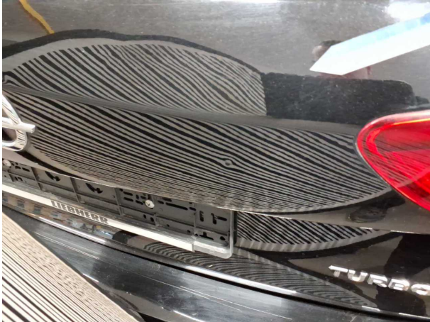
Beschädigung #20: Heckklappe/-tür: Heckklappe - Delle(n) - sanft instandsetzen
