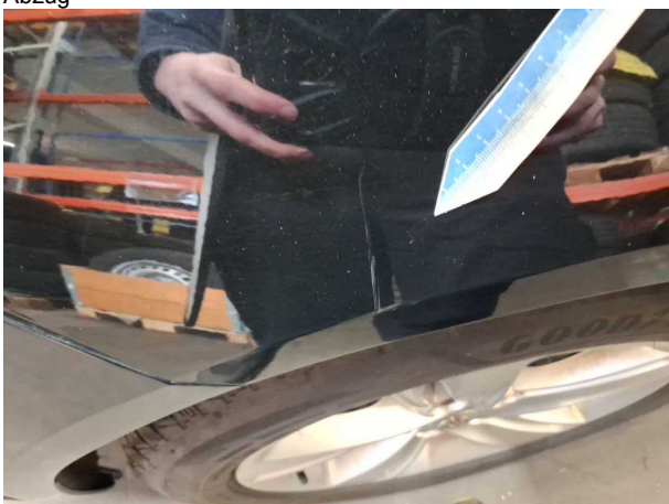
Beschädigung #19: Kotflügel links: Kotflügel links - Kratzer - instandsetzen und lackieren
