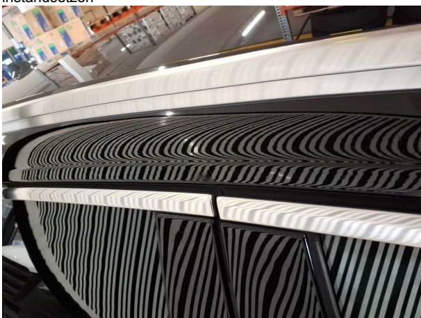
Beschädigung #21: Fahrzeugdach: Dachholm rechts (Lackeinschluss) - Lackmangel - auslegen / polieren
