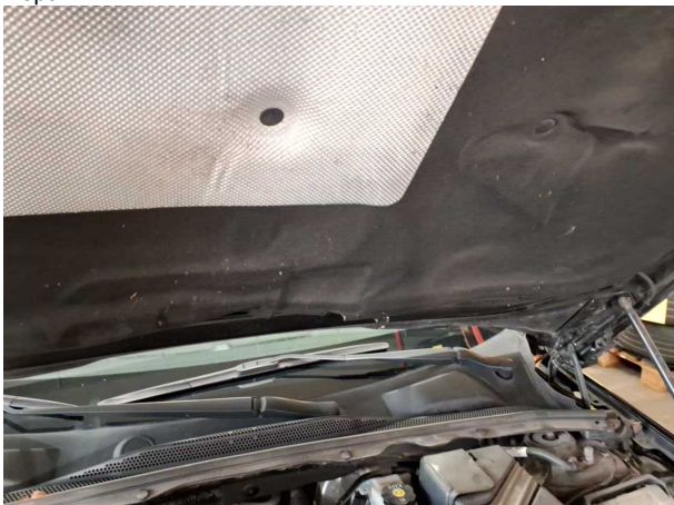
Beschädigung #3: Motorhaube: Dämmmatte - Marderschaden - erneuern
