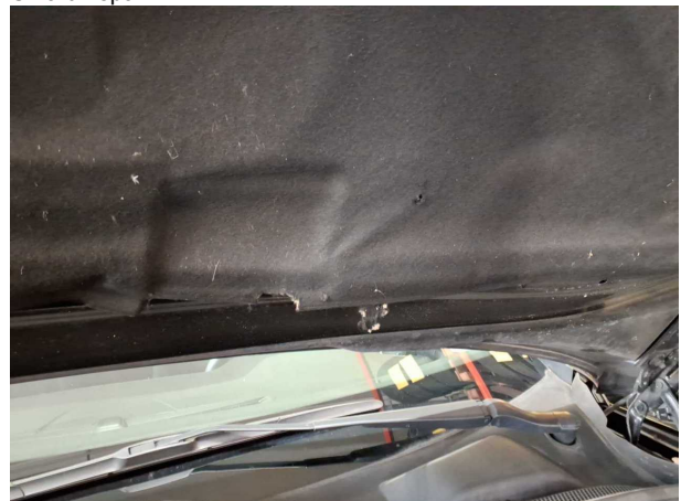
Beschädigung #3: Motorhaube: Dämmmatte - Marderschaden - erneuern
