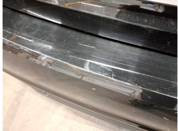
Beschädigung #12: Stossfänger hinten: Stossfänger hinten - gebrochen / gerissen - erneuern
