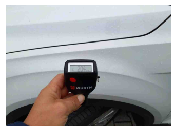
Lackstärke Kotflügel vorne links
