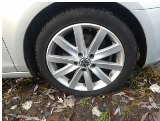
Bild 29: Reifen - Felge / Felge vorne rechts Bordsteinschaden
