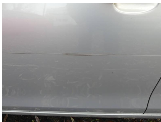
Bild 18: Karosserie / Tür vorne links deformiert und zerkratzt
