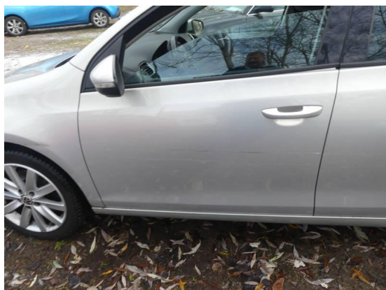
Bild 19: Karosserie / Tür vorne links deformiert und zerkratzt
