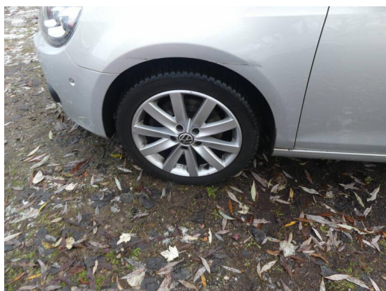
Bild 27: Reifen - Felge / Felge vorne links Bordsteinschaden
