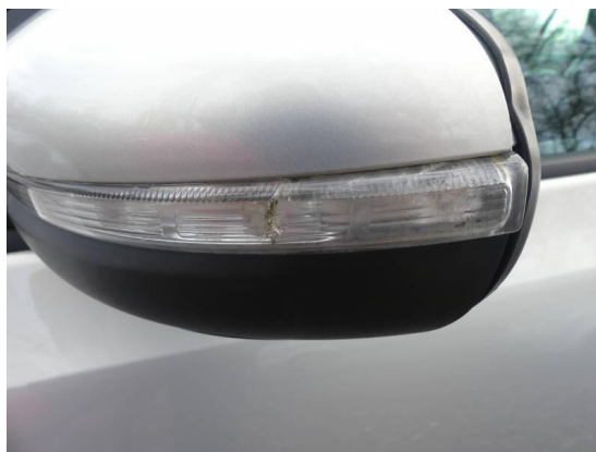
Bild 14: Technik / Spiegel blinker links gebrochen und ohne Funktion
