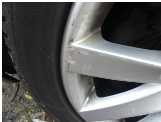
Bild 26: Reifen - Felge / Felge vorne links Bordsteinschaden
