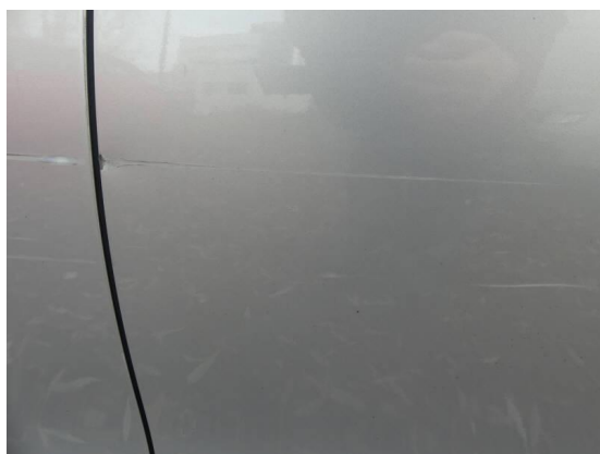
Bild 21: Karosserie / Tür hinten links deformiert und zerkratzt
