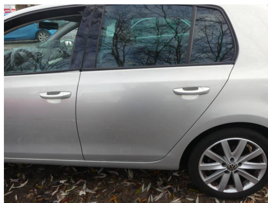
Bild 22: Karosserie / Tür hinten links deformiert und zerkratzt
