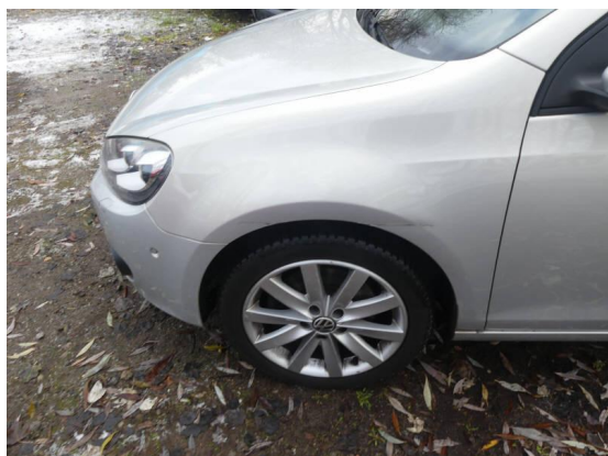
Bild 13: Karosserie / Kotflügel links deformiert und zerkratzt
