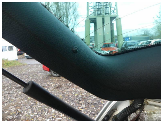
Bild 8: Innenraum / Hacken für Kofferraumabdeckung links abgebrochen
