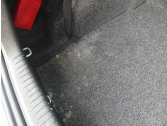
Bild 1: Innenraum / Kofferraumteppich Schimmel
