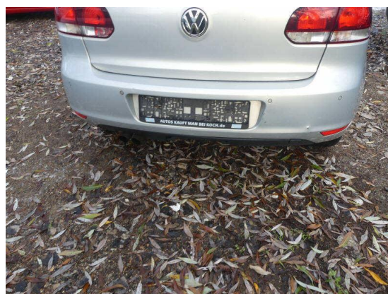
Bild 24: Karosserie / Stoßfänger hinten deformiert und zerkratzt
