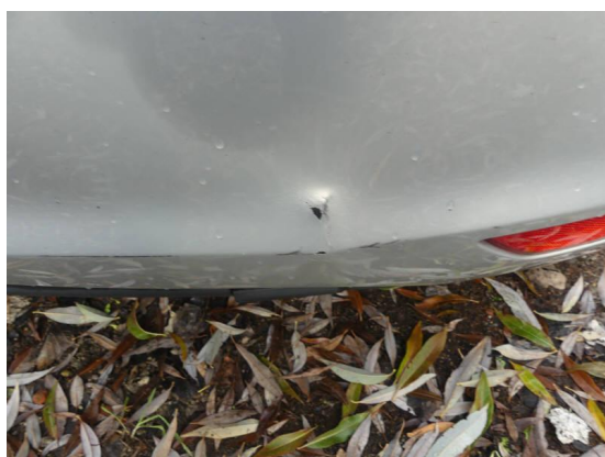
Bild 23: Karosserie / Stoßfänger hinten deformiert und zerkratzt
