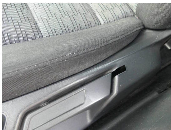
Bild 12: Innenraum / Fahrersitzbezug und Polster verschlissen
