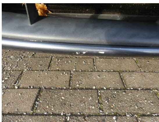
Bild 10: Karosserie / Stoßfänger vorn Kratzer
