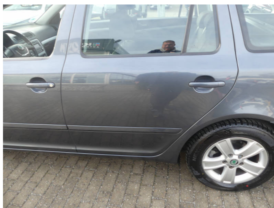
Bild 22: Karosserie / Tür hinten links Dellen und zerkratzt
