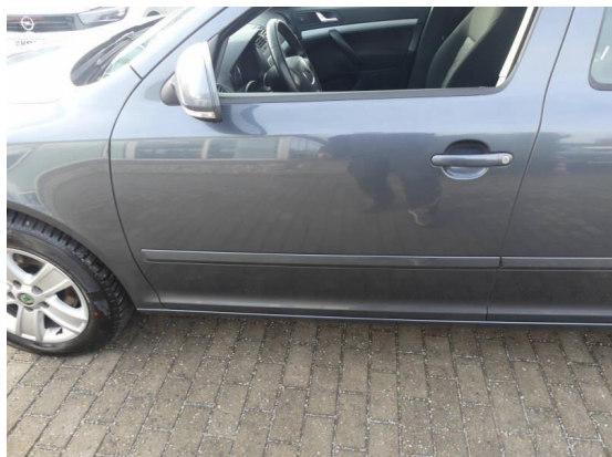
Bild 19: Karosserie / Tür vorne links Dellen und zerkratzt
