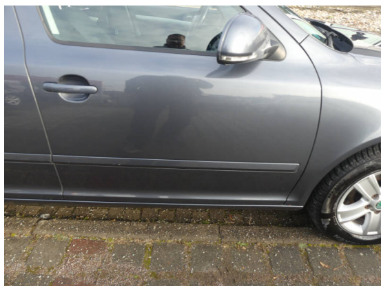
Bild 7: Karosserie / Tür vorne rechts Kratzer
