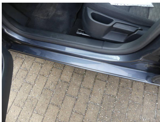
Bild 16: Karosserie / Einstieg vorne links Delle
