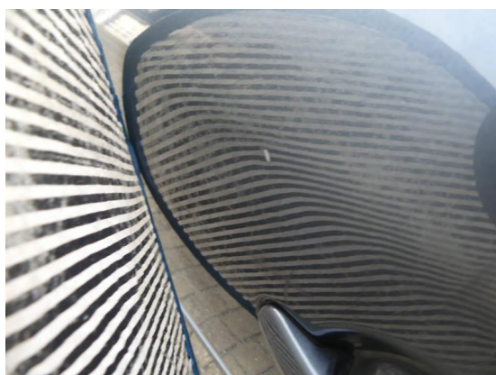
Bild 17: Karosserie / Tür vorne links Dellen und zerkratzt
