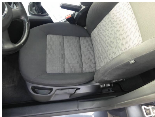
Bild 14: Innenraum / Fahrersitzbezug und Polster verschlissen
