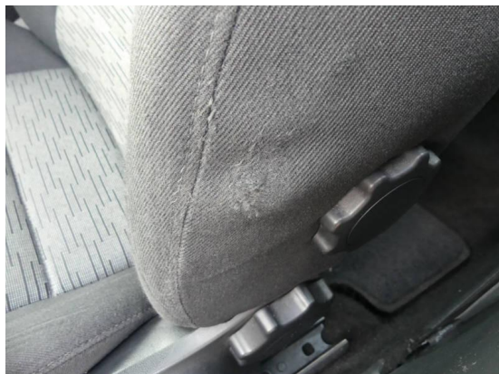
Bild 13: Innenraum / Fahrersitzbezug und Polster verschlissen
