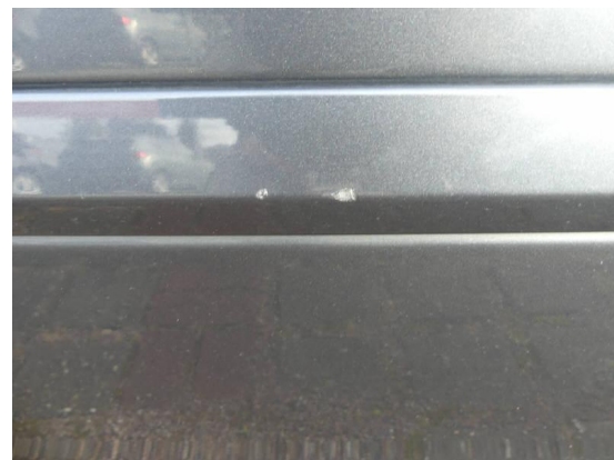
Bild 6: Karosserie / Tür vorne rechts Kratzer
