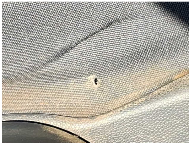
Beschädigung #17: Sitz vorn: Sitzbezug links - gebrochen / gerissen - erneuern
