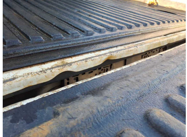
Beschädigung #11: Heckbereich: Kofferboden - Delle / Lackschaden - instandsetzen und lackieren
