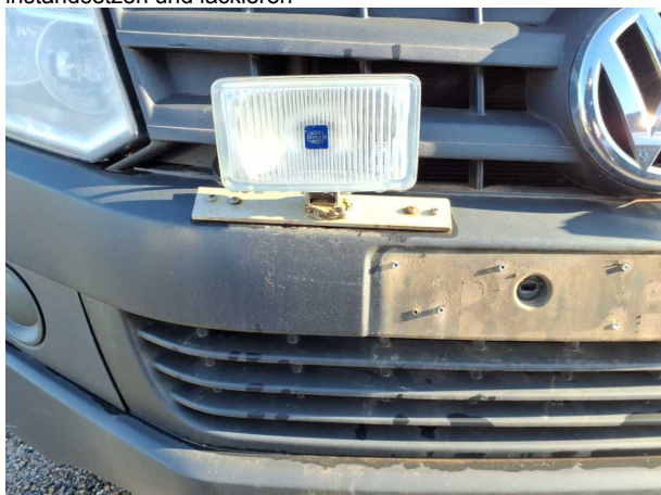
Beschädigung #4: Stossfänger vorn: Stossfänger vorn (unlackiert) - beschädigt - erneuern
