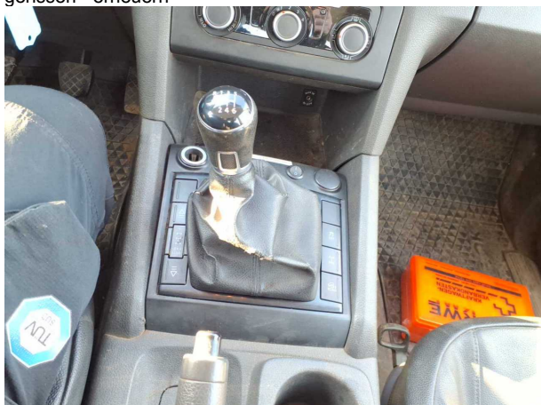
Beschädigung #18: Getriebe: Schaltmanschette - beschädigt - erneuern
