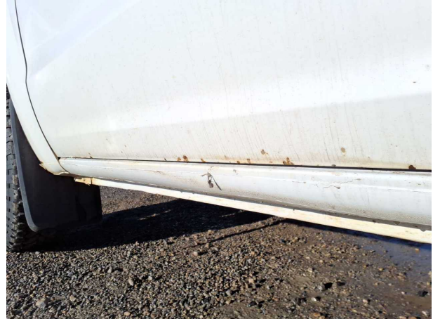
Beschädigung #15: Tür vorn links: Tür - Lackmangel - instandsetzen und lackieren
