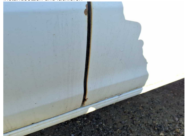
Beschädigung #14: Tür hinten links: Tür - Lackmangel - instandsetzen und lackieren
