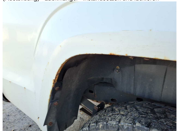
Beschädigung #9: Seitenwand rechts: Seitenwand (Rostbildung) - Lackmangel - instandsetzen und lackieren
