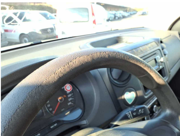
Beschädigung #16: Lenkanlage: Lenkrad - beschädigt - erneuern
