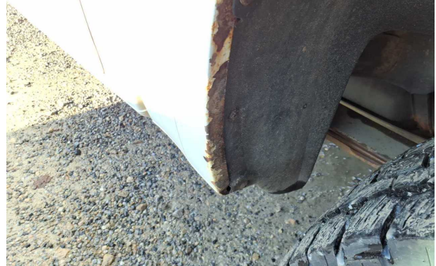
Beschädigung #12: Seitenwand links: Seitenwand - Delle / Lackschaden - instandsetzen und lackieren
