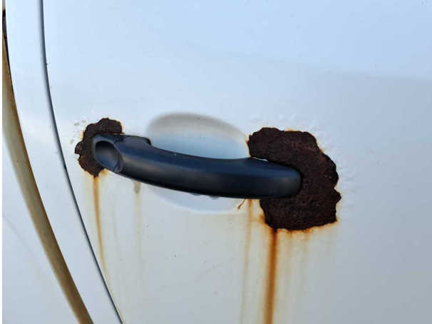
Beschädigung #8: Tür hinten rechts: Tür (Rostbildung) - Lackmangel - erneuern
