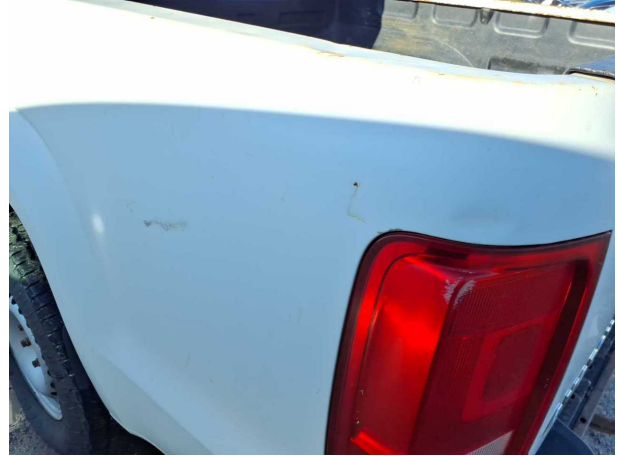
Beschädigung #12: Seitenwand links: Seitenwand - Delle / Lackschaden - instandsetzen und lackieren
