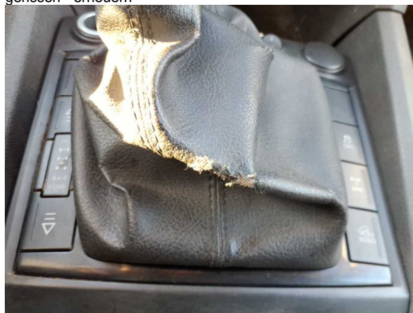
Beschädigung #18: Getriebe: Schaltmanschette - beschädigt - erneuern
