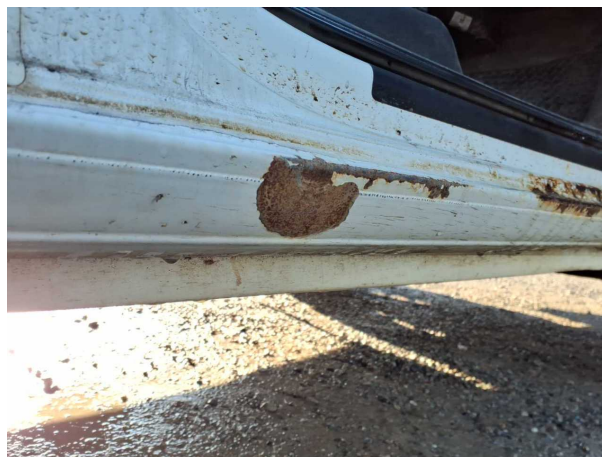
Beschädigung #6: Schweller rechts: Schweller - Delle / Lackschaden - instandsetzen und lackieren
