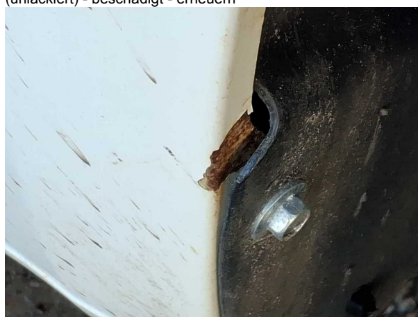
Beschädigung #5: Kotflügel rechts: Kotflügel rechts - Lackmangel - instandsetzen und lackieren
