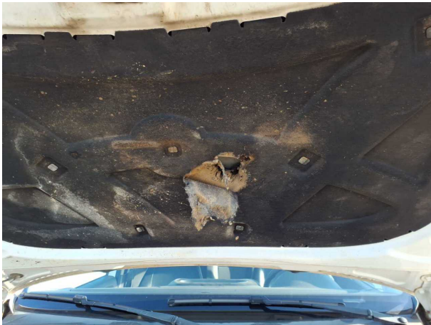
Beschädigung #1: Motorhaube: Dämmmatte - beschädigt - erneuern
