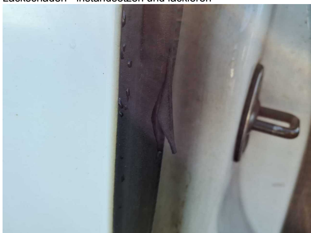
Beschädigung #7: Tür hinten rechts: Türdichtung - gebrochen / gerissen - erneuern
