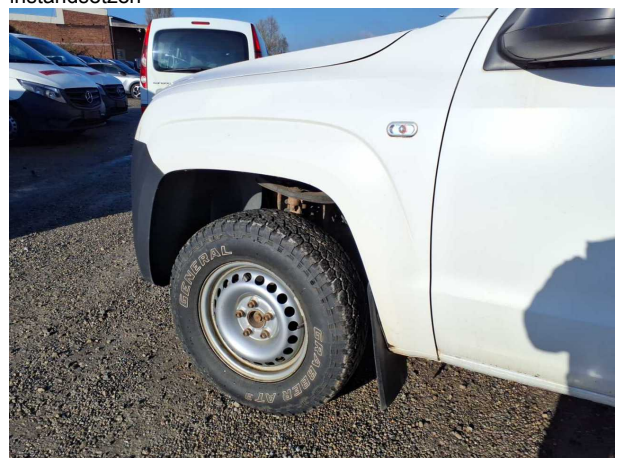
Beschädigung #3: Kotflügel links: Kotflügel links - Lackmangel - instandsetzen und lackieren
