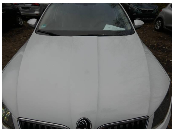
Bild 21: Karosserie / Motorhaube deformiert, Dellen
