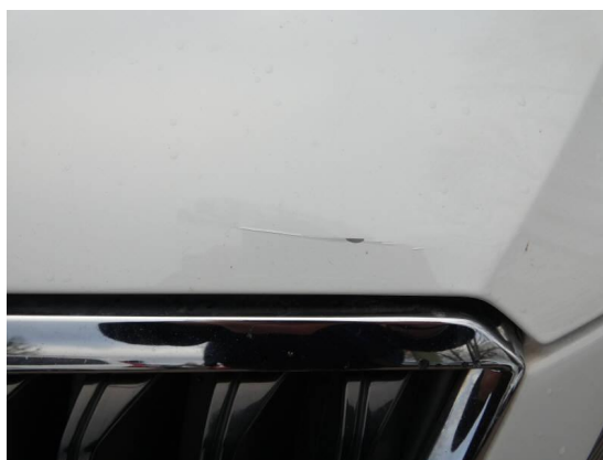
Bild 22: Karosserie / Motorhaube deformiert, Dellen
