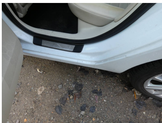
Bild 12: Karosserie / Einstieg Fond links Kratzer
