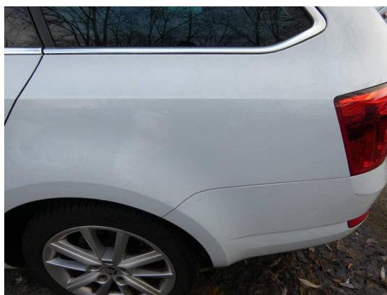
Bild 10: Karosserie / Fondteil links Kratzer
