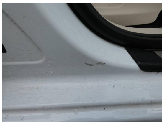
Bild 36: Karosserie / Einstieg Beifahrer Kratzer
