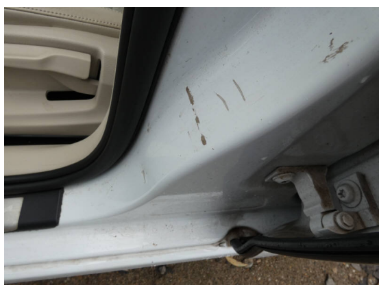
Bild 17: Karosserie / Einstieg Fahrer Dellen + Kratzer
