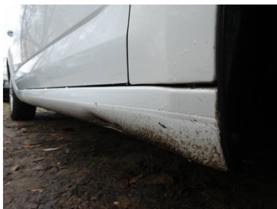
Bild 27: Karosserie / Schweller Beifahrerseite deformiert + zerkratzt
