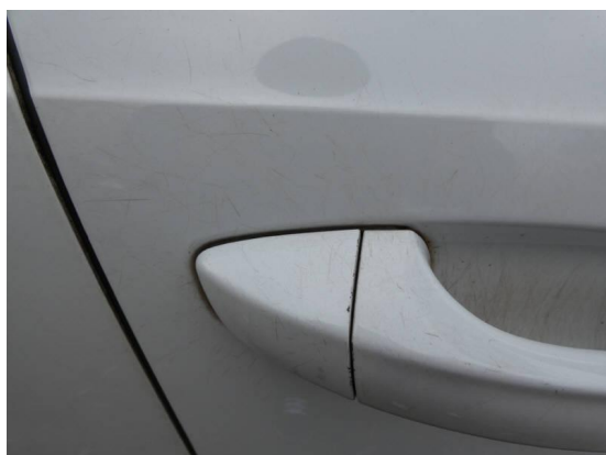
Bild 33: Karosserie / Beifahrertür zerkratzt
