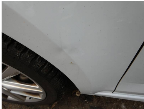
Bild 2: Karosserie / Kotflügel links deformiert
