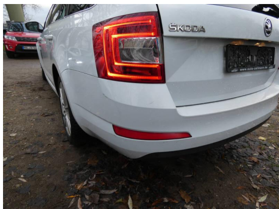
Bild 7: Karosserie / Stoßfänger hinten zerkratzt
