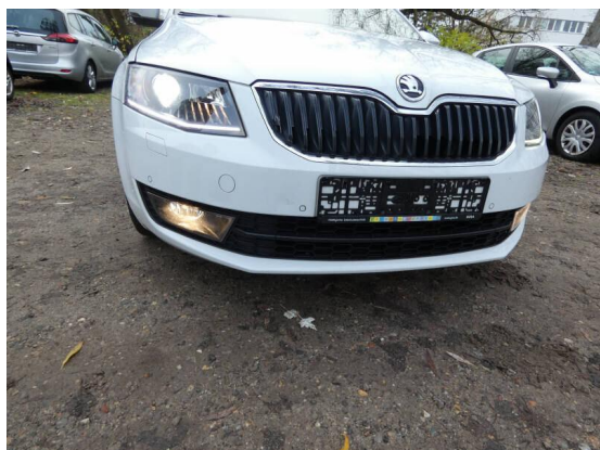
Bild 25: Karosserie / Stoßfänger vorne deformiert
