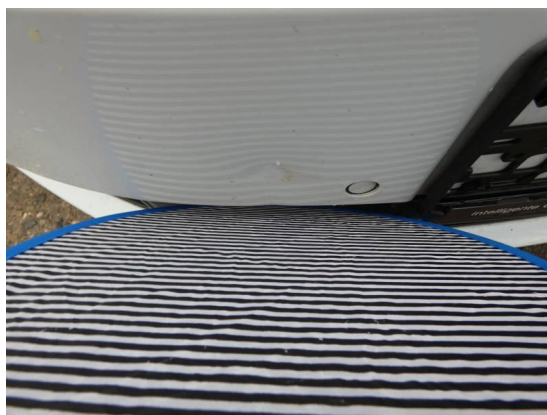
Bild 26: Karosserie / Stoßfänger vorne deformiert
