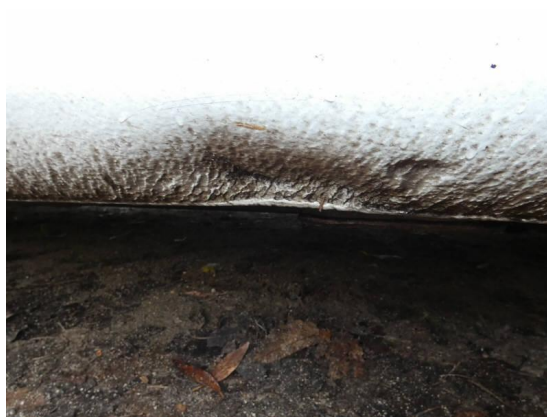
Bild 28: Karosserie / Schweller Beifahrerseite deformiert + zerkratzt
