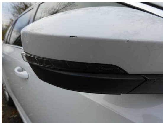
Bild 31: Karosserie / Spiegelgehäuse Beifahrerseite Kratzer
