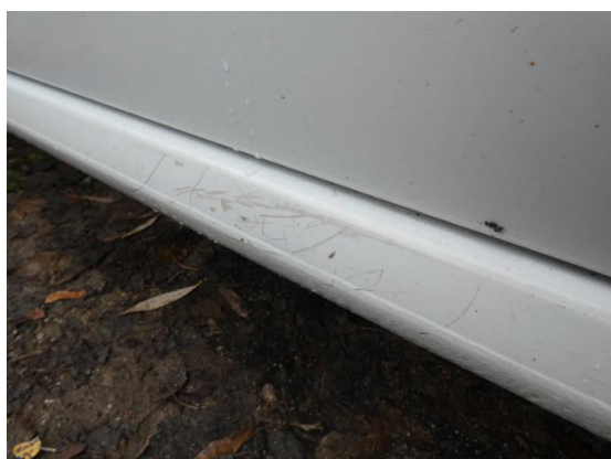
Bild 29: Karosserie / Schweller Beifahrerseite deformiert + zerkratzt
