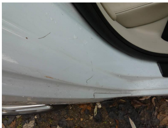
Bild 38: Karosserie / Einstieg Fond Kratzer
