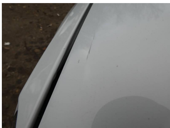
Bild 23: Karosserie / Motorhaube deformiert, Dellen
