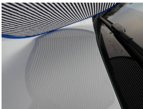
Bild 24: Karosserie / Motorhaube deformiert, Dellen
