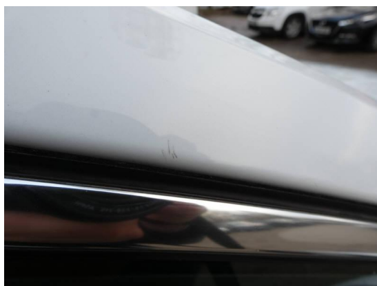
Bild 4: Karosserie / Dachreling zerkratzt
