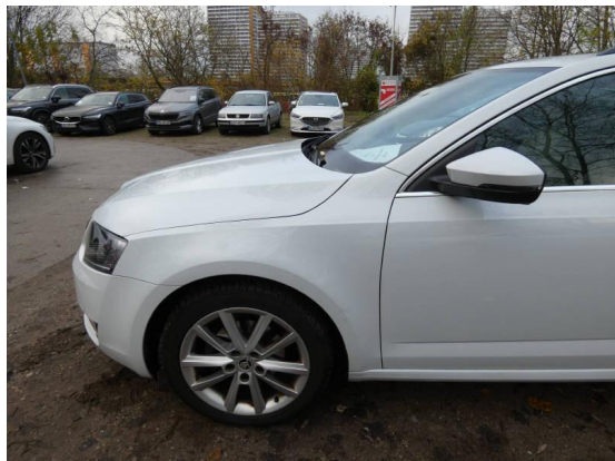
Bild 1: Karosserie / Kotflügel links deformiert
