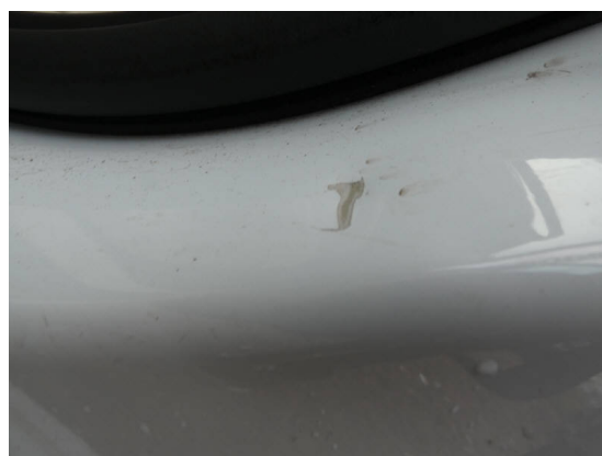
Bild 18: Karosserie / Einstieg Fahrer Dellen + Kratzer
