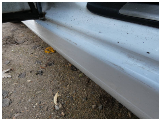
Bild 13: Karosserie / Einstieg Fond links Kratzer
