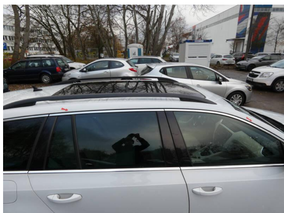
Bild 3: Karosserie / Dachreling zerkratzt
