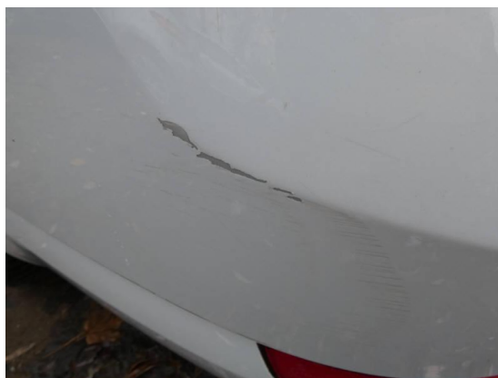
Bild 8: Karosserie / Stoßfänger hinten zerkratzt
