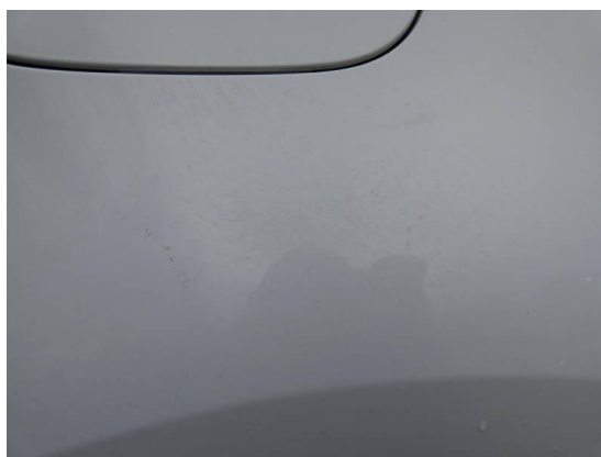
Bild 6: Karosserie / Fondseite rechts Kratzer
