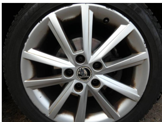
Bild 41: Reifen - Felge / Felgen rechts zerkratzt
