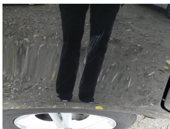
Bild 42: Karosserie / Fondteil rechts Kratzer
