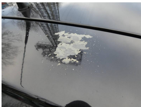
Bild 4: Karosserie / Heckklappe Lackablösungen
