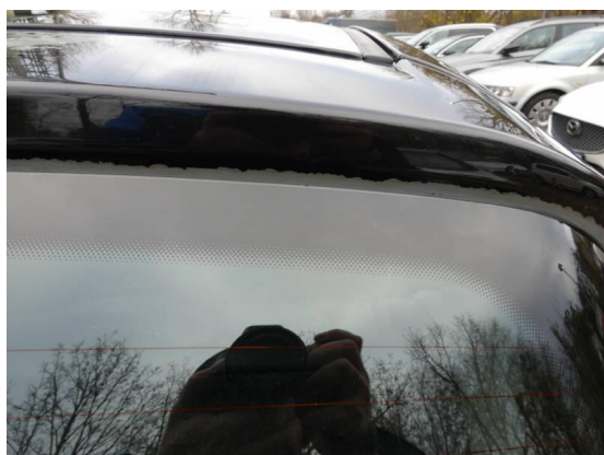
Bild 5: Karosserie / Heckklappe Lackablösungen
