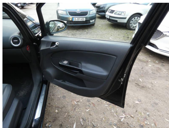
Bild 22: Innenraum / Türinnenverkleidung Beifahrerseite löst sich ab
