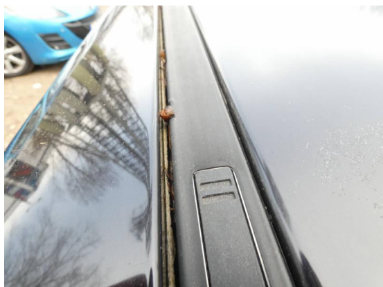
Bild 7: Karosserie / Dach Lackablösungen
