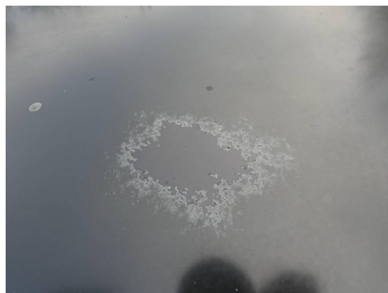
Bild 8: Karosserie / Dach Lackablösungen
