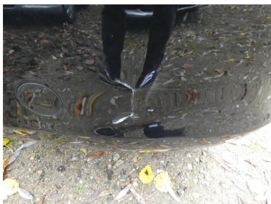
Bild 45: Karosserie / Stoßfänger hinten Kratzer + gebrochen
