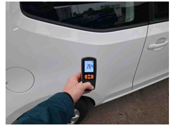
Lackstärke Seitenwand hinten rechts
