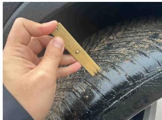
2 - Reifen vorne rechts - Außerhalb Toleranzbereich - Ersetzen
