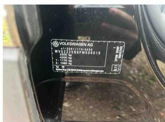
Fahrzeug - Typenschild/Fahrgestellnummer
